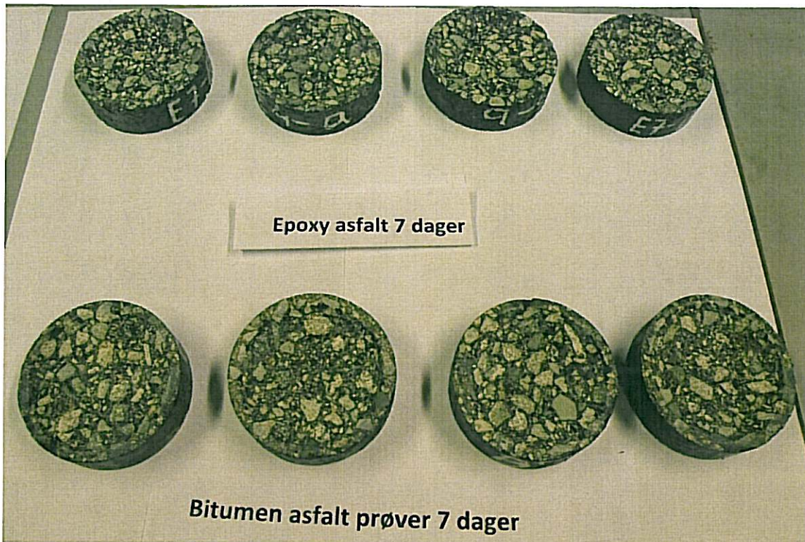
Figur A.3: Bindemiddel- og epoks prøver etter Prall-testing etter 7 dagers herding.
