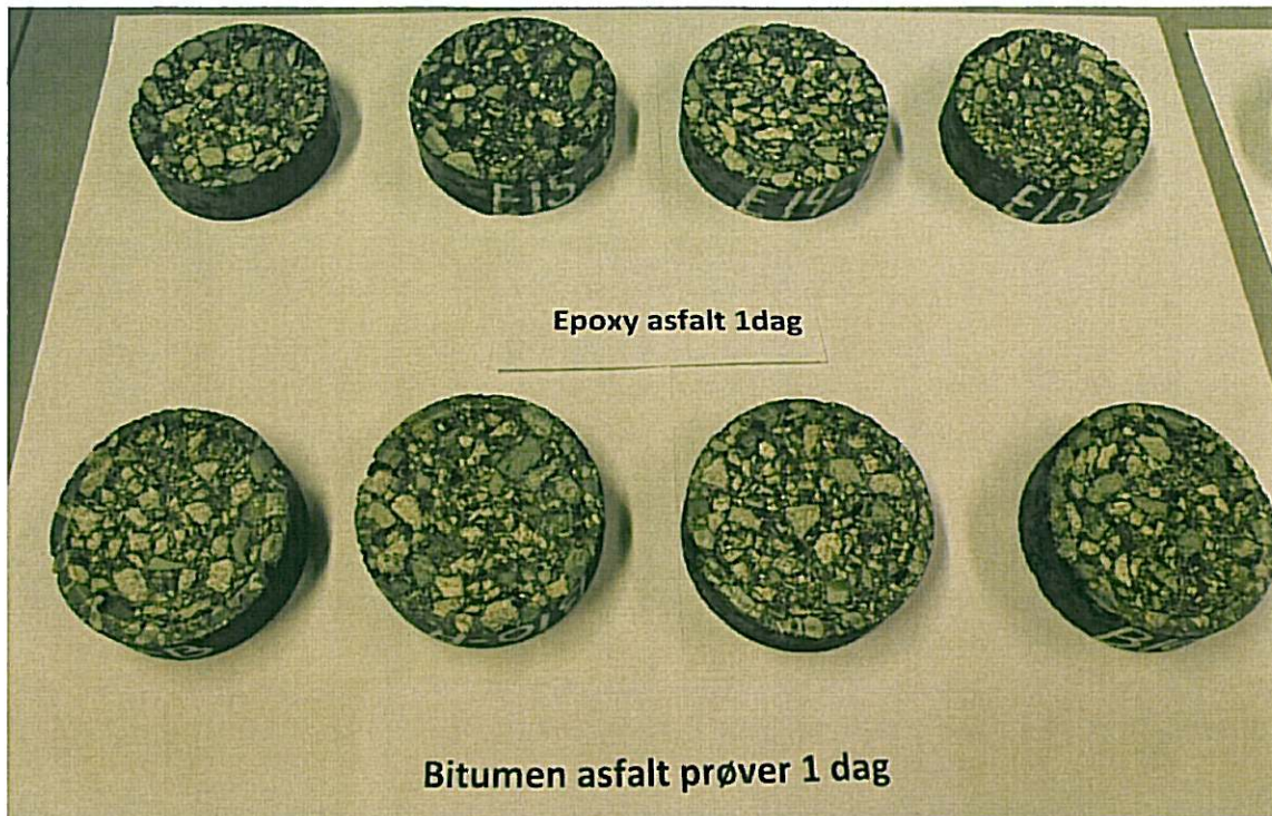
Figur A.1: Bindemiddel- og epoksyprøver etter Prall-testing etter 1 dags herding.
