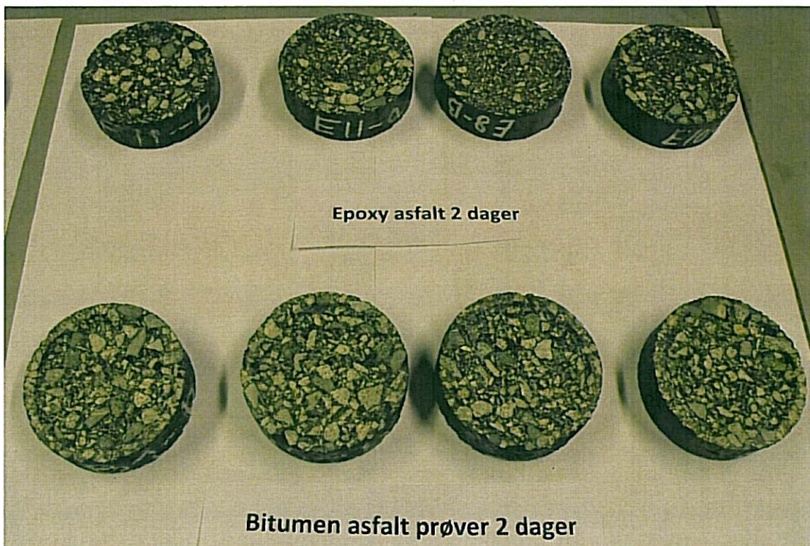
Figur A.2: Bindemiddel- og epoksyprøver etter Prall-testing etter 2 dagers herding.
