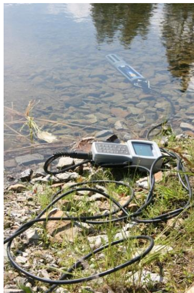
Figur 14. Multiparameter vannkvalitets-sonde (YSI 6600 V2-4) brukt i denne undersøkelsen.
