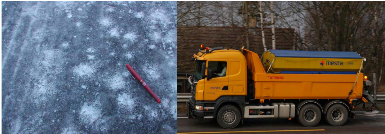
Figur 8-6 De-ising – Salting for å fjerne et is- eller snødekke (Foto t.v: Torgeir Vaa, t.h. Håkon Aurlien)
