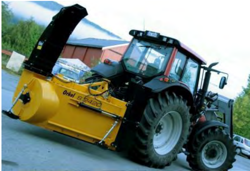
Figur 4-42 Bakmontert snøfres på traktor (Foto:Orkel AS)
