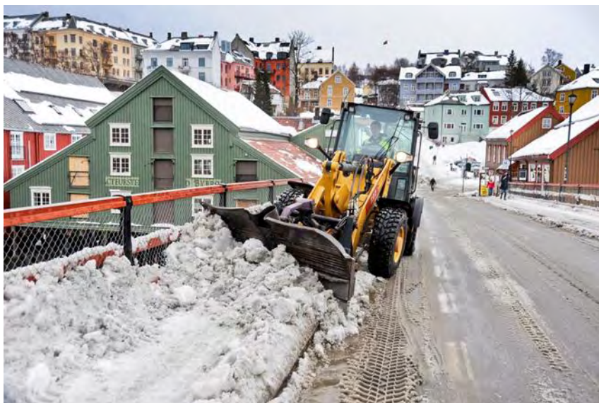
Figur 6-12 Eksempel på kjøretøy som er dårlig egnet til jobben som skal utføres (for tungt og bredt for brøyting på fortau). (Foto: Knut Opeide, Statens vegvesen. )
