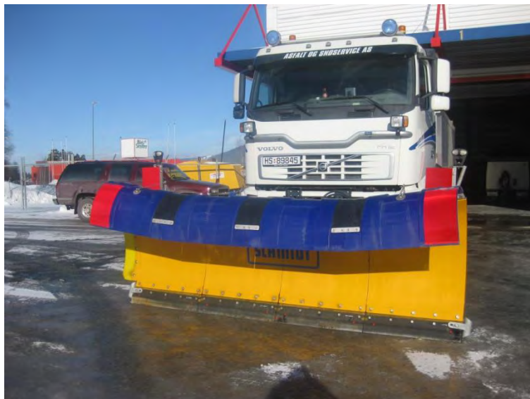
Figur 4-27 Seksjonsoppdelt plog (Foto: Schmidt Norge AS)
