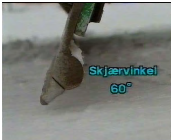
Figur 4-71 Riktig skjærvinkel med hardmetallstift (System 2000)
