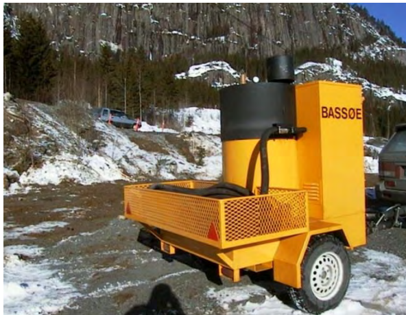
Figur 9-9 Bassøe tineutstyr med tilhengerunderstell (Foto: Glomsrød Mek. Verksted)
