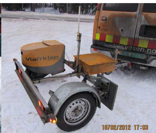
Figur 5-18 ViaFriction-friksjonsmåler, hengerversjon. (Foto: Dagfin Grytesselv)
