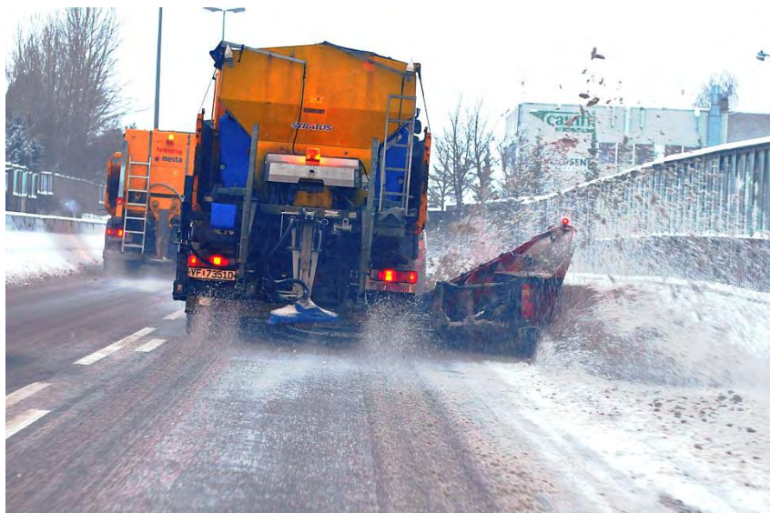
Figur 8-4 Anti-kompaktering – salting i forbindelse med snøvær (Foto: Knut Opeide, Statens vegvesen)
