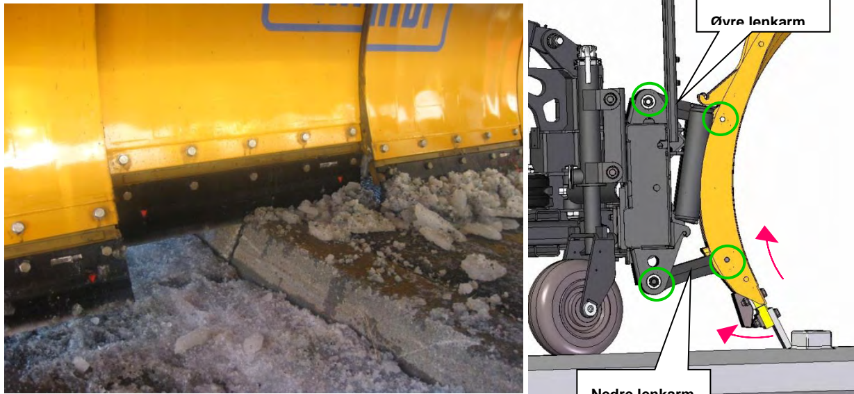
Figur 4-28 Bevegelige plogseksjoner på fortauskant (Kilde: Schmidt Norge AS)
