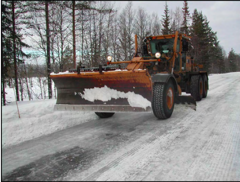
Figur 4-66 Veghøvel i arbeid
