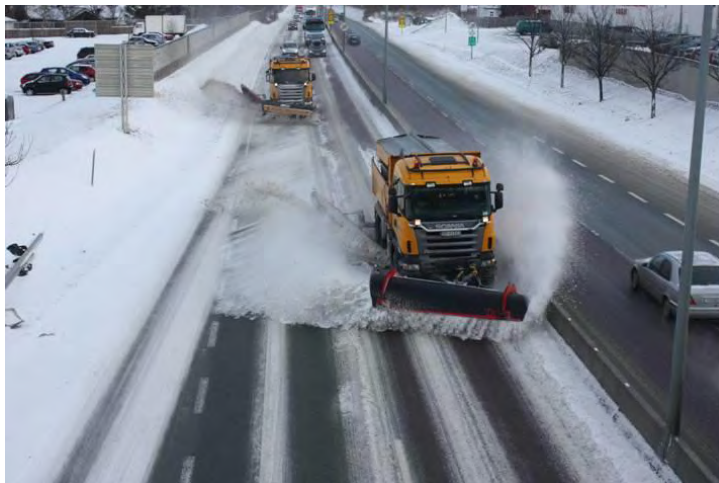
Figur 4-50 Eksempel på tandemkjøring (vær obs på snøsprut på motgående trafikk) (Foto: Statens vegvesen)
