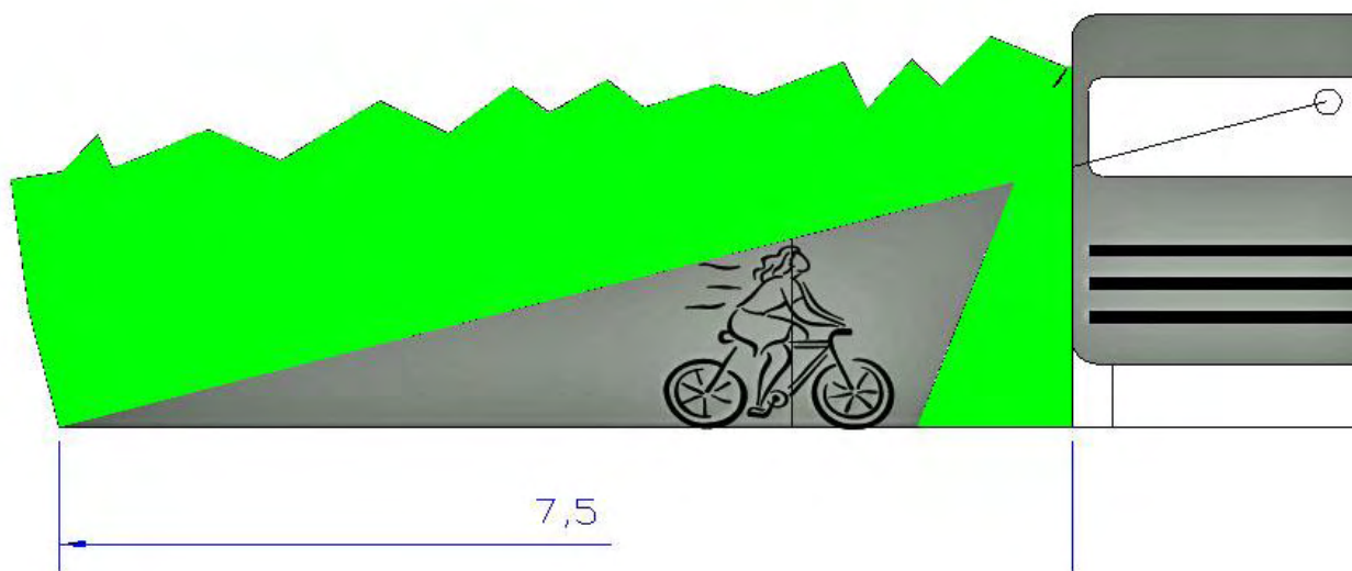
Figur 2-66 Blindsoner på høyre side av lastebil. Se grå sone på skissen over
