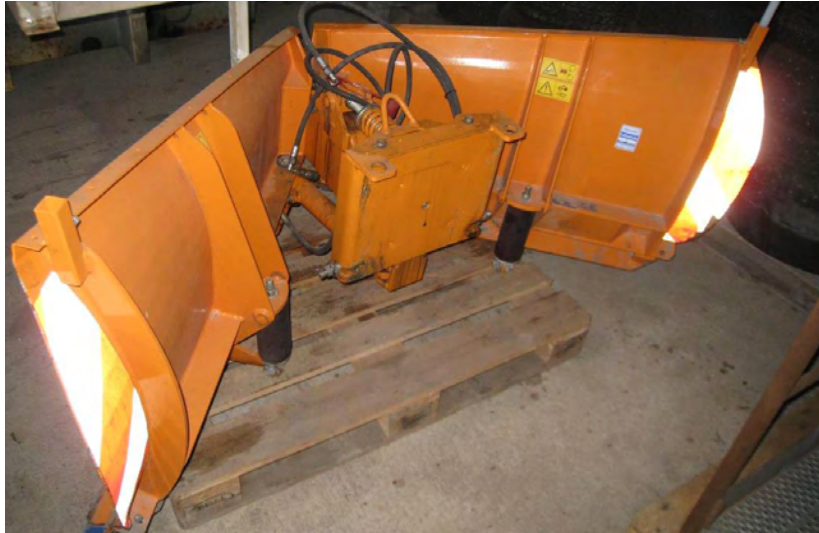
Figur 4-46 Eksempel på plog egnet for arbeid på gang- og sykkelveger
