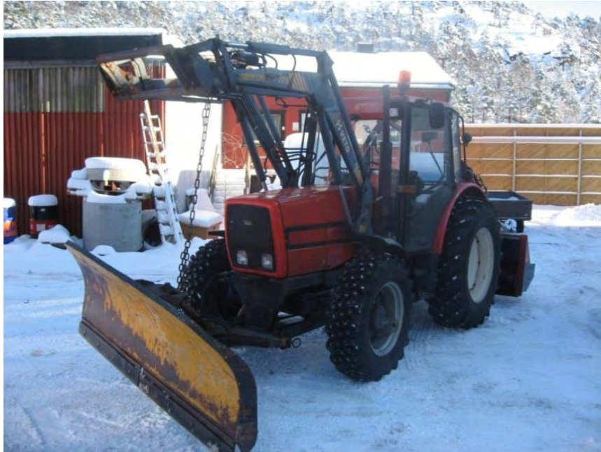
Figur 2-62 Lesseapparatet brukes til å heve og senke brøyteskjæret. Dette skaper ekstra blindsoner. (Foto: Jahn Ivar Systad)
