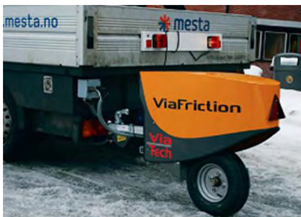
Figur 5-17 ViaFriction-friksjonsmåler, rammemontert. (Foto: ViaTech)
