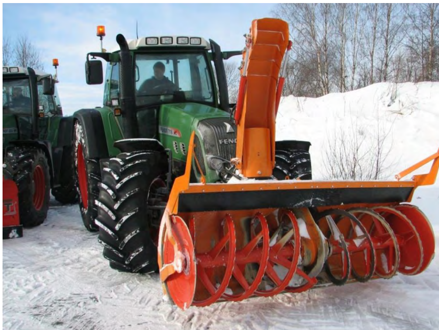
Figur 4-43 Frontmontert snøfres (Foto:Tellefsdal)
