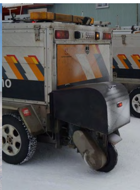
Figur 5-13 Friksjonsenhet på RoAR5 med standardisert måledekk. (Foto: Bård Nonstad, Statens vegvesen).
