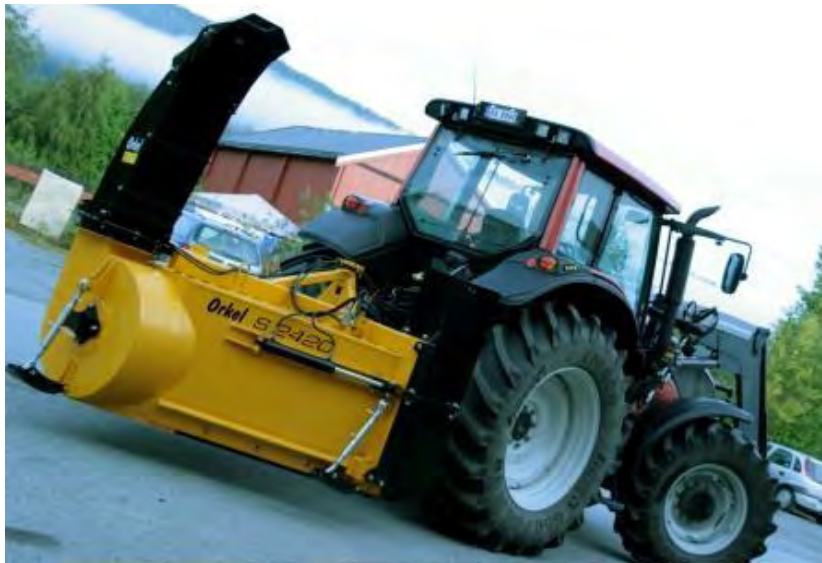
Figur 4-75 Bakmontert snøfres på traktor (Foto:Orkel AS)
