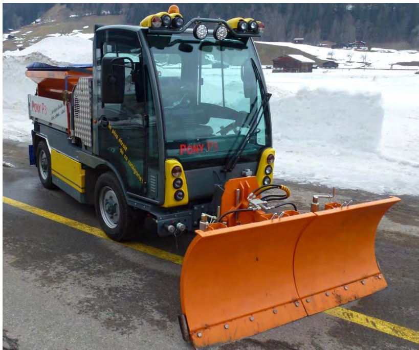
Figur 4-47 Eksempel på plog egnet for arbeid på fortau og gang- og sykkelveger (Foto: Dagfin Gryteselv, Statens vegvesen)
