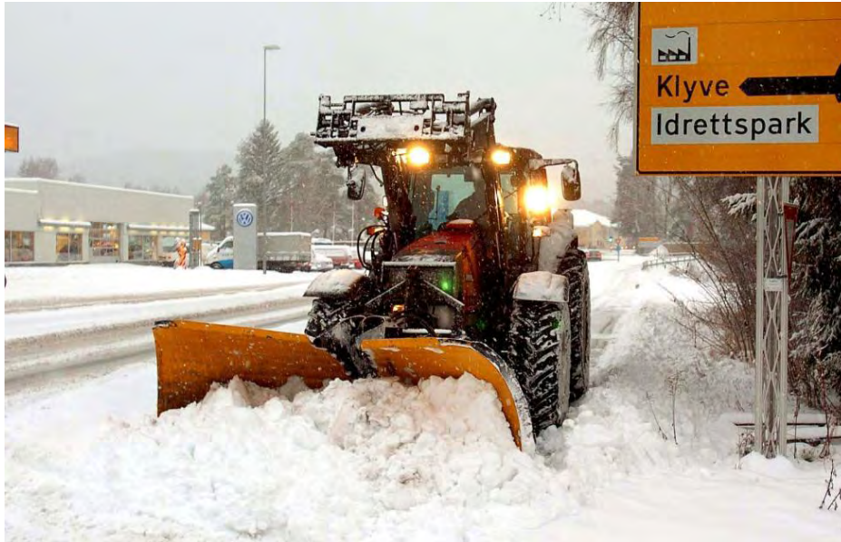
Figur 2-73 Eksempel på høyt monterte kjørellys.
