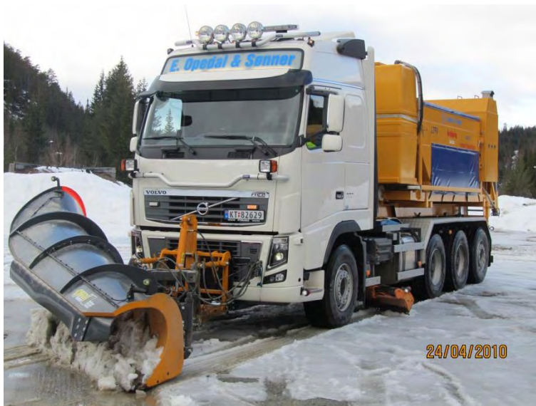
Figur 4-15 Fire-akslet lastebil utstyrt med diagonalplog, underliggende skjær og salt-/sandspreder (Foto: E. Opedal & Sønner)
