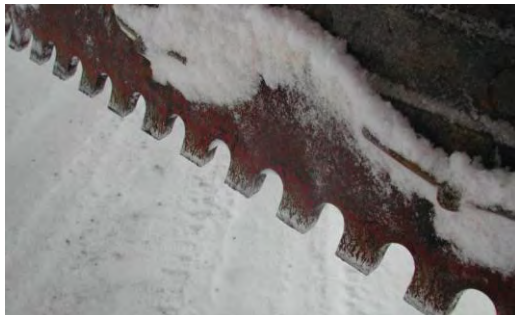
Figur 4-35 a) Isriverstål, tannet b) Hardmetallstift skjær (System 2000)
