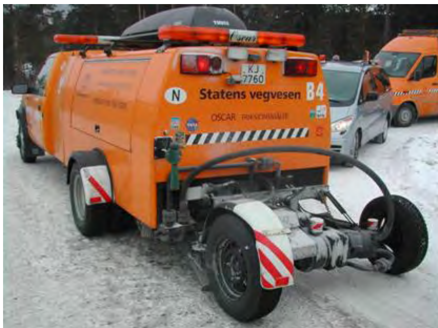
Figur 5-11 Friksjonsmåleren OSCAR. (Foto: Torgeir Vaa)
