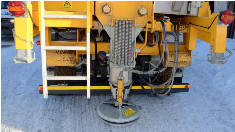
Figur 6-2 Tallerkenspreder. (Foto: Tor-Arvid Austråt Gundersen, Statens vegvesen)
