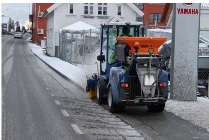
Figur 6-10 Eksempel på kjøretøy som benyttes på gang-sykkelveger i Stavanger-området (pass på sprut fra brøyteutstyr). (Foto: Eivind Stangeland, Statens vegvesen).
