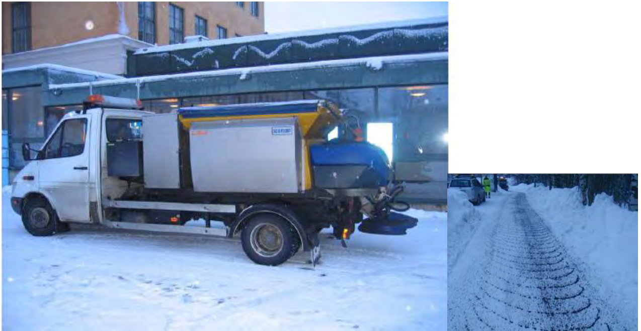
Figur 6-13 Kjøretøy for fastsandspredning på gang- og sykkelveger som benyttes i Umeå kommune. (Foto: Anna Niska, VTI Sverige)
