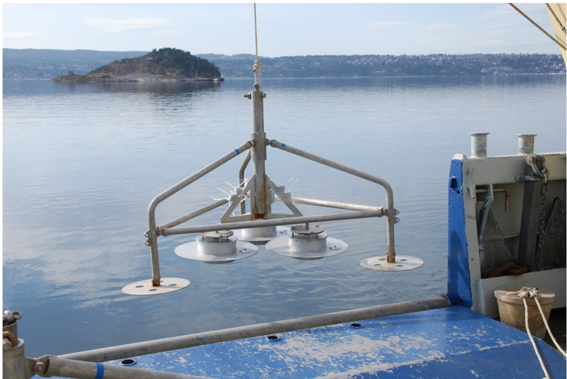
Figur 11: Rigg med 3 diffusjonskamre og passive prøvetakere knyttet på (de hvite båndene, tydeligst på det øverste bildet) klar for utsetting. Foto: Norges geotekniske institutt. Bilder tatt av Arne Pettersen.
