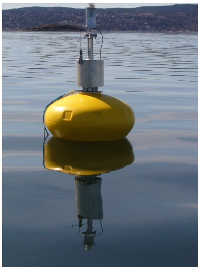
Figur 8: Turbiditetsmåler for automatiserte målinger festet til bøye. Foto: Norges geotekniske institutt. Bilde tatt av Arne Pettersen.
