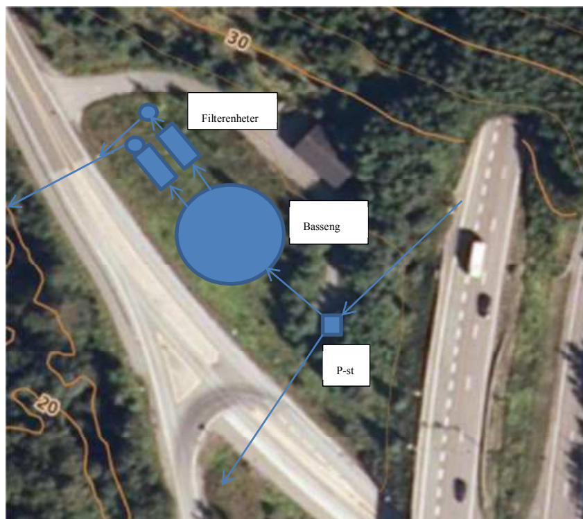
Figur 10. Prinsipputforming av rensenhet for vaskevann fra Nordbytunelen.
