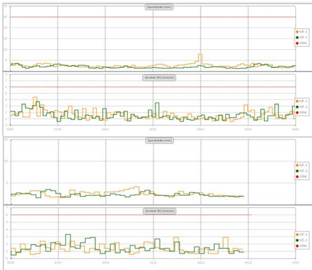
Figur 15. Spor- og jevnhetsmåling 2012, F2 (grønn) er LTA. Felt 3-4 øverst, felt 3-4 nederst.
