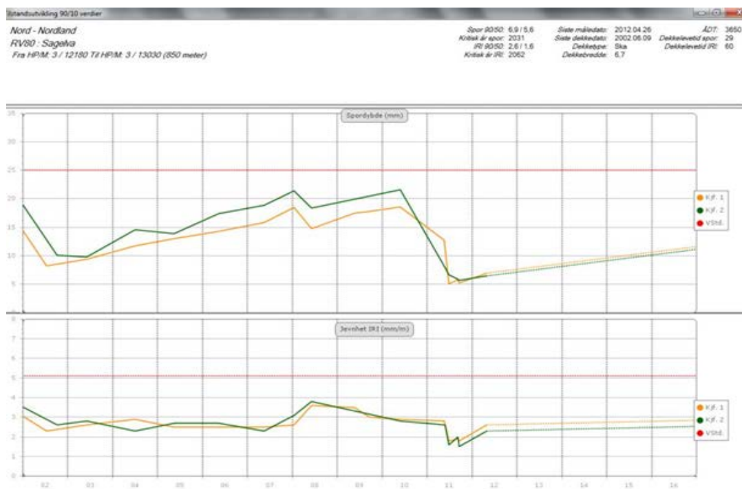
Figur 18. Tilstandsutvikling spor og jevnhet 2012, F1 (gul) er LTA.
