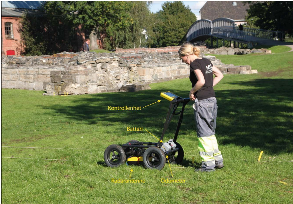
Figur 23 - Enkeltkanals radarsystem av typen Sensors and Software Noggin 500 22 . Med et slikt system er det mulig å undersøke ca. 2000-2500 m 2 per dag. Foto: NIKU.
