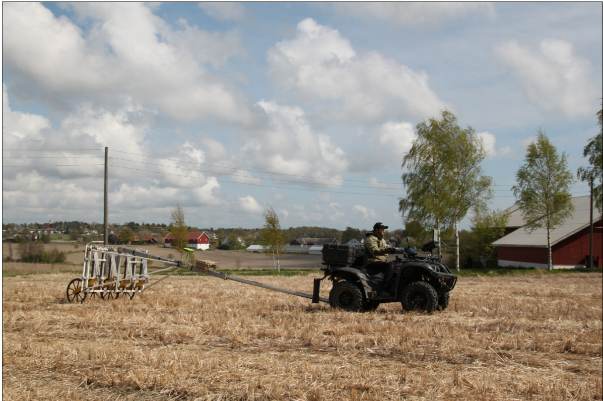
Figur 18 - Motorisert magnetometersystem brukt i forbindelse med geofysiske undersøkelser på Tjøllingvollen i Larvik, Vestfold i 2012. Foto: NIKU.
