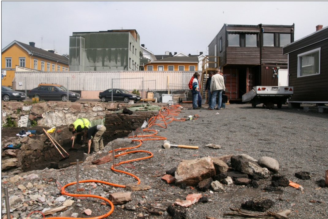
Figur 16 - ERT-målinger i forbindelse med arkeologiske utgravninger i Nedre Langgate i Tønsberg, 2009. Elektrodenes er satt ned i bakken med 50 cm mellomrom. Foto: KP/NIKU.
