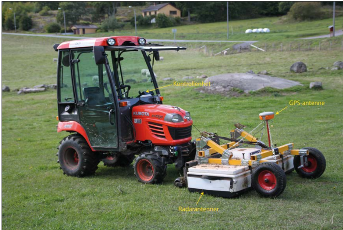
Figur 28 - Et motorisert georadarsystem av typen MALÅ MIRA ( MALÅ Imaging Radar Array ). Radarsystemet har 17 kanaler fordelt på 8 senderantenner og 9 mottagerantenner. Antennekonfigurasjonen gjør at systemet har en romlig oppløsning på 8 cm i bredden. Foto: NIKU.
