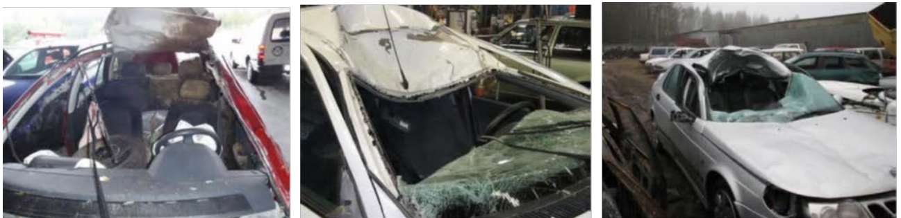
Figur 37 Forskjellige takdeformasjoner fra venstre taket rives løs, taket trykkes ned og elgen trenger inn i kupeen. (Krafft, 2011)
