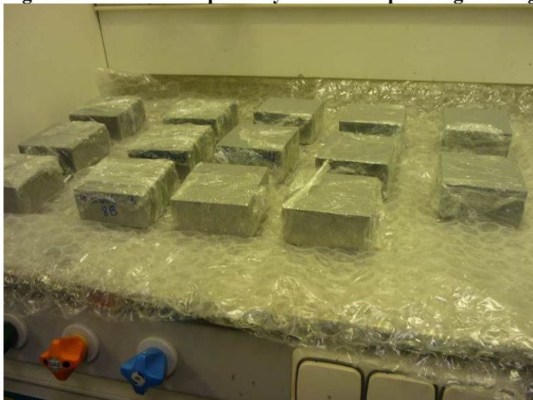
Figur 24 Foto av prøvestykker (B-halvdeler) lagret forseglet i 10 døgn før eksponering
