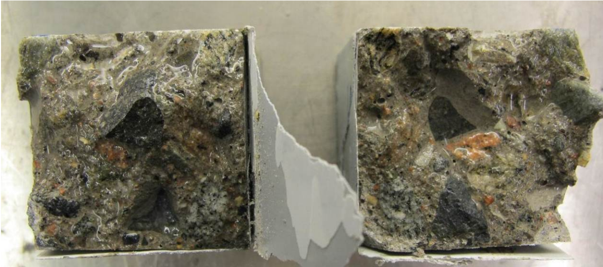
Figur 30 Bruddflater påført vann umiddelbart etter splitting, prøvestykke 16B- oppbevart i luft av 50 % RF og 20 °C i 56 døgn, deretter i luft/plastpose i 4 mnd
