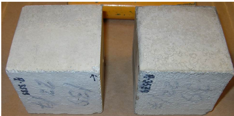
Figur 40 Prøvestykker påført 5-HI-silan krem, C(0,70) til venstre, C(0,45) til høyre, 7 døgn etter påføring (2. gangs prøving)
