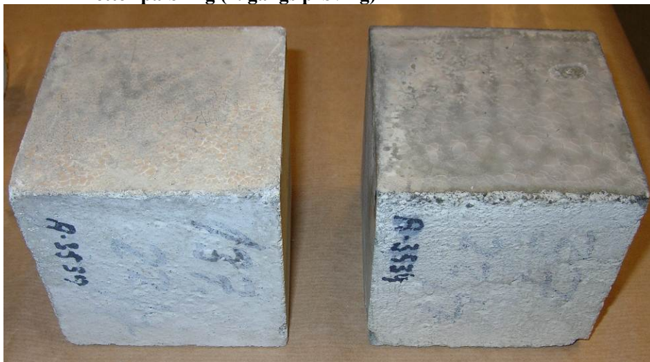
Figur 40 Prøvestykker påført 5-HI-silan krem, C(0,70) til venstre, C(0,45) til høyre, 7 døgn etter påføring (2. gangs prøving)
