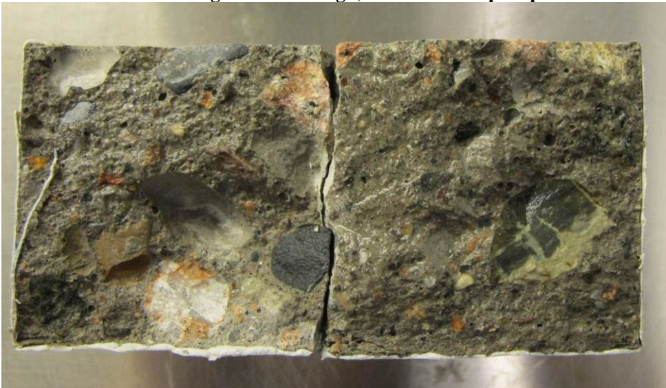
Figur 31 Bruddflater påført vann umiddelbart etter splitting, prøvestykke 17A - oppbevart permanent neddykket i 16,5 % NaCl-løsning i 56 døgn, deretter i luft/plastpose i 4 mnd
