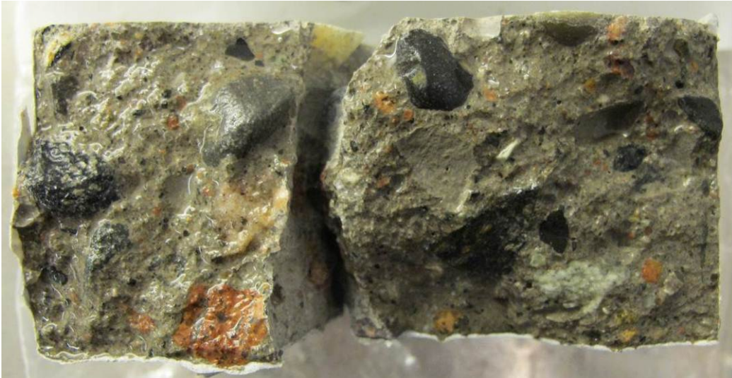
Figur 33 Bruddflater påført vann umiddelbart etter splitting, prøvestykke 18A - oppbevart periodisk påsprøytet 3 % NaCl-løsning i 56 døgn, deretter i luft/plastpose i 4 mnd
