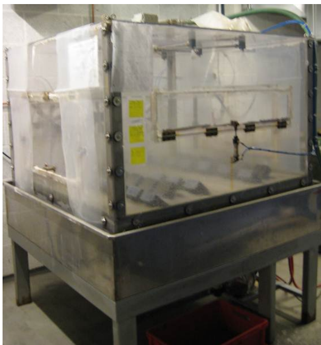
Figur 1 Kloridpåsprøytingskammeret ved Statens vegvesens Sentrallaboratorium
