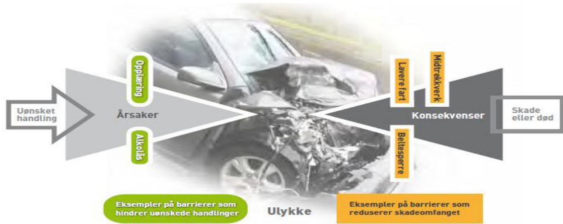
Figur 1.13 Hvordan barrierer kan hindre uønskede handlinger og redusere konsekvensene av ulykker.
