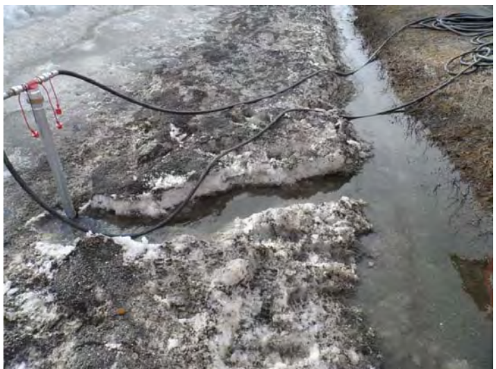
Figur 14 HW 4 Adapteret står på det dypeste stedet i grøfta, men dette blir ikke alltid det dypeste stedet når grøfta er fylt av snø/is. Foto: Håkon Svendsen, Mesta
