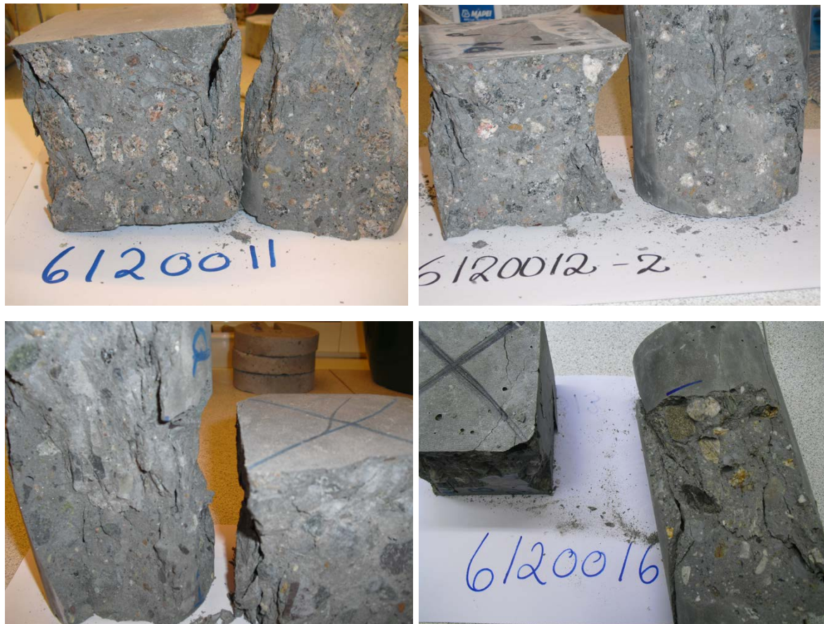
Figur 25 Bilder etter trykkprøving 90 døgn for betonger med Norcem Anleggsement FA. Øverst til venstre: Resept 1, Svelvik-Brekke. Øverst til høyre: Resept 2, Vilberg-Vilberg. Nederst til venstre: Resept 5, Sand-Steinskogen. Nederst til høyre: Resept 6 Vika-Vika.
