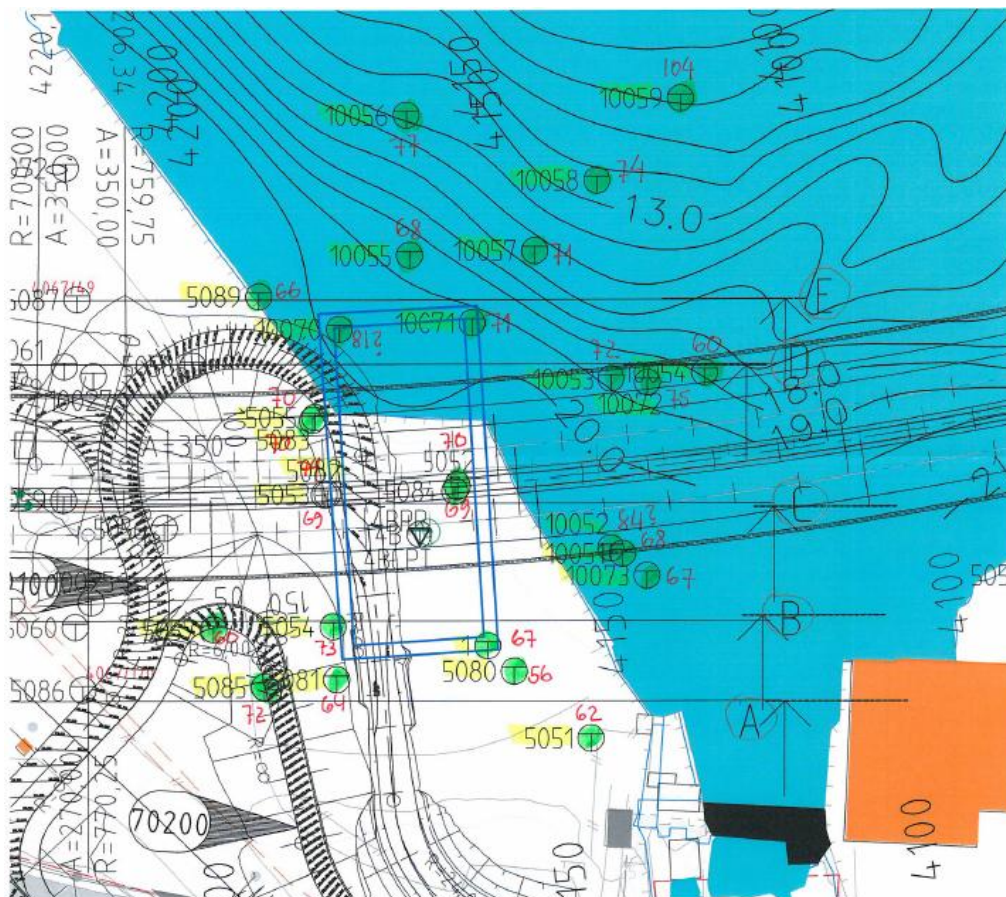
Figur 5: Totalsonderinger ved akse 7. Selve fundamentet er markert med en blå ramme. Ytre ramme er spunt. Antatt fjelldybde er gitt for hver boring.
