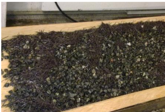
Figur 12: Akkumulering av plastfiber etter 3. forsøk.
