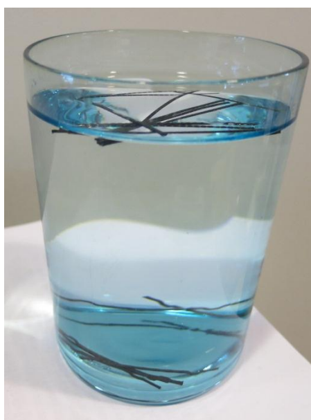
Figur 6: Plastfiber Sika Fiber LHD50/40PE med egenvekt på 1,36 \text{ kg/dm}^3 ligger på bunnen, mens den andre BarChip SHOGUN med egenvekt på 0,90 \text{ kg/dm}^3 flyter på vannoverflaten.
