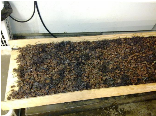
Figur 16: Fiberfordeling på grusen etter vanntilførsel i 6. forsøk.
