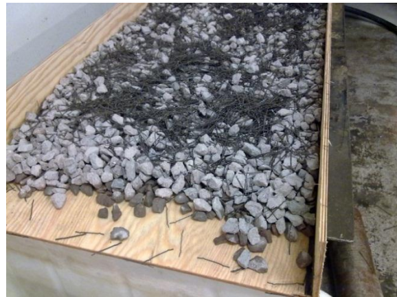
Figur 15: Lagtykkelsen med grus er 60 mm.
