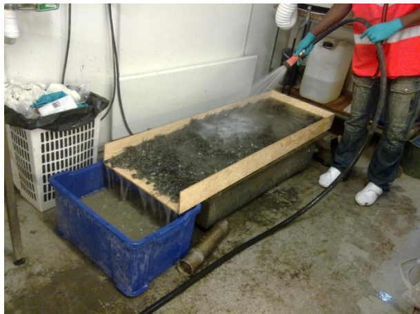
Figur 9: Forsøksrenne med grus og fiber ved påføring av vann.
