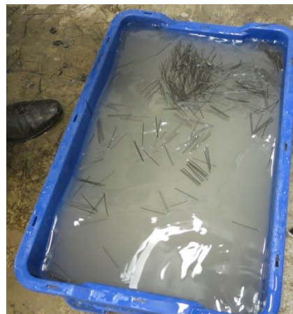
Figur 17: Spredt plastfiber (10. forsøk).
