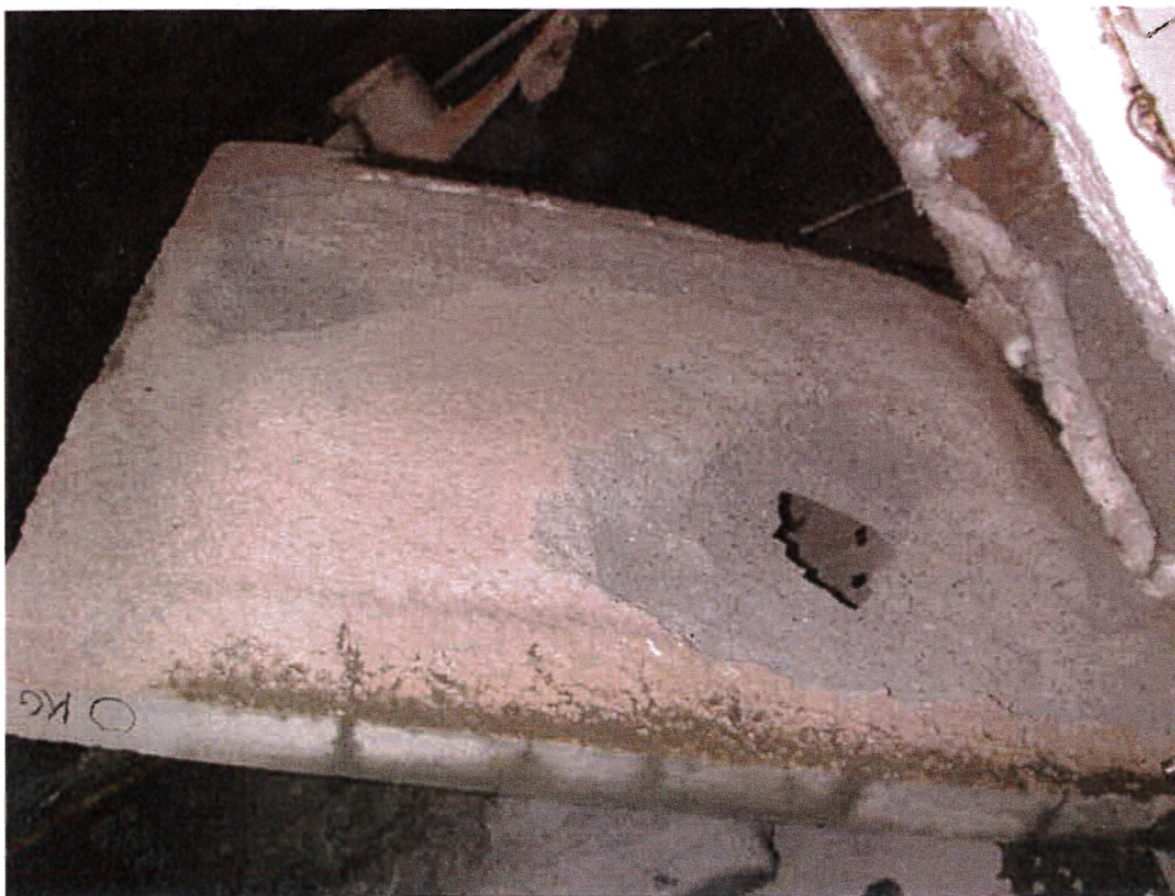
Foto 8: Eksponert side av prøvestykke H etter brann testen. Kraftig avskalling.
