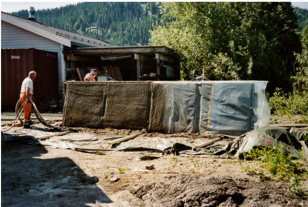
Foto 2 Paneler med 0 \text{ kg/m}^3 fiber tildekket med plast, paneler med 1 \text{ kg/m}^3 fiber ferdig sprøytet
