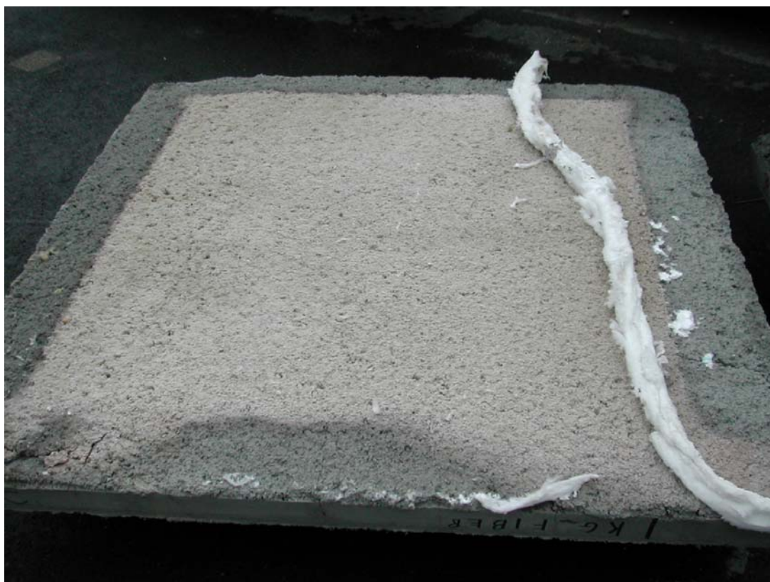
Foto 6: Eksponert side av prøvestykke F etter brann testen. Ingen avskalling.
