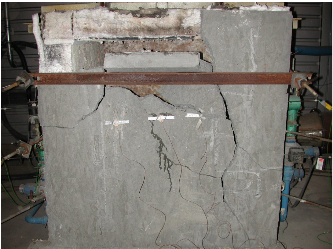
Foto 2: Ueksponert side av prøvestykke B etter branntesten. Kraftig avskalling, total kollaps av prøvestykket.
