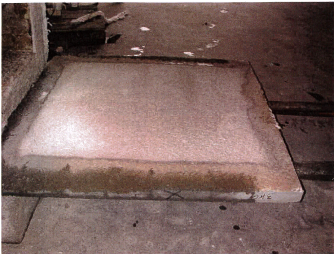
Foto 7: Eksponert side av prøvestykke G etter brann testen. Ingen avskalling.
