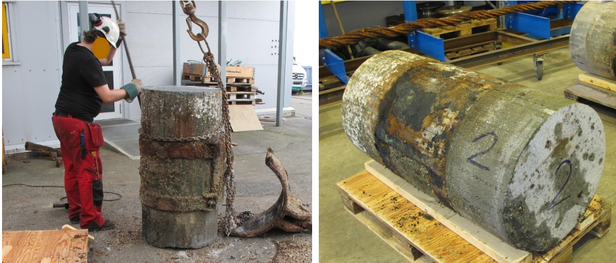
FIGUR 17: ETTER KUTTING, MIDTDEL FRA SØYLE 6 (VENSTRE) OG SØYLE 2 (HØYRE)
