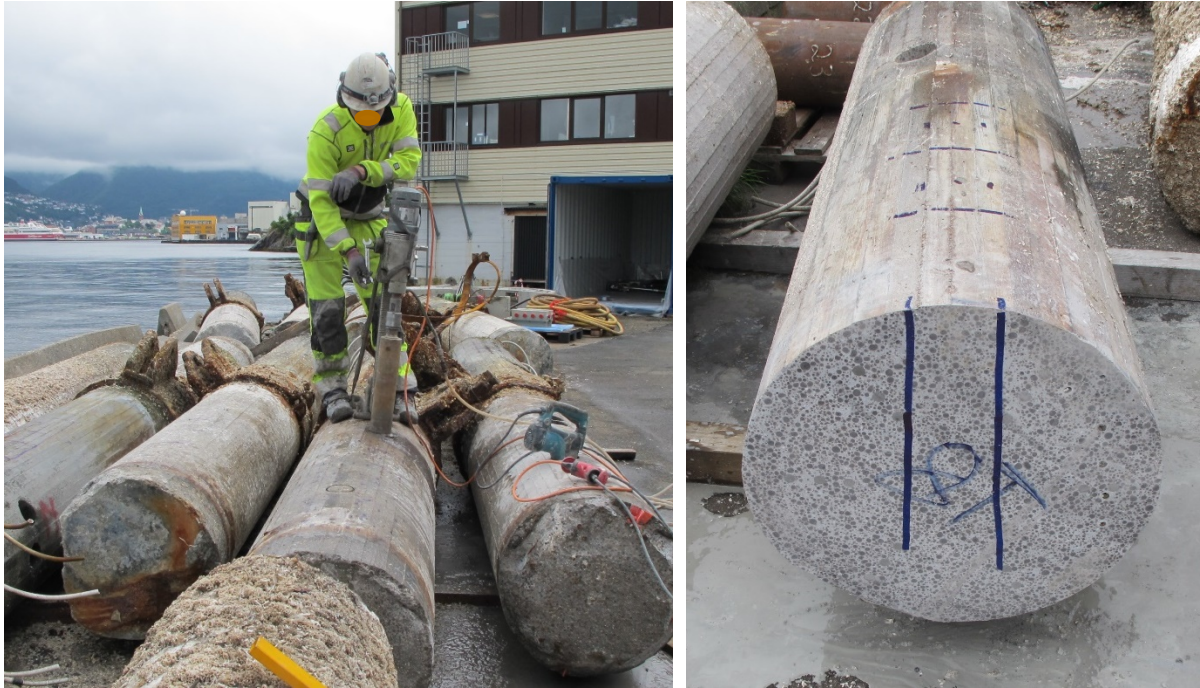
FIGUR 8: PRØVEUTTAK FRA SØYLE 8. BORING FRA BUNNDELEN FØR FRASAGING AV MIDTDEL (VENSTRE) OG MERKET FOR BORING I TOPPDELEN ETTER FRASAGING (HØYRE). ETTER SAGING VAR DET MULIG Å LOKALISERE LENGDEARMERINGEN OG DET BLE NOE LETTERE Å BORE UT KJERNER UTEN Å TREFFE ARMERING
