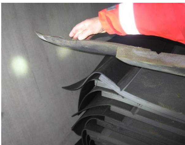
Figur 7.13 Eksempel på PE-skjørt festet til plate av PE-skum for montering kant mot kant. Bildet viser en stabel av PE-plater før montering. PE-platene har PE-skjørt påsveiset den ene langsiden, til venstre i bildet.
