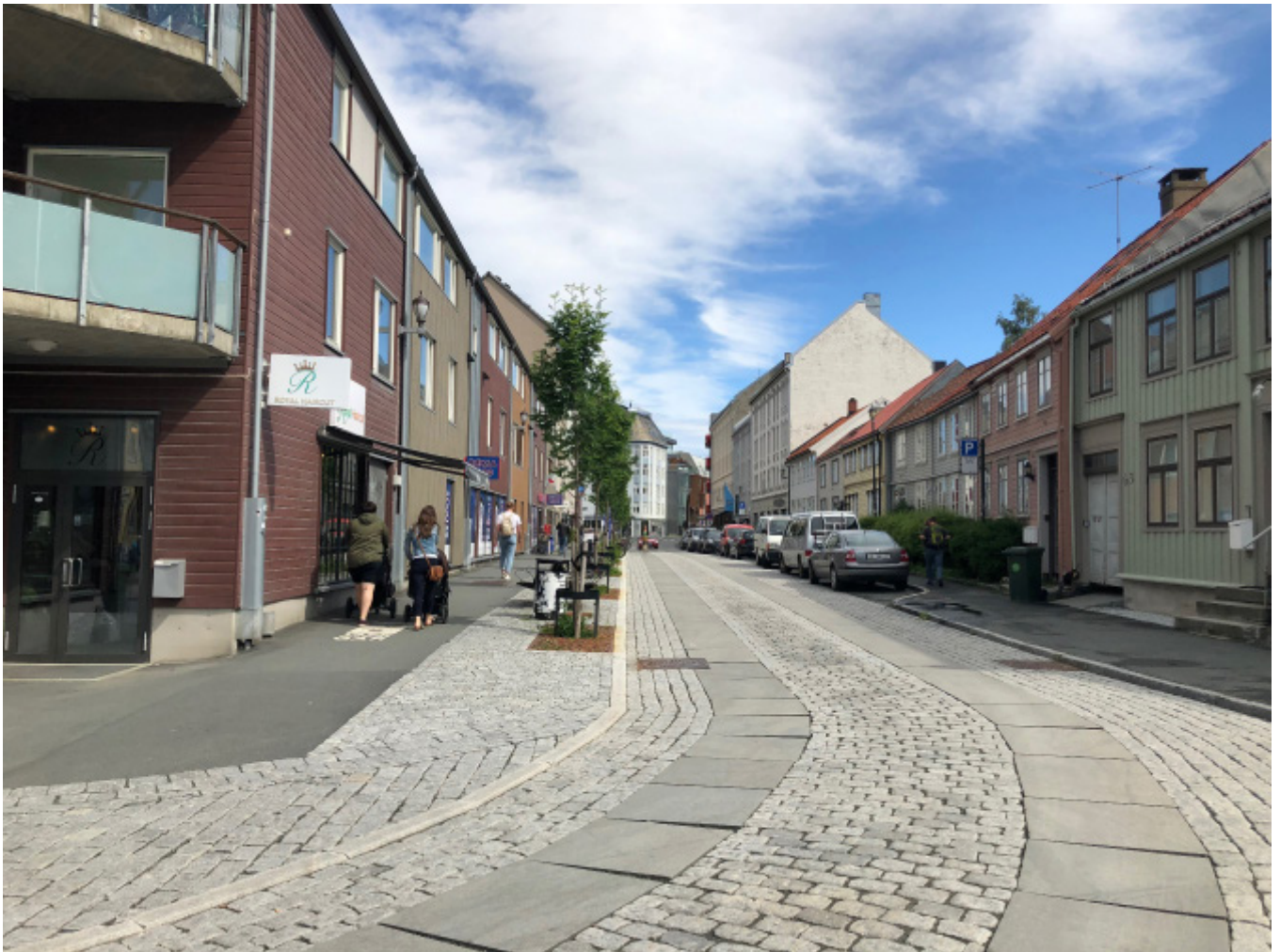
Bilde 4.3: Dette er et godt eksempel på bevisst materialbruk i ulike soner. Ferdselssonen har jevn asfalt og står i kontrast til møbleringssonen av gatestein. I kjørebanelen er det lagt store heller for syklistene. Da det er mer behagelig å gå på heller enn gatestein, velger mange å gå på hellene noe som kan skape konflikt mellom syklende og gående. Nedre Bakklandet, Trondheim. Foto: Frøydis Hollakleiv.
