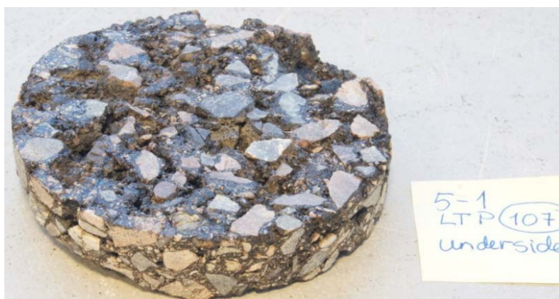
Figur 16. Borkjerneprøve (LTA 107). Underside av prøven med mye, synlige hulrom. Avskalling langs kanten (ved utboring) øverst til høyre på prøven. (foto: Kjersti Solstad)
