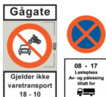
Figur 3.42 og 3.43: Trafikkskilt som viser tidsregulering av varelevering og parkering. Illustrasjoner: Statens vegvesen.
