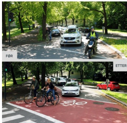
Figur 3.18: Sykkelboks: Ventefelt foran bilene i lysregulerte kryss gjør syklistene mer synlige for bilistene. (Sykkelprosjektet/Oslo kommune, u.d).
