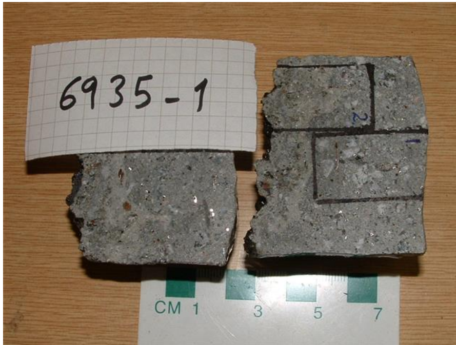
V4.54. Kjerne 6935-1 med tynnslipområder. Betongalder 12 år. Foto: Per Hagelia
