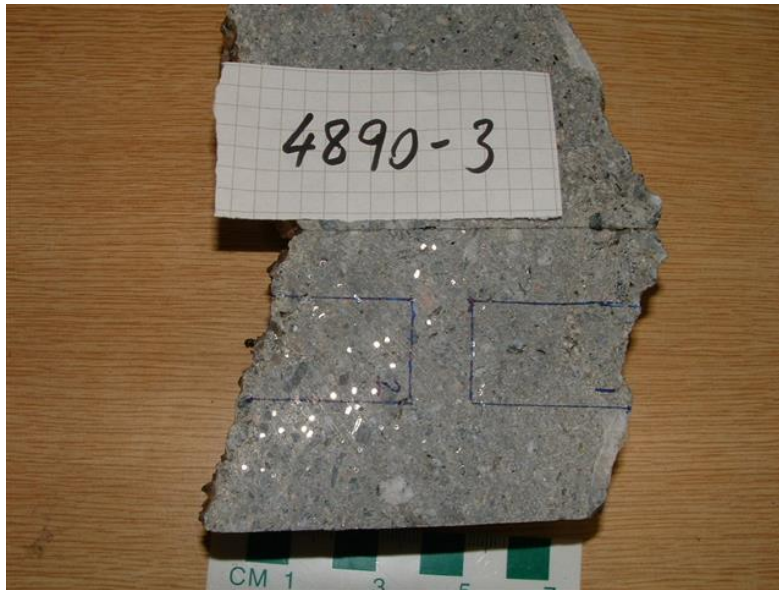
V4.50. Kjerne 4890-3 med tynnslipområder. Betongalder 12 år. Foto: Per Hagelia
