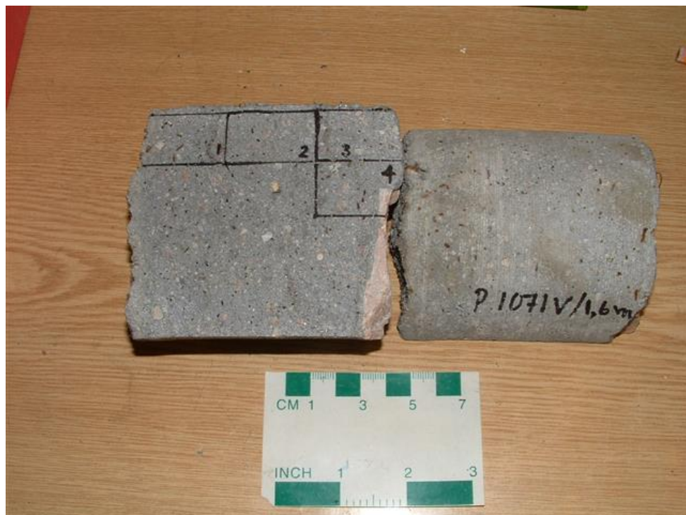
V4.14. Kjerne 1071 med tynnslipområder. Betongalder 15 år. Foto: Per Hagelia.
