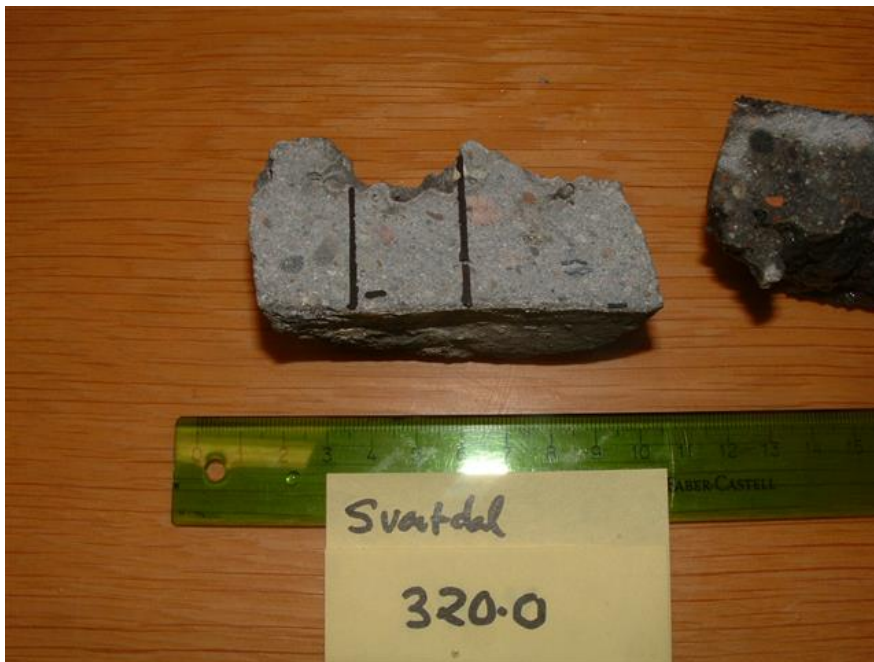
V3.58. Kjerneprøvene 320 N og 320 O med tynnslipområda. Betongalder 8 år. Foto: Per Hagelia
