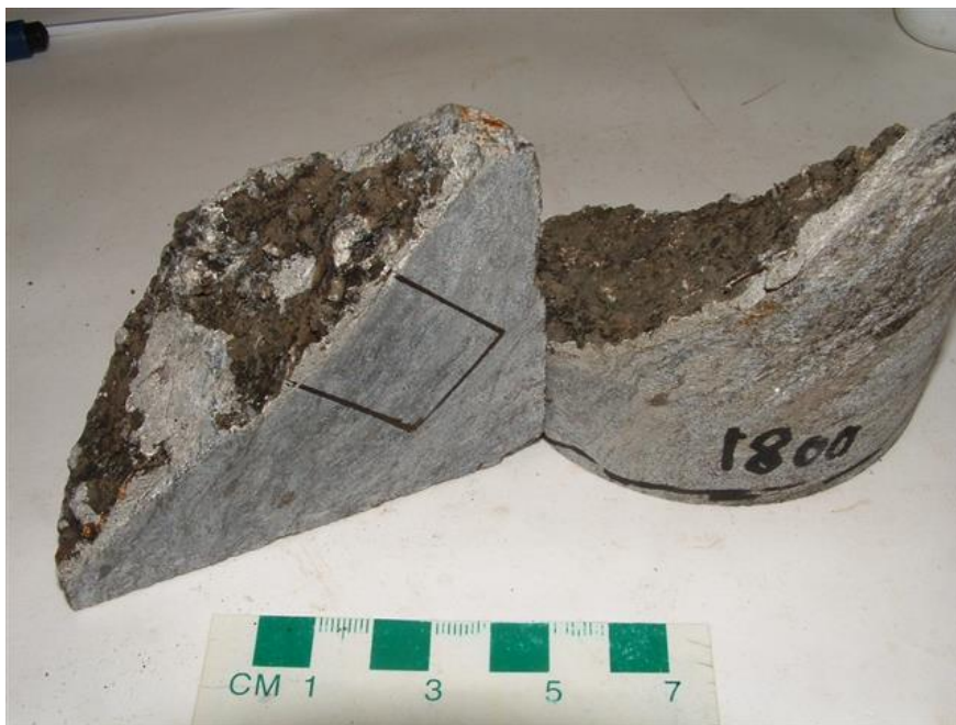
V4.18. Kjerne 1800 med tynnslipområde. Svært tynn betong under biofilm. Muleg at noko av betongen er tæra bort. Betongalder 15 år. Foto: Per Hagelia.
