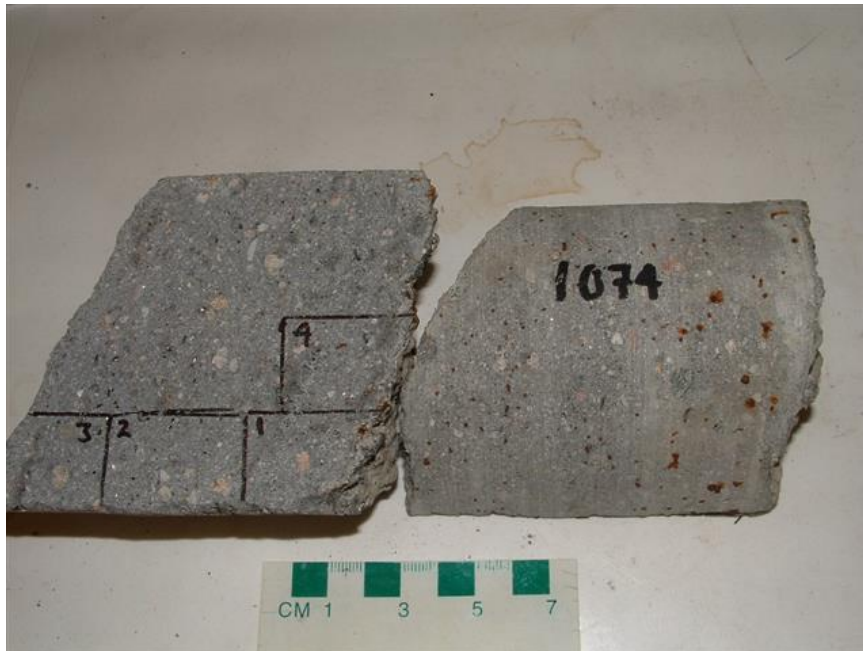
V4.15. Kjerne 1074 med tynnslipområder. Betongalder 15 år. Foto: Per Hagelia.
