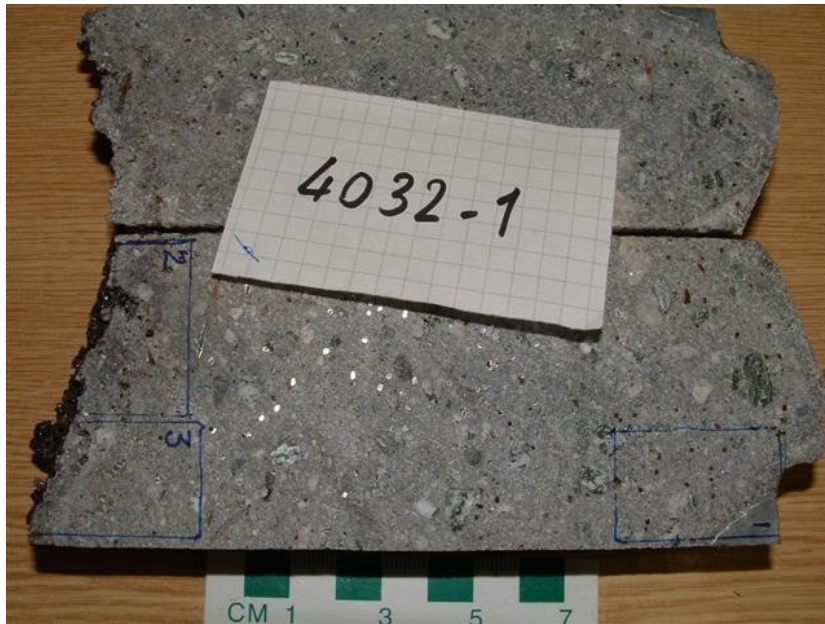
V4.48. Kjerne 4032-1 med tynnslipområder. Betongalder 12 år. Foto: Per Hagelia
