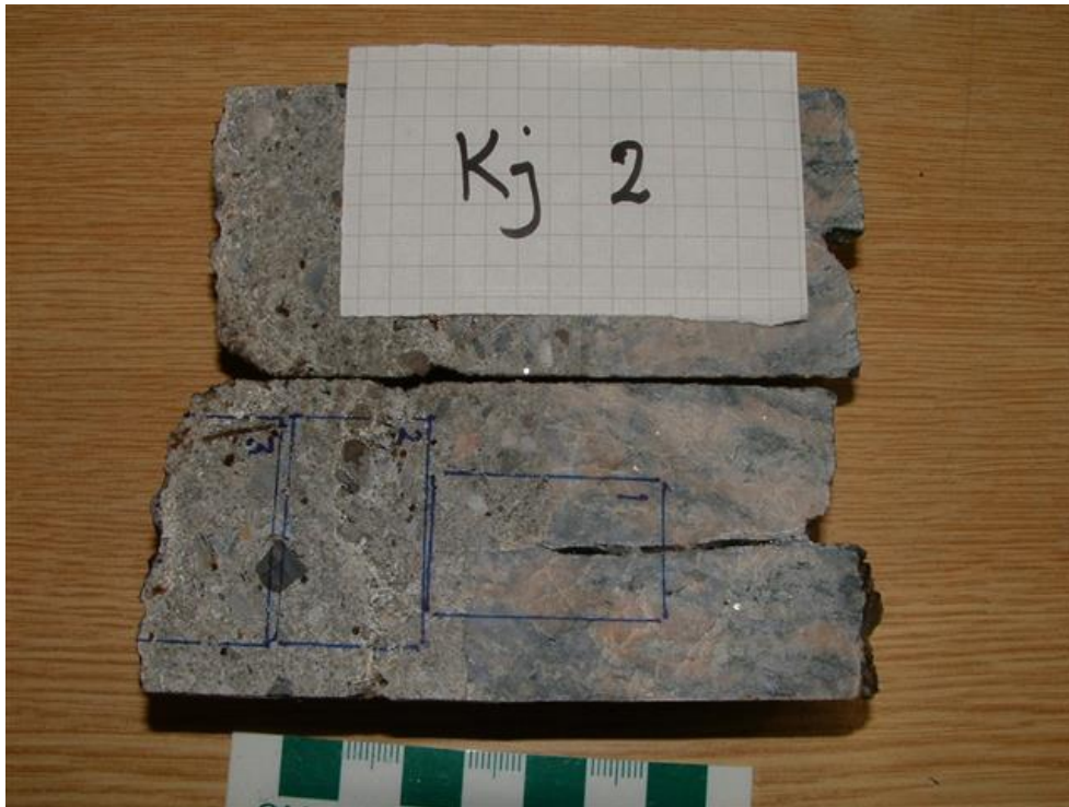
V4.97. Kjerneprøve Kj 2 ved pelnummer 15925 under tynn biofilm (Mn-Fe skorpe) utan særleg syreverknad. Innteikna tynnslipområde. Betongalder 5 år. Foto: Per Hagelia.
