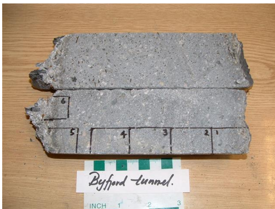
V4.36. Kjerne Core 1-2 med tynnslipområder. Omvandling av sementpasta og stålfiberkorrosjon i karbonatisert sone 20-30 mm inn frå berg (venstre ende). Heftsona inneheld nokre fragment av fyllitt. Betongalder 13 år. Foto: Per Hagelia.
