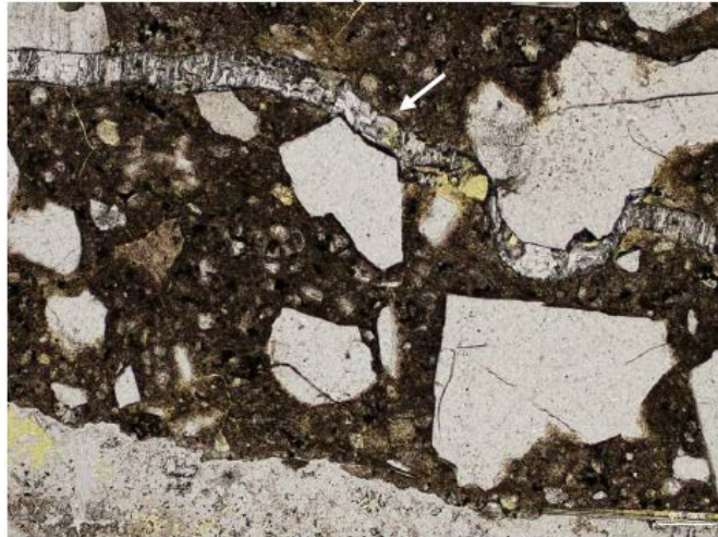
Foto nr 13. Indre tynnslip. Bildet viser ettringittlignende utfelling i riss øverst på bildet (pil). Nederst på bildet ses det lyse karbonatlaget mot fjellkontakten.
