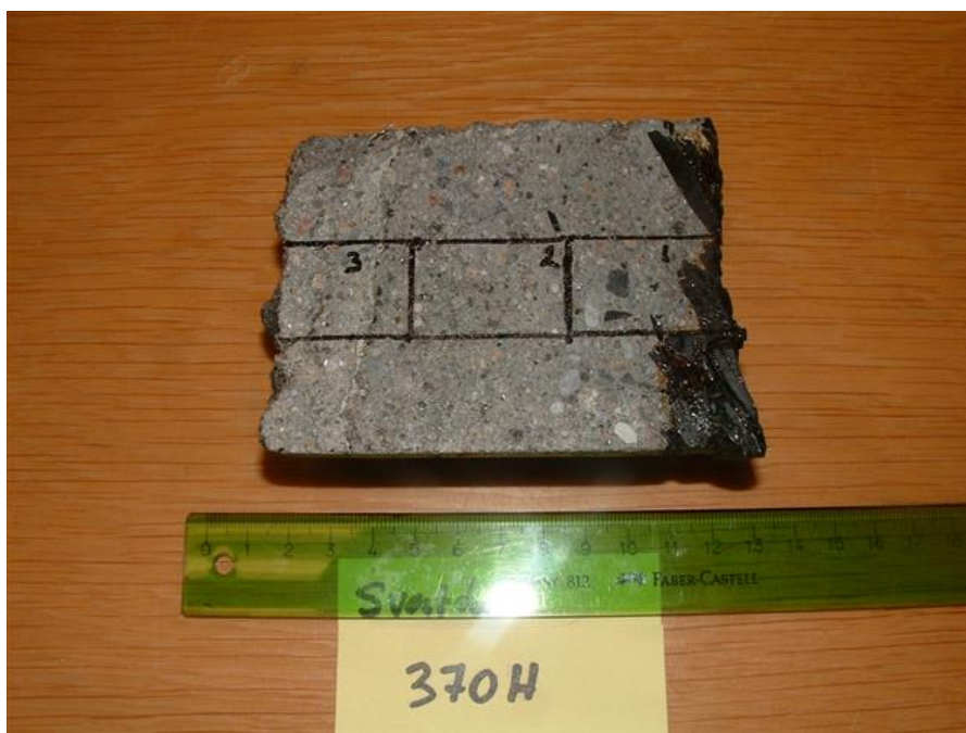
V3.57. Kjerneprøvene 370V og 370H med tynnslipområda. Betongalder 8 år. Foto: Per Hagelia.
