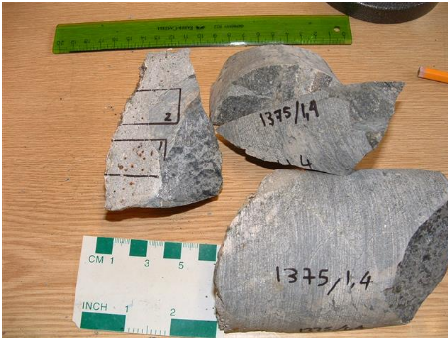
V4.17. Kjerne 1375 med tynnslipområder. Tynn betong med omfattende stålfiberkorrosjon (sett i tynnslip). Betongalder 15 år. Foto: Per Hagelia.
