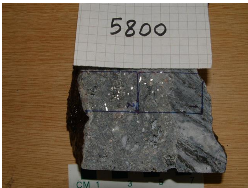
V4.52. Kjerne 5800 med tynnslipområder. Betongalder 12 år. Foto: Per Hagelia
