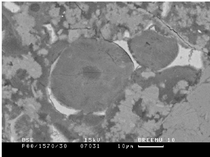
V3.14. Udispersert silika i Åkebergveien (runde), omgitt av utluta sementpasta (mørk grå) og Popcorn kalsitt (lysare grå). Bare godt dispersert silika gir ønska effekt. Foto: Derek Metcalf, BRE-Garston, Watford.
