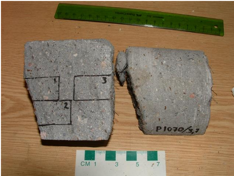
V4.13. Kjerne 1070 med tynnslipområder. Betongalder 15 år. Foto: Per Hagelia.
