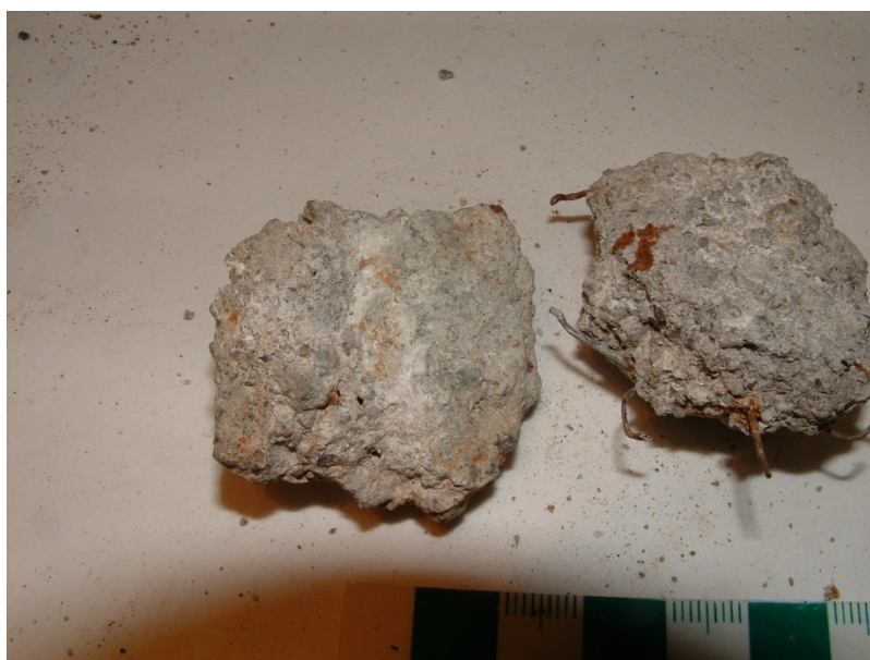
V4.94. Kjerne KJ IV (gjenverande fragment) under tykk syregivande biofilm: Utboring inntil ca. 60 mm mot berg førte til full nedknusing av kjerna. Estimert tap av tverrsnitt før utboring ca. 25 mm. Resten av kjerna var svært svak og bare to fragment blei bevart. Intern nedbrytingsmekanisme tilsvarande KJ II og KJ III. Ingen heft mot berg. Betongalder 5 år. Foto: Per Hagelia.
