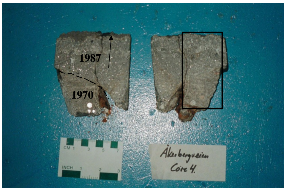
V3.8. Kjerne Core 4 med tynnslip område for BRE nr. P00/1570/30. Kjerna hadde ein ca. 30-50 mm rest av sprøytebetongen frå 1970 med stålrubber som armering under ca. 40 mm stålfiberarmert sprøytebetong og 20 mm ytre fiberfri betong frå 1987. Begge betongane var litt svekka av Ca-utluting, thaumasitt sulfatangrep og Popcorn kalsitt. Stålet i stor grad var intakt gjennom heile tverrsnittet. Foto: Per Hagelia.
