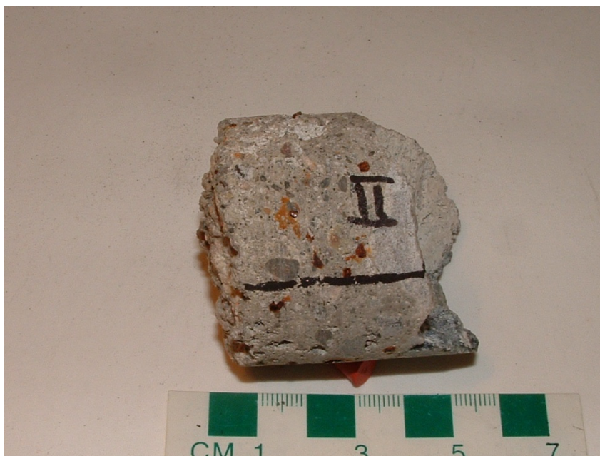
V4.92. KJ II av sprøytebetong under tykk syregivande biofilm med litt tap av tverrsnitt (estimert til 1 mm). Tynnslip viste utluting av sementlimet med intern karbonatisering (Popcorn kalsitt), magnesiuminntrenging, thaumasitt sulfatangrep og fiberkorrosjon. Dårlig heft med utfelling av brucitt på kontakt med berg (høgre). Betongalder 5 år. Foto: Per Hagelia.
