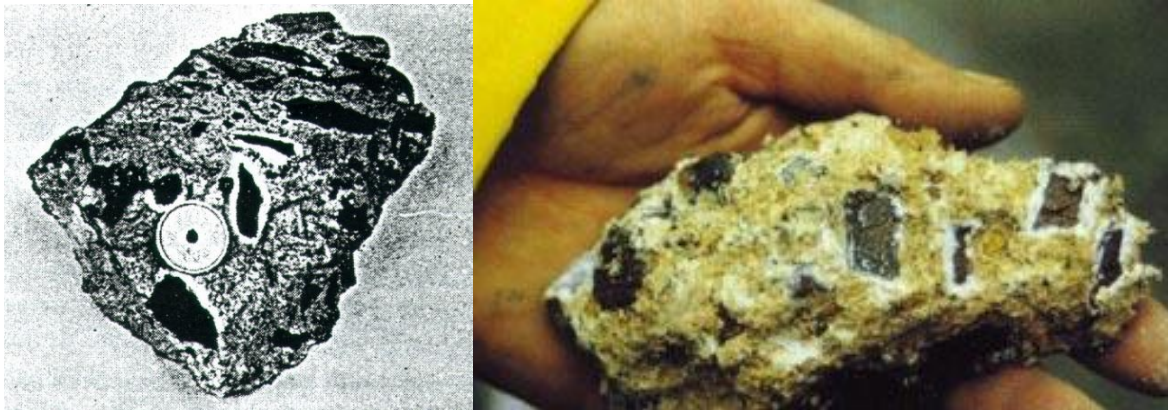
Figur 2.2: Fullskala thaumasitt sulfatangrep. Venstre: Karakteristiske lyse soner («halo») av nedbroten betong omkring alunskifertilslag i gammel betong frå Oslo (Bastiansen mfl. 1957). Nyare undersøkingar har vist at dei velkjente alunskiferskadane var forårsaka av thaumasitt og ikkje ettringitt. Høgre: Lyse soner av thaumasitt omkring sulfidførande skifer i britisk betong (Department of the Environment, Transport and the Regions, 1999).
