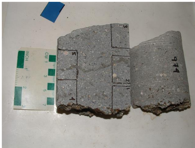
V4.12. Kjerne 974 med tynnslipområder. Betongalder 15 år. Foto: Per Hagelia.
