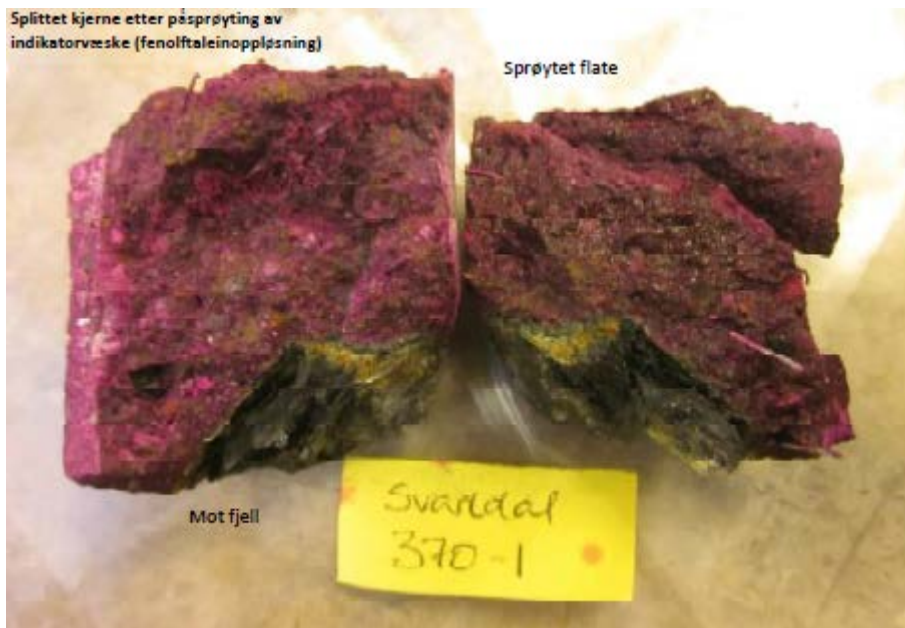
V3.51. Kjerne 370-1 var utan karbonatisering, verken i overflata eller mot heftsona. Dokumentasjonen tyder på gode heftegenskapar. Betongalder 16 år. Foto: Mannvit.
