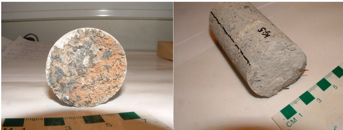
V4.98. Kjerneprøve Kj 5 ved pelnummer 15925 under tykk opprinneleg våt Mn-Fe biofilm (restar på kjerneenden viser lagdeling (venstre). Høgre bildet viser grå utfelling av kalsiumkarbonat (kalsitt og aragonitt) på heftsona. Det blei preparert tre tynnslip på langs av kjerna. Betongalder 5 år. Foto: Per Hagelia.
