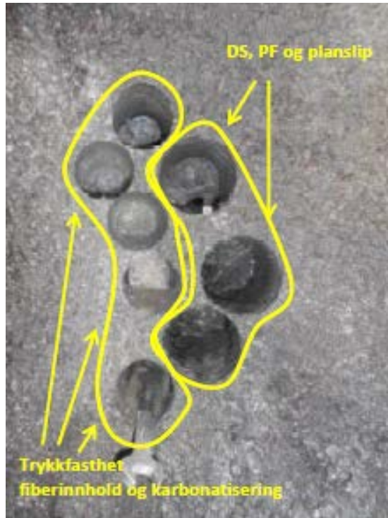
V3.21. Ekeberg tunnelen, pelnummer 1706H. Tørr overflate. Oversikt over prøvestader (ikkje strukturanalyse og tynnslip). Betongalder 22 år. Foto: Mannvit.
