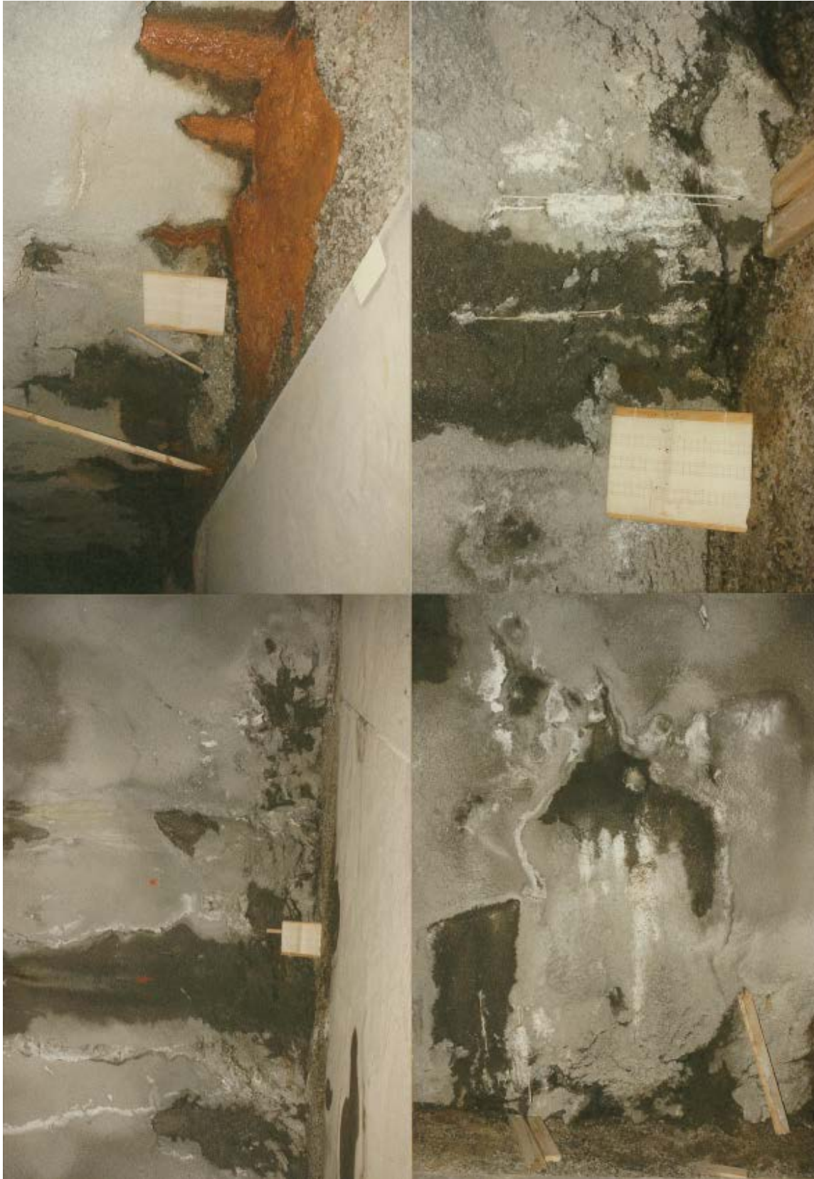
V2.2. Utfellingar av kalsiumkarbonat og natriumsulfat (kvit) i Harpefosstunnelen 1997. Betongalder 13 år. Merk lokal bioakkumulasjon (rusta jernbakteriar). Det var inga endring å merke ved undersøkinga i 2000. Foto: Per Hagelia.
