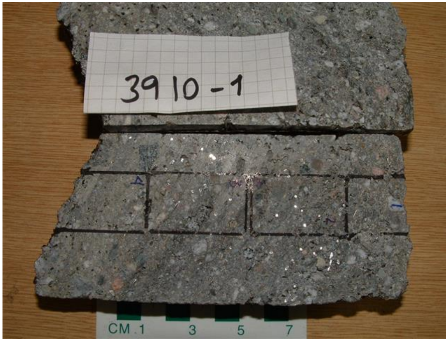
V4.46. Kjerne 3910-1 med tynnslipområder. Betongalder 12 år. Foto: Per Hagelia.
