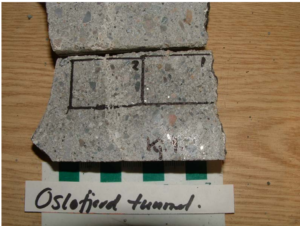
V4.96. Kjerneprøve Kj 1 ved pelnummer 15925 under tynn biofilm utan særleg syreverknad., med innteikna tynnslipområde. Det er utfelt tynn mørk Mn-rik biofilm på ytterflata. Betongalder 5 år. Foto: Per Hagelia.
