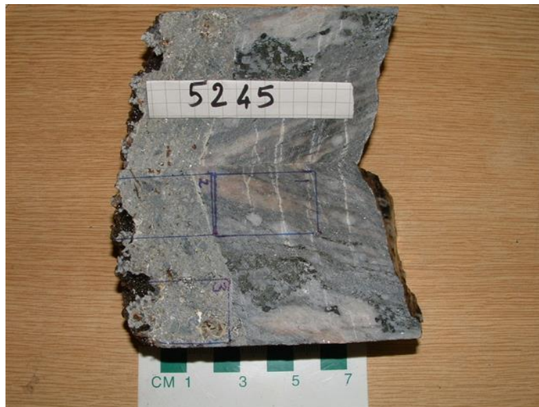
V4.51. Kjerne 5245 med tynnslipområder. Betongalder 12 år. Foto: Per Hagelia
