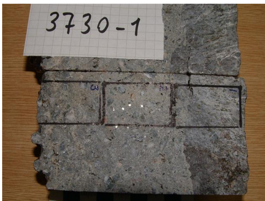
V4.44. Kjerne 3730-1 med tynnslipområder. Betongalder 12 år. Foto: Per Hagelia.
