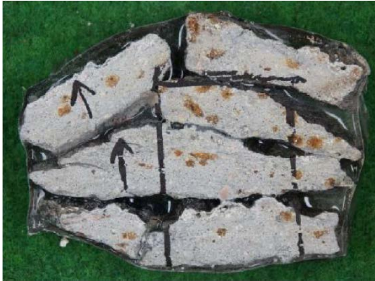
V4.22. Prøve ST1380 med tynnslipområde. Området hadde kraftig avskaling. Noko av betongen tæra bort. Betongalder 26 år. Foto: Mannvit.
