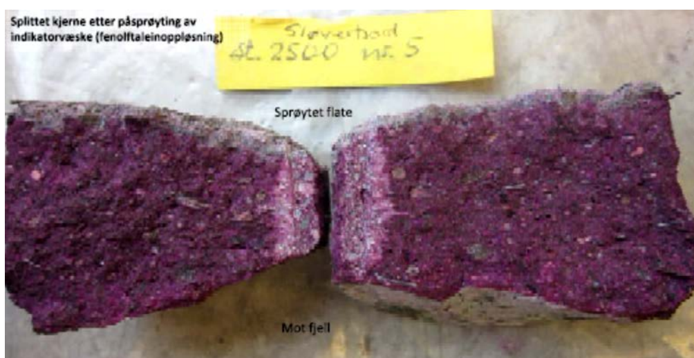
VI.32. Karbonatisering avgrensa til overflata. Kjerne 2500-5. Betongalder 18 år. Foto: Mannvit.
