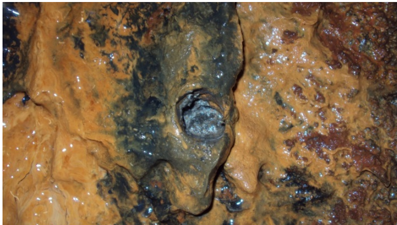
Figur 3 Mikrobiologisk prøvetaking gjennom biofilm og ytre del av sprøytebetong i Oslofjordtunnelen, utført av Chalmers Gøteborg. Foto: Statens vegvesen.
