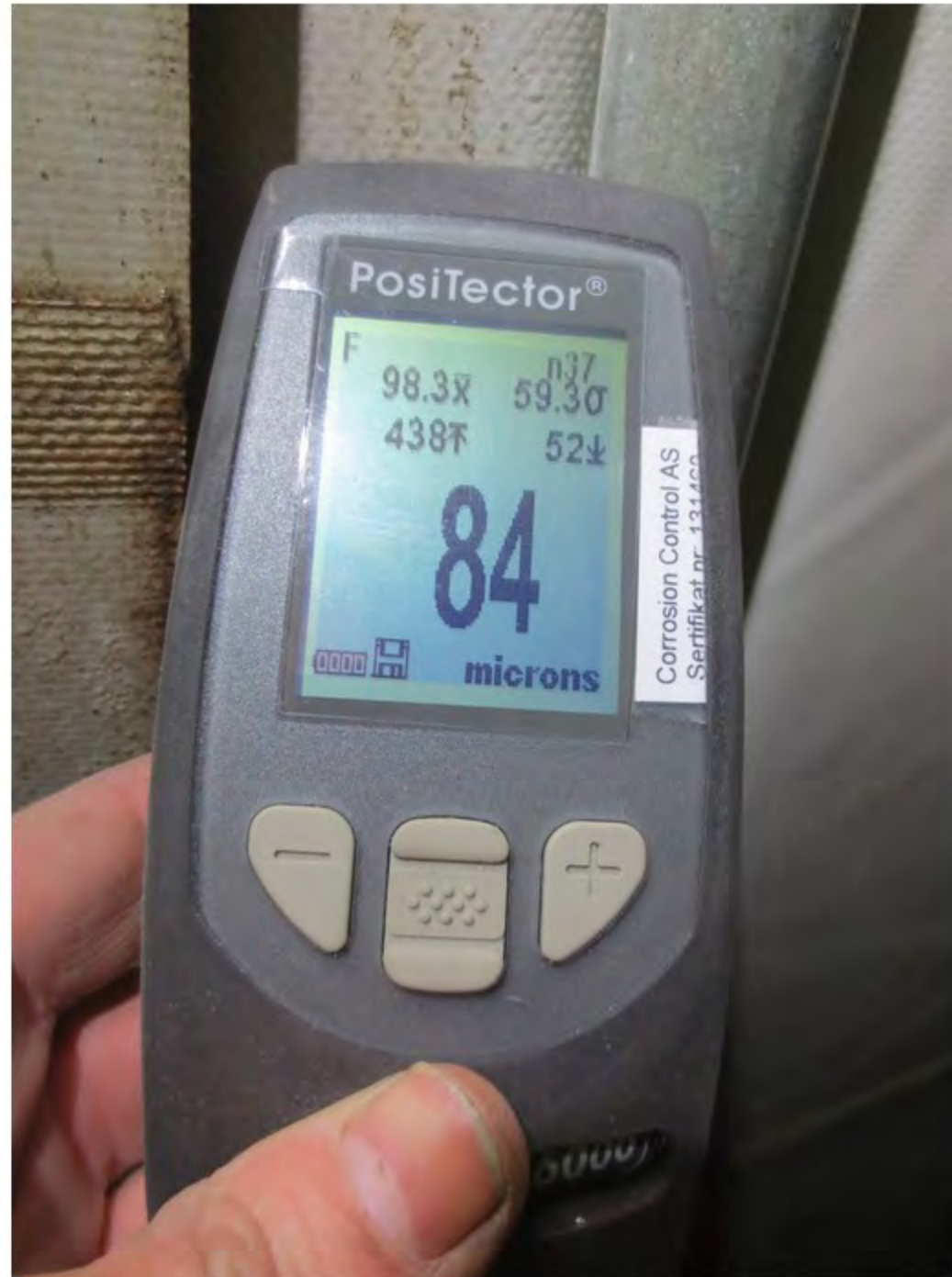
31 Profil 200 Bakrør - Tykkelse varmforsinking 84 my
