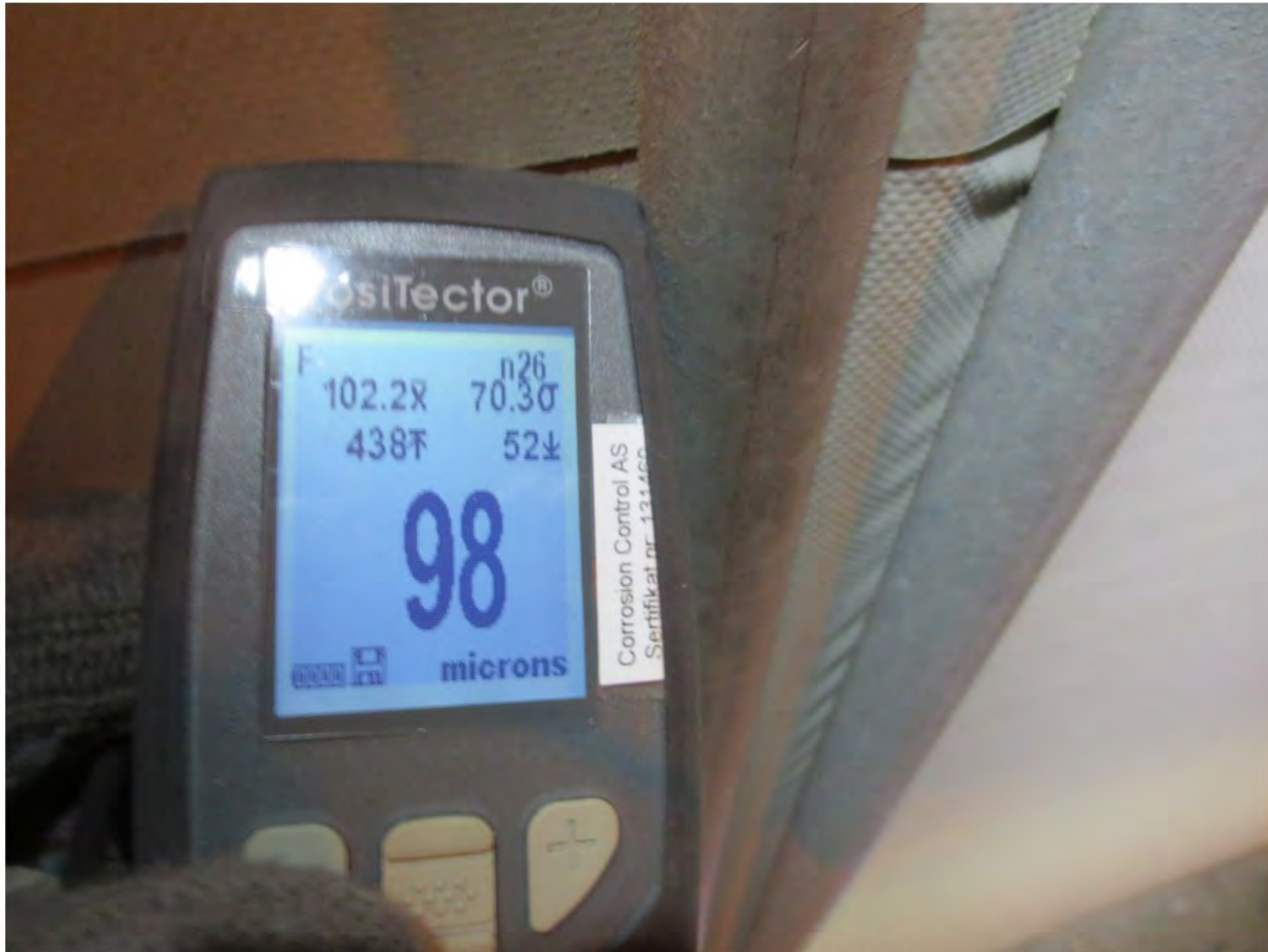
9 Profil 100 Framrør - Tykkelse varmforsinking 98 my
