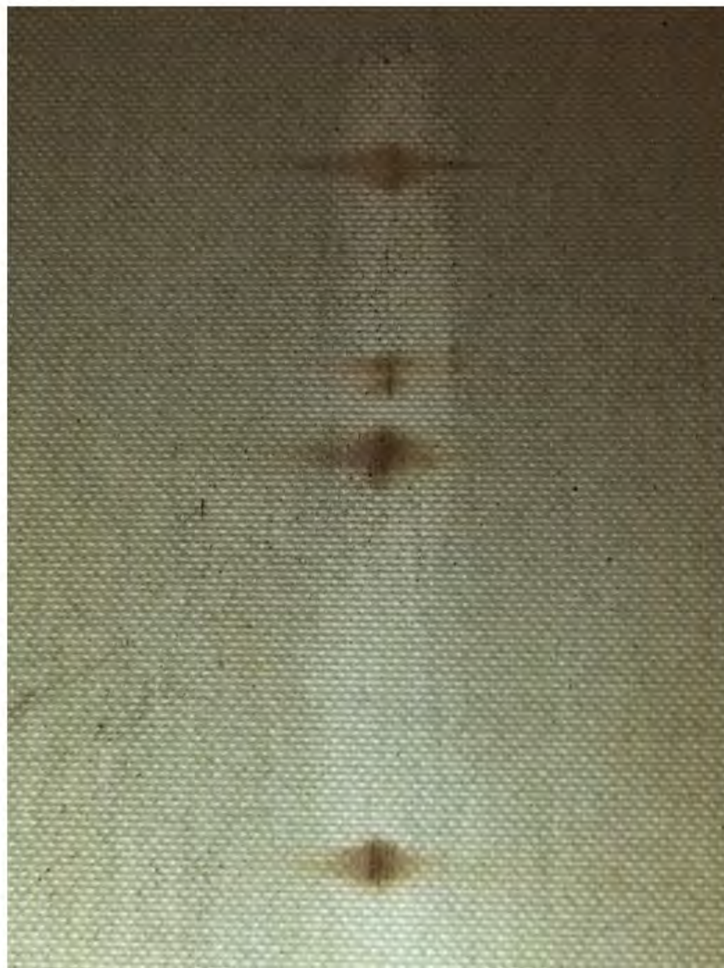
12 Misfargingar inni dukmaterialet i brett
