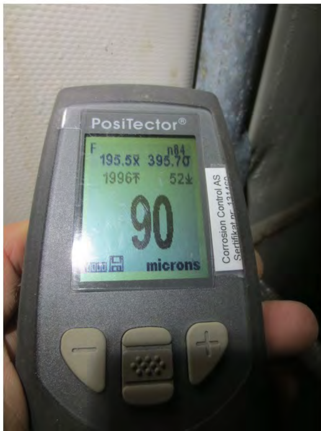
28 Profil 100 - Tykkelse varmforsinking på bakrør - 90 my
