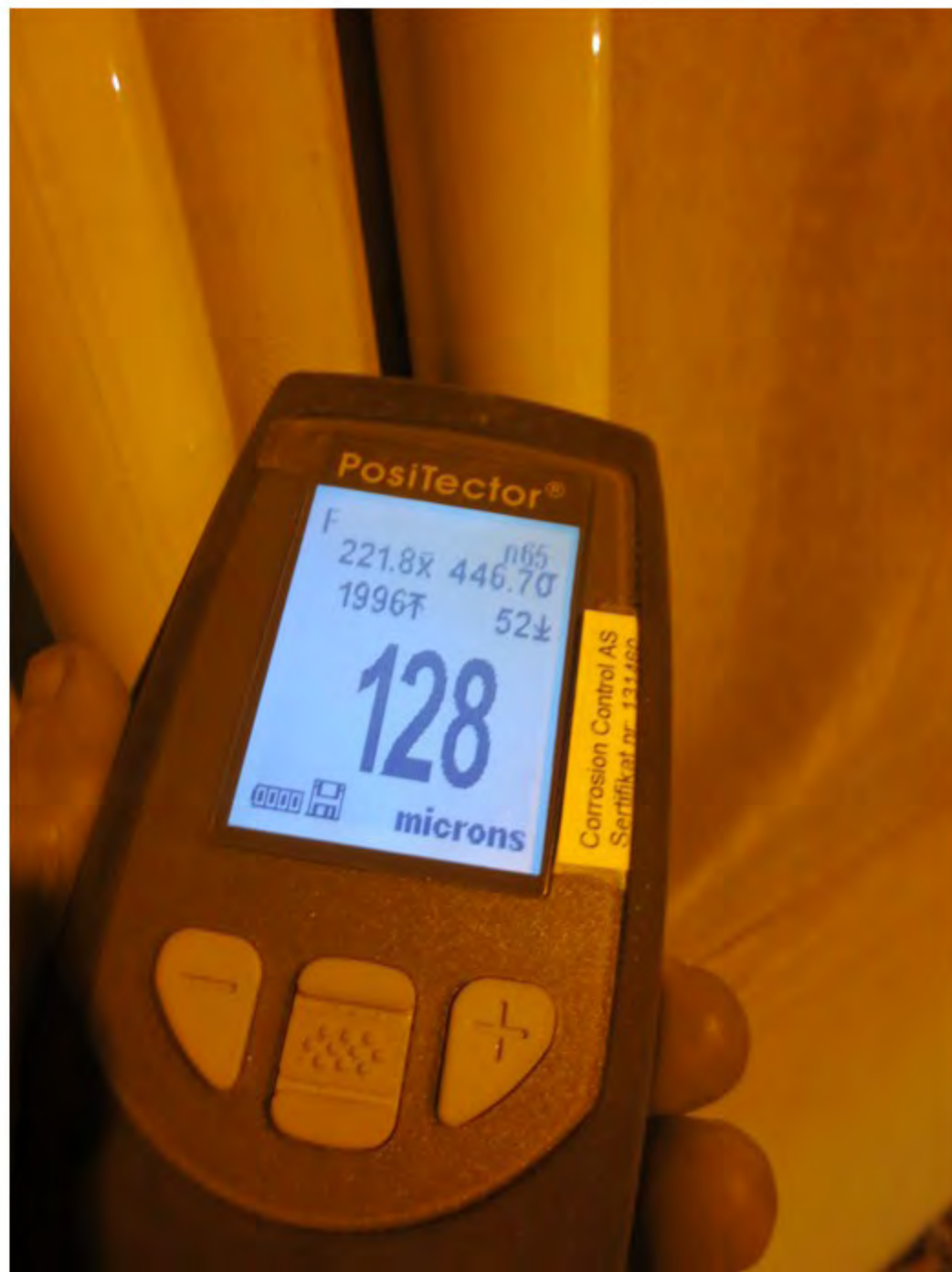
20 Framrør i reparasjonsfelt med Combicoat - Tykkelse belegg 128 my
