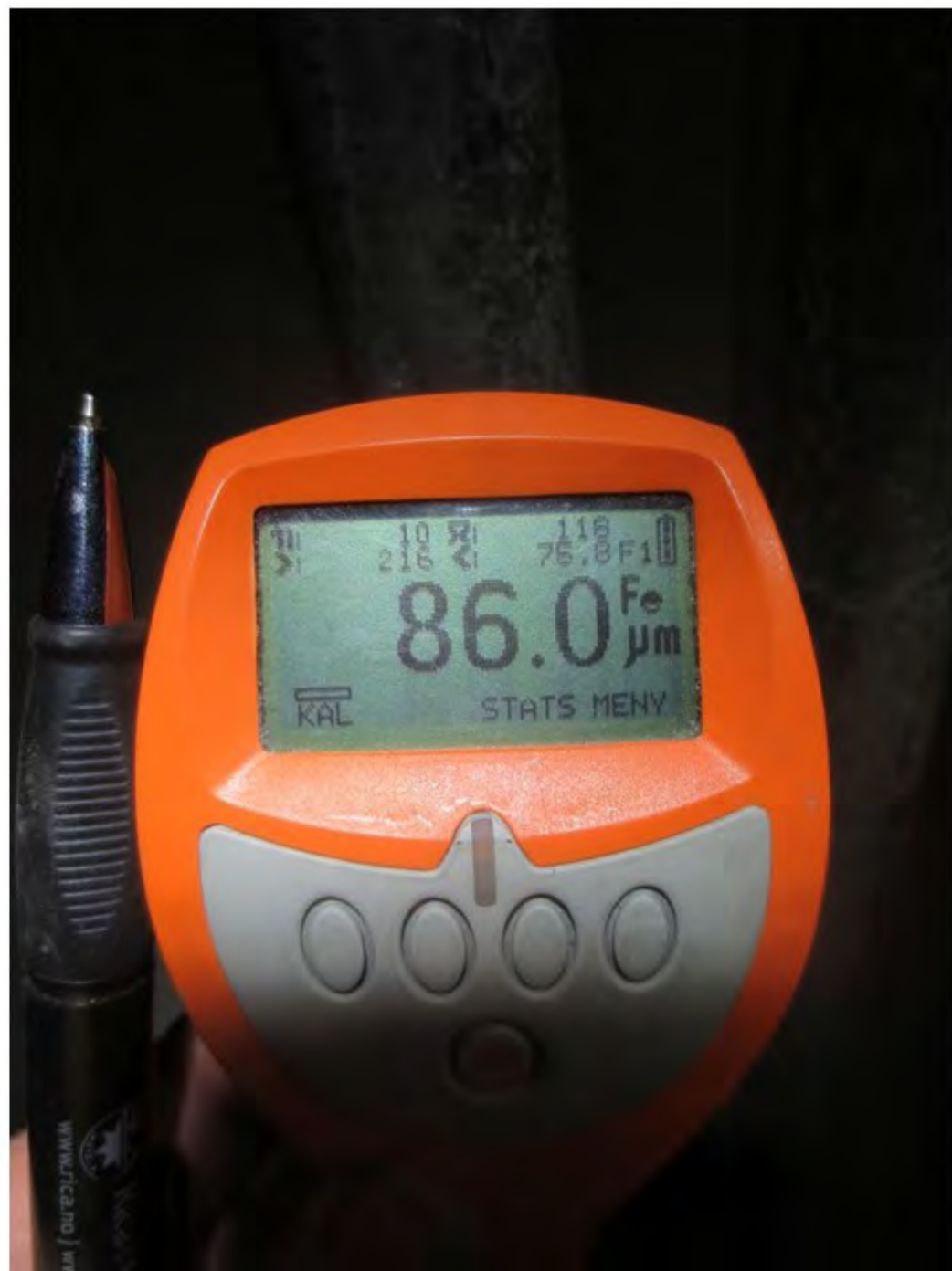
18 Beleggstykkelse på sink på fremrør
