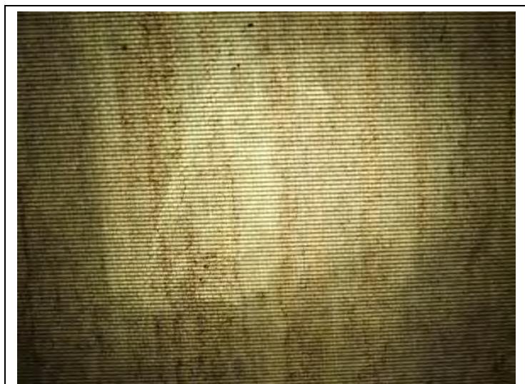
Foto 2.9.16. Gjennomlysning av duk. Homogent materiale uten hull
