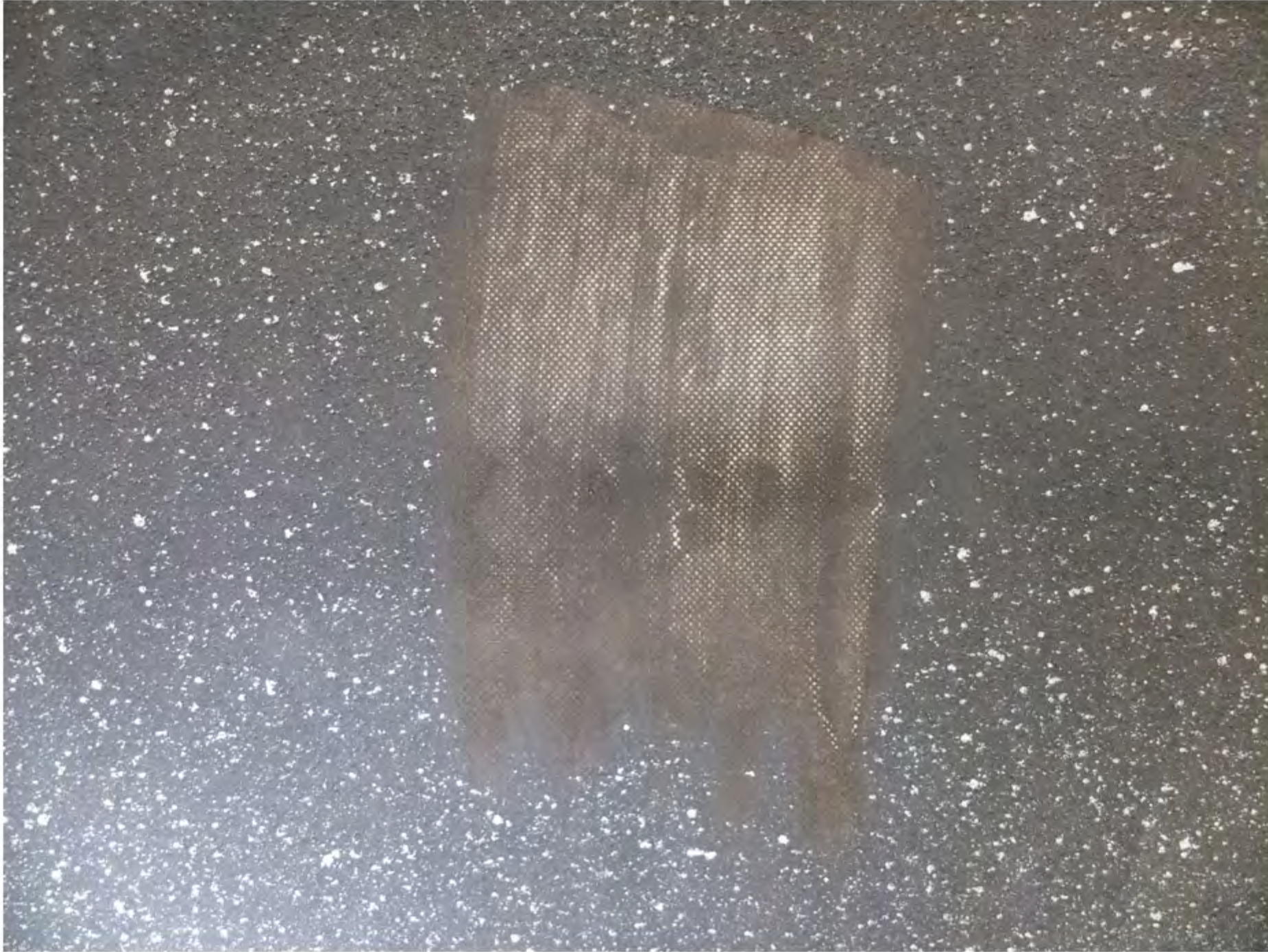
9 Duk er påsprøytet kalkbelegg
