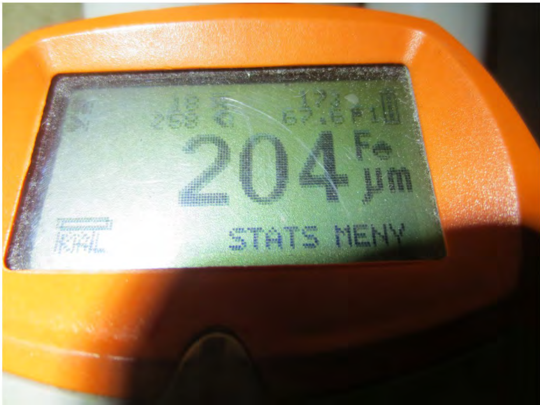
18 Tykkelsesmåling på Combicoat
