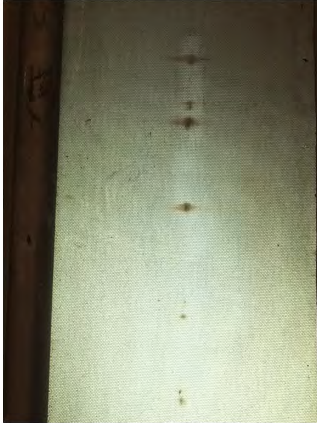
11 Misfargingar inni dukmaterialet i brett
