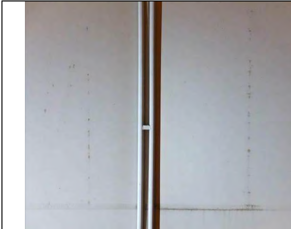
Foto 2.6.5. Misfarging i brett i 556 duk. Fremkom ved gjennomlysning av duken fra baksiden
