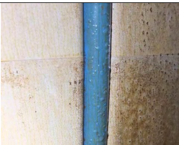
Foto 2.3.10. Blæring i pulverlakk (ferskvannssonen)
