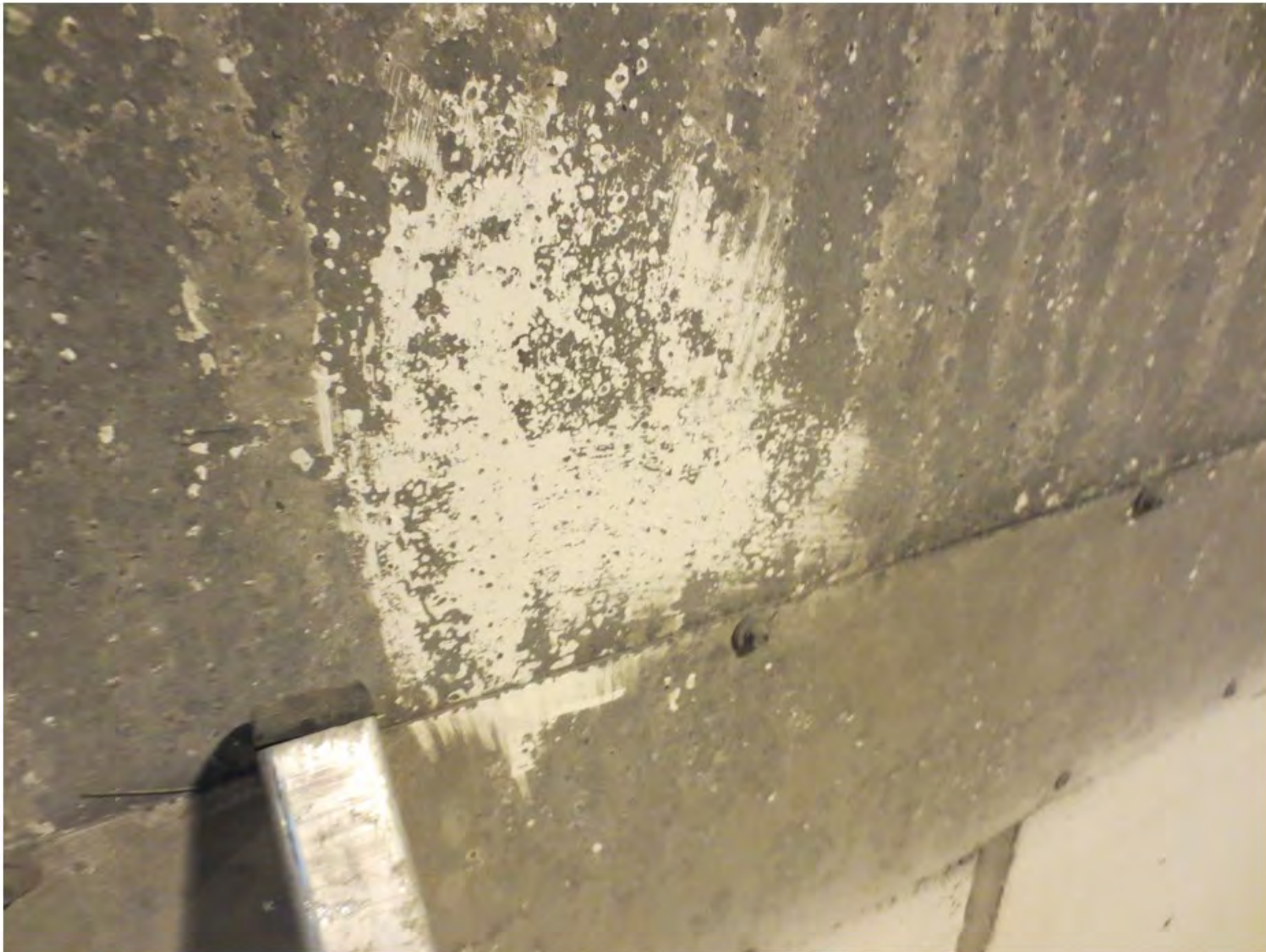
7 Prøvefelt hvor skitt er fjernet ved børsting og bruk av fille
