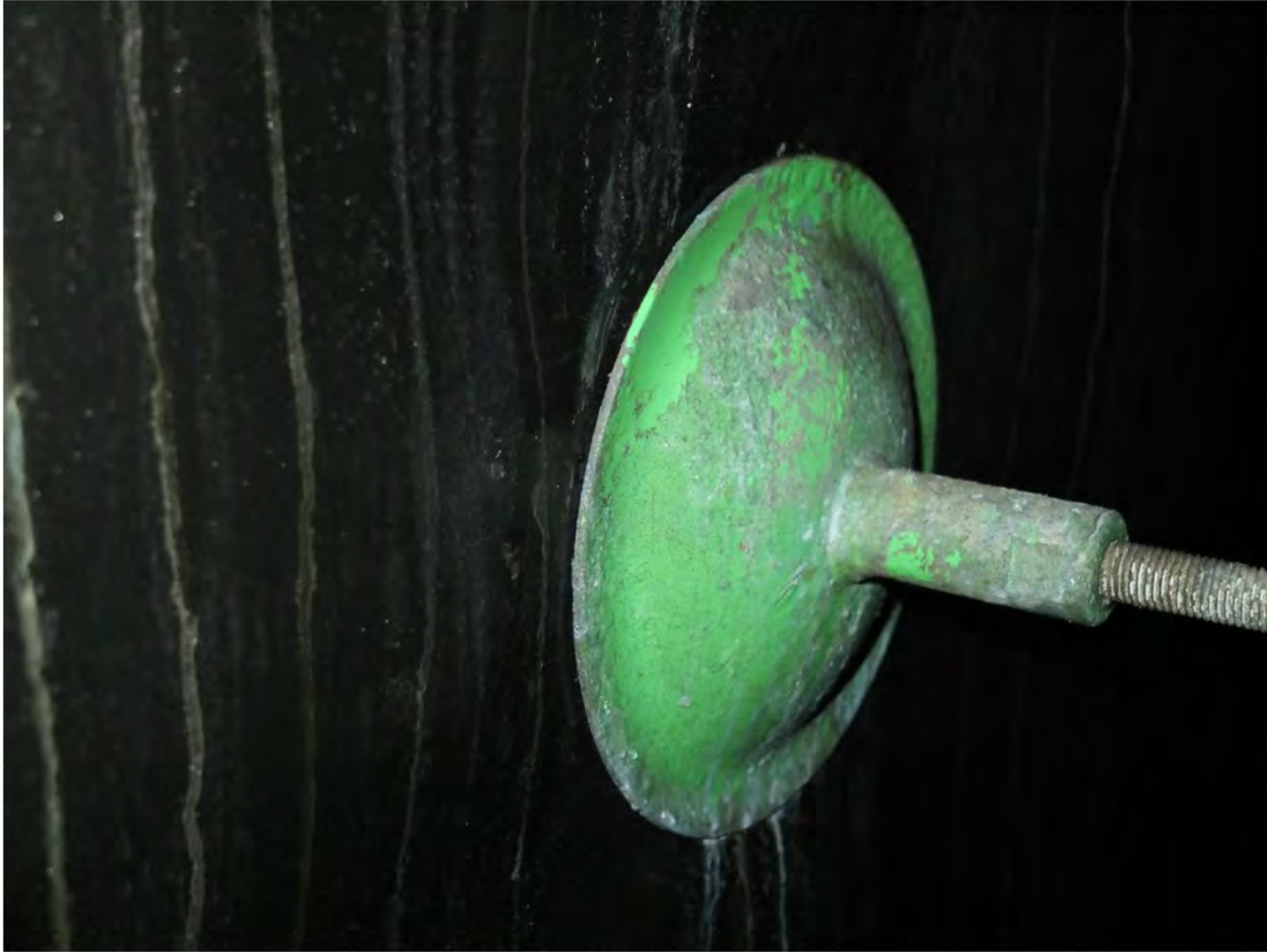
15 Kalkutfelling på duk - Bløring og lakkavskalling på skive
