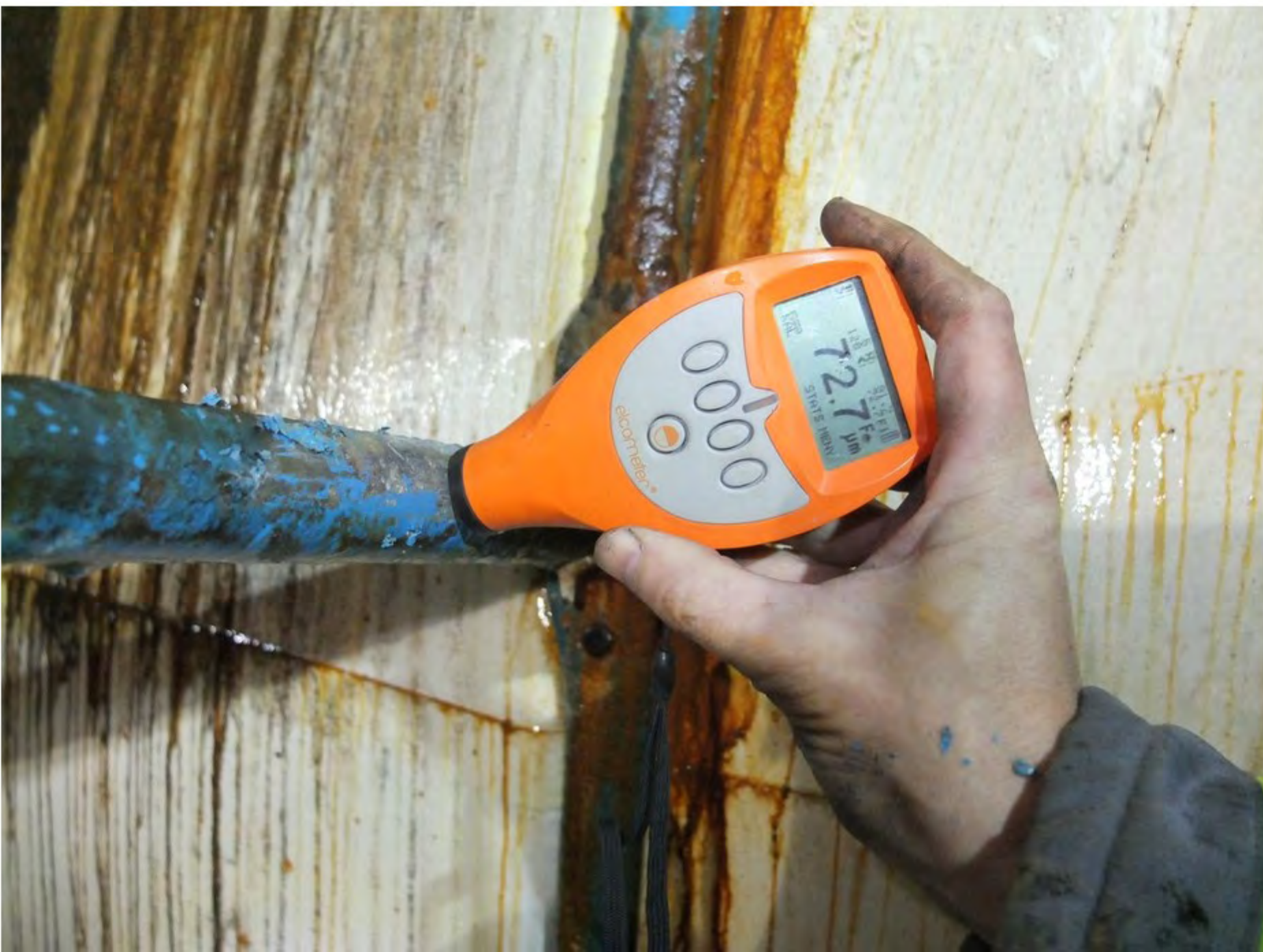
42 Blærende Combicoat fjernet - Måling av sinktykkelse
