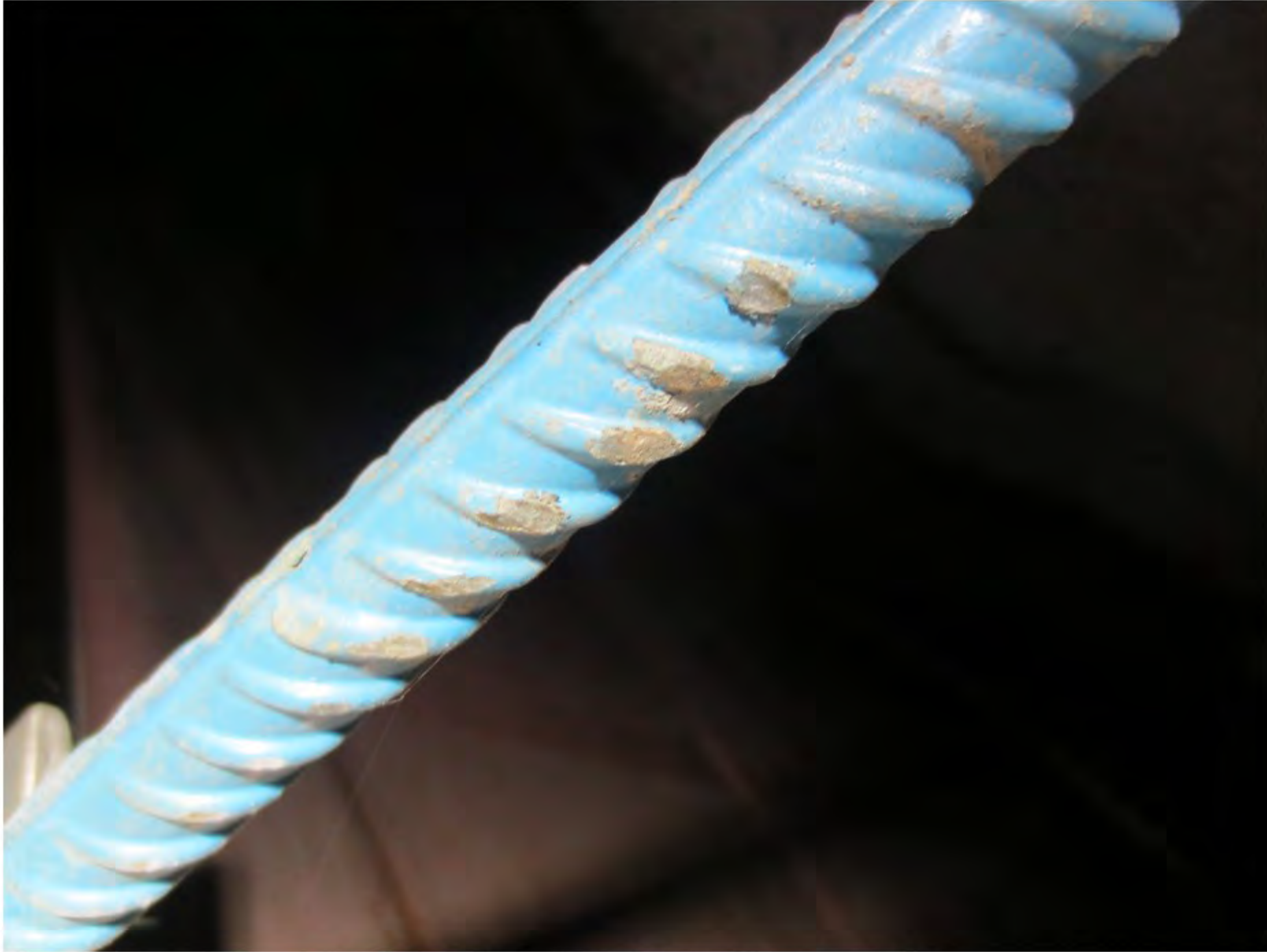
31 Mekanisk skade på overflatebehandlingen på festebolt
