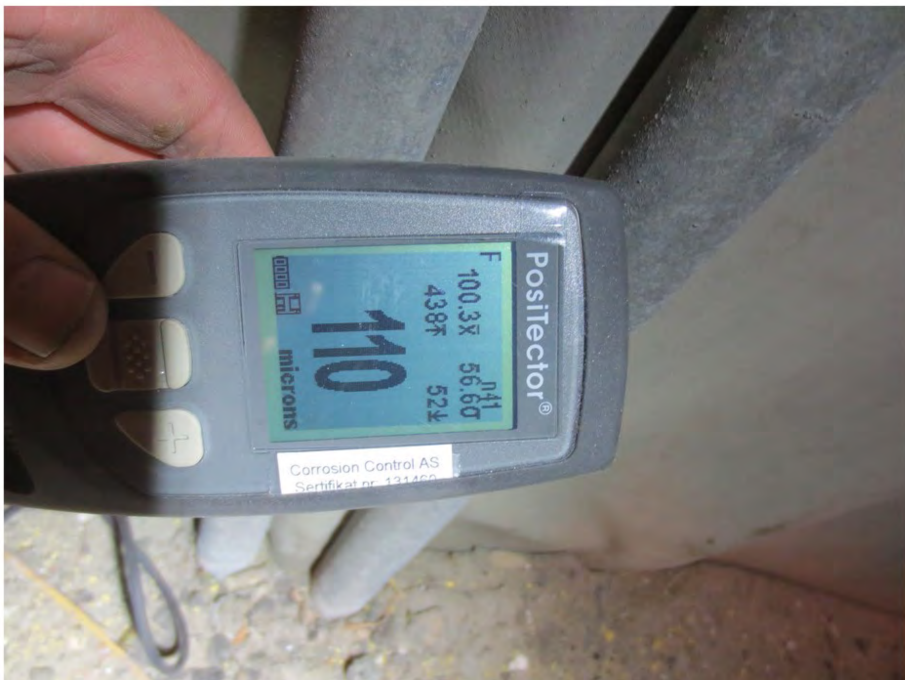
10 Profil 200 Framrør - Tykkelse varmforsinking 110 my
