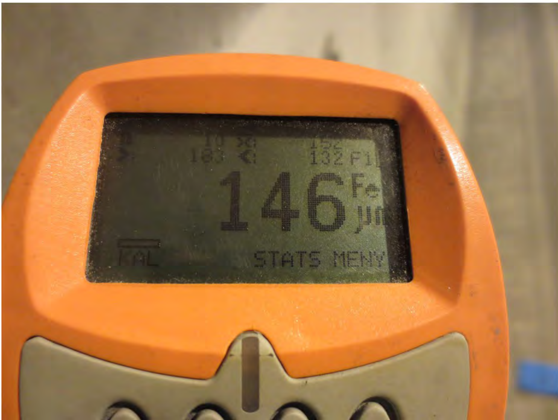
10 Tykkelse av overflatebehandling på prøvelfeltet - 146 my
