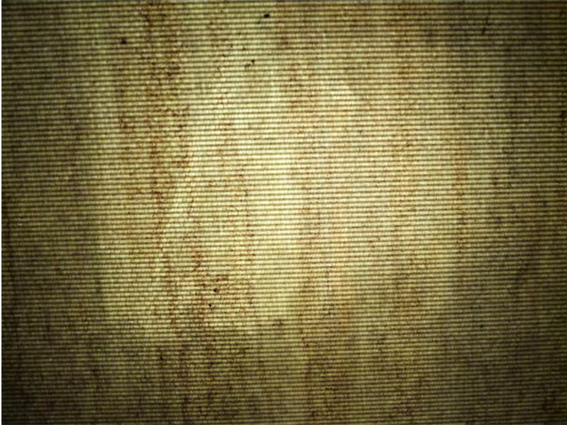
25 Gjennomlysning av duk - Homogent materiale uten hull
