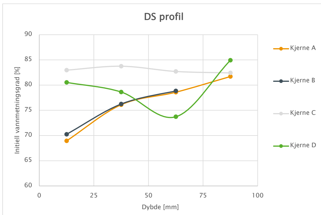
Figur 5-25: Vanmetningsgraden (DS = Degree of saturation) i betongen målt fra overflaten i 25 mm sjikt innover. A og B i le sone, C og D i lo sone.
