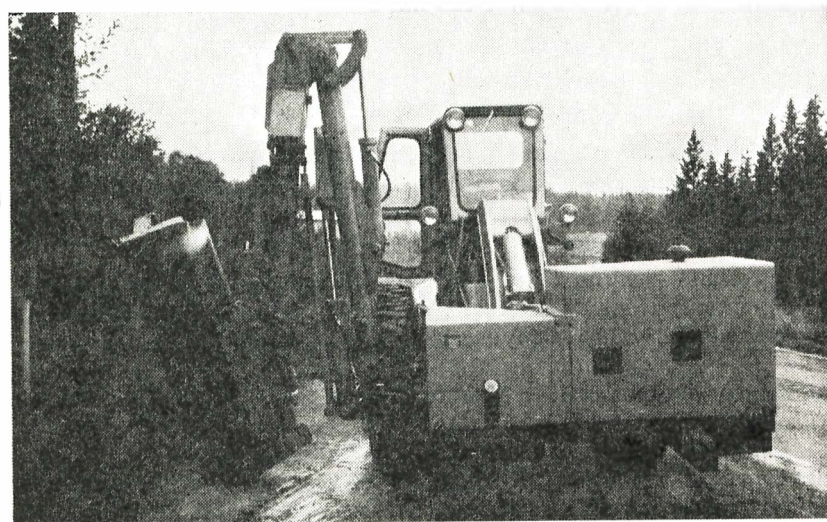
Fig. 2. Klippemaskin med egen driftsmotor for montering i lastearmene på mindre hjullaster.
