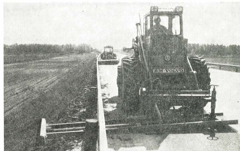
Fig. 4. Dette er en maskin som spesielt egner seg for rensking under vegrekkverkene.
