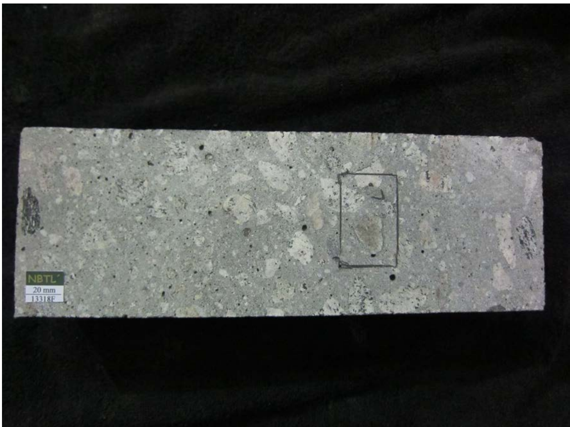
Foto 2: Plassering av tynnslip i prøven.. Utboringssiden er til høyre i bildet
