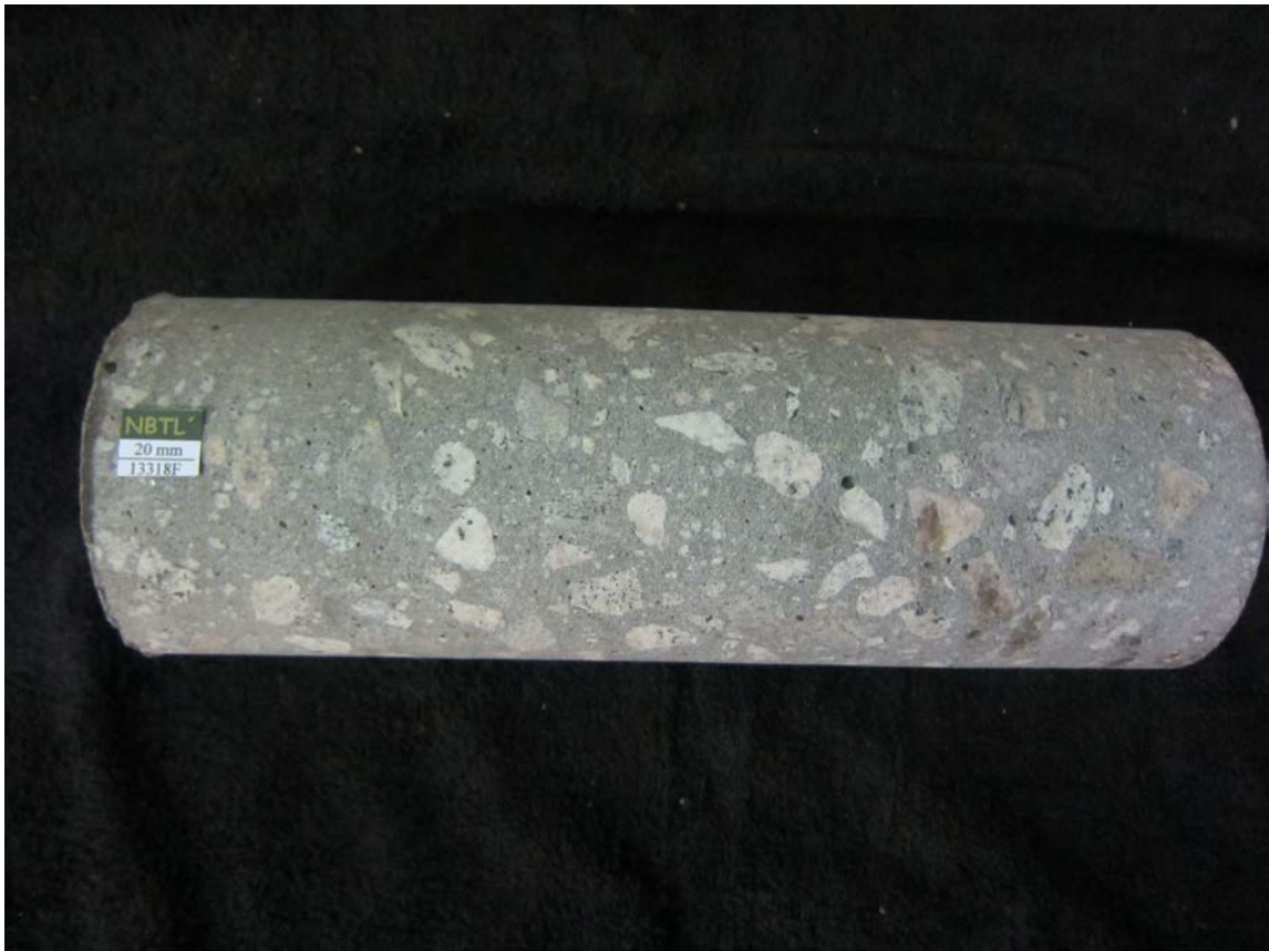
Foto 1: Boreprøven. Utboringssiden er til høyre i bildet
