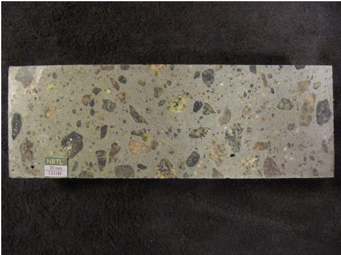
Foto 3: Planslip 13318F. Utboringssiden er til høyre i bildet
