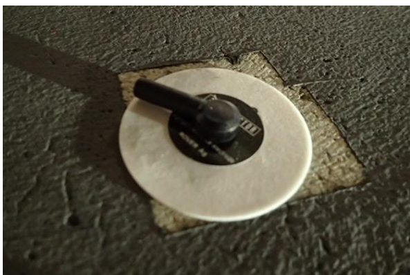
Figur 24 Referanseelektrode av sølv/sølvklorid festet til betongoverflate uten anode
