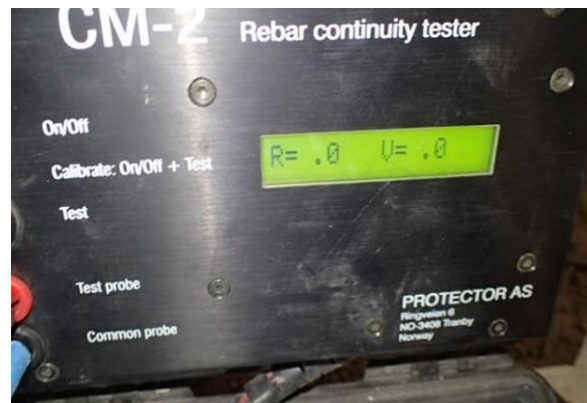
Figur 18 Kontroll av armeringskontinuitet med "CM-2 Rebar Continuity tester". Potensialet mellom punktene har falt umiddelbart til 0V etter påtrykt strømpuls, motstanden er 0 \Omega . Armeringen er i kontinuitet.
