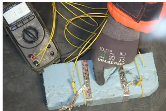
Figur 34 Måling av kvadratmotstand i anoden
