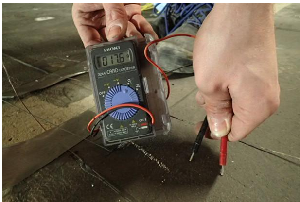
Figur 32 Prinsipp for måling av pin-motstand (i anodemaling)
