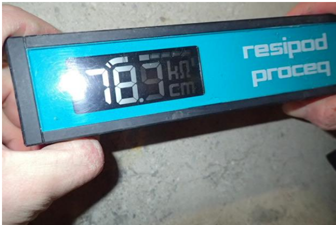
Figur 44 Måling av betongens overflatemotstand ved bruk av "Resipod Proceq" (Wenner)
