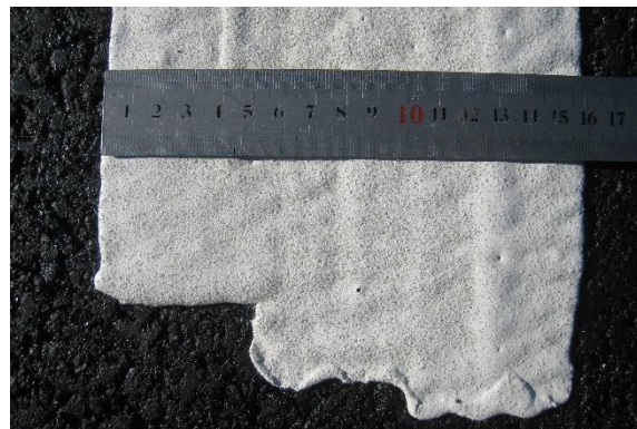
Figur 7.15: Usynkron åpning/lukking av klaffer ved applisering av 15 cm linje
