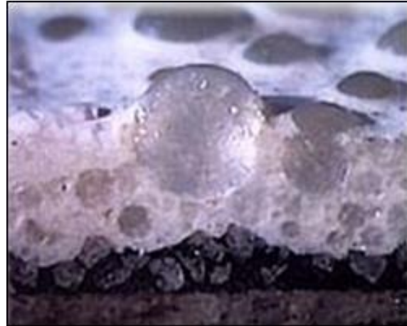
Figur 6.2: I termoplast finnes det også innblandet glass, såkalte premiksperler. Disse bidrar til retrorefleksjon også når linjen er slitt og drop-on-perlene er borte.
