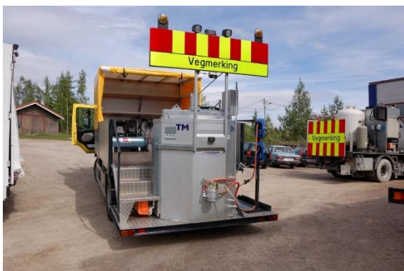
Figur 7.2: Eksempel på håndleggerenhet med smelte-/produksjonsgrYTE
