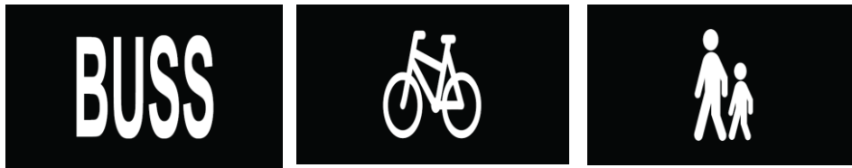
Figur 6.18: Eksempler på tekst og symboler som fortrinnsvis legges med prefabrikkert termoplast (1050.2 BUSS, 1039 Sykkelsymbol og 1037 Gangsymbol)
