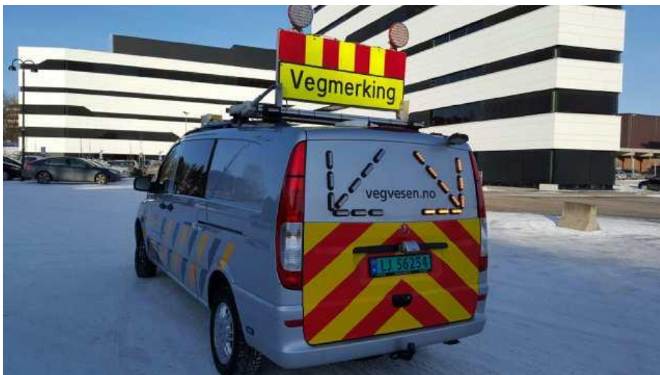
Figur 8.8: Eksempel på bruk av varsling med pilsymbol på formerkebil for å lede trafikken forbi ved stopp
