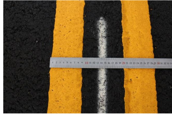
Figur 7.19 Redusert linjebredde fra 10 cm til 9 cm ved åpning av ekstra klaffesett når det appliseres kombinasjonslinjer
