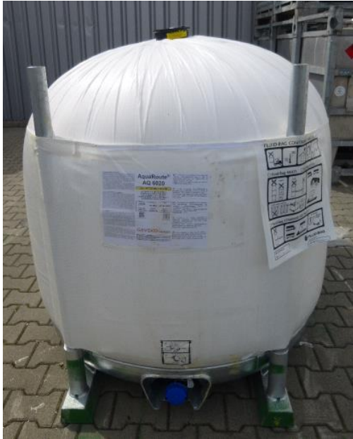
Figur 6.15: Fluidbag med 1.000 liter vannbasert maling
