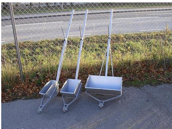
Figur 7.3: Håndleggerskoper for legging av tverrgående oppmerking
