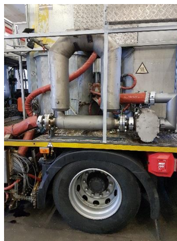
Figur 10.3: Automatisert mengdekontroll for dokumentasjon av materialforbruk under produksjon på veg. Utvikling i regi av Trysil maskin/Statens vegvesen Region sør.
