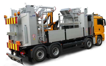
Figur 7.7: Separat smelteenhet for termoplast med 4 gryter
