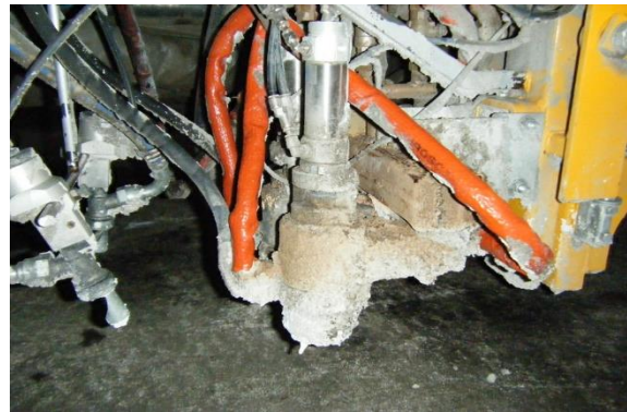
Figur 7.12: Spraypistol på utleggerenhet, og glasspistol til venstre på bildet
