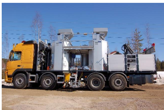
Figur 7.8: Kombinert smelte- og produksjonsenhet for termoplast med 4 gryter; 2 smeltegryter og 2 produksjonsgryter
