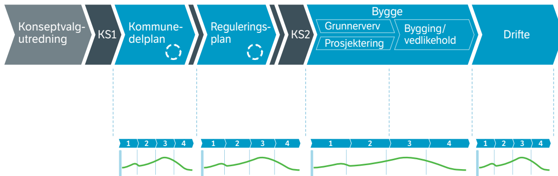
Figur 7: Tradisjonell definering av prosjekt for større vegprosjekter. Hver enkelt fase gjennomføres som et prosjekt
