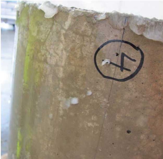
Nærfoto av stor sylinde etter utjevning av impregneringen. Merk blank overflate
