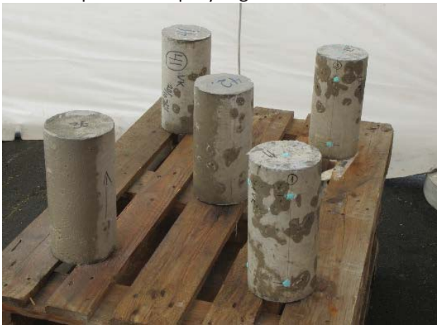
Ved oppstart sprøyting siste 5 små sylindre (mrk 11, 12, 36, 41 og 42) oppsto problemer med sprøyteutstyr og det ble et avbrekk i påføring.
