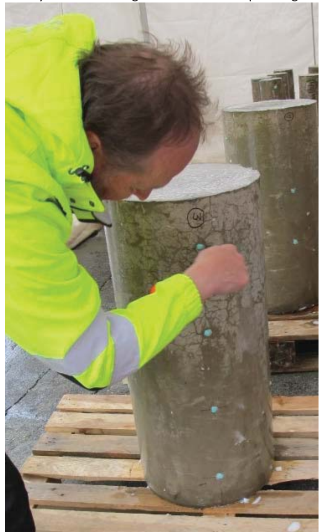
Etterpensling/utjevning av impregnering på stor sylindre, ca 50 minutter etter påføring
