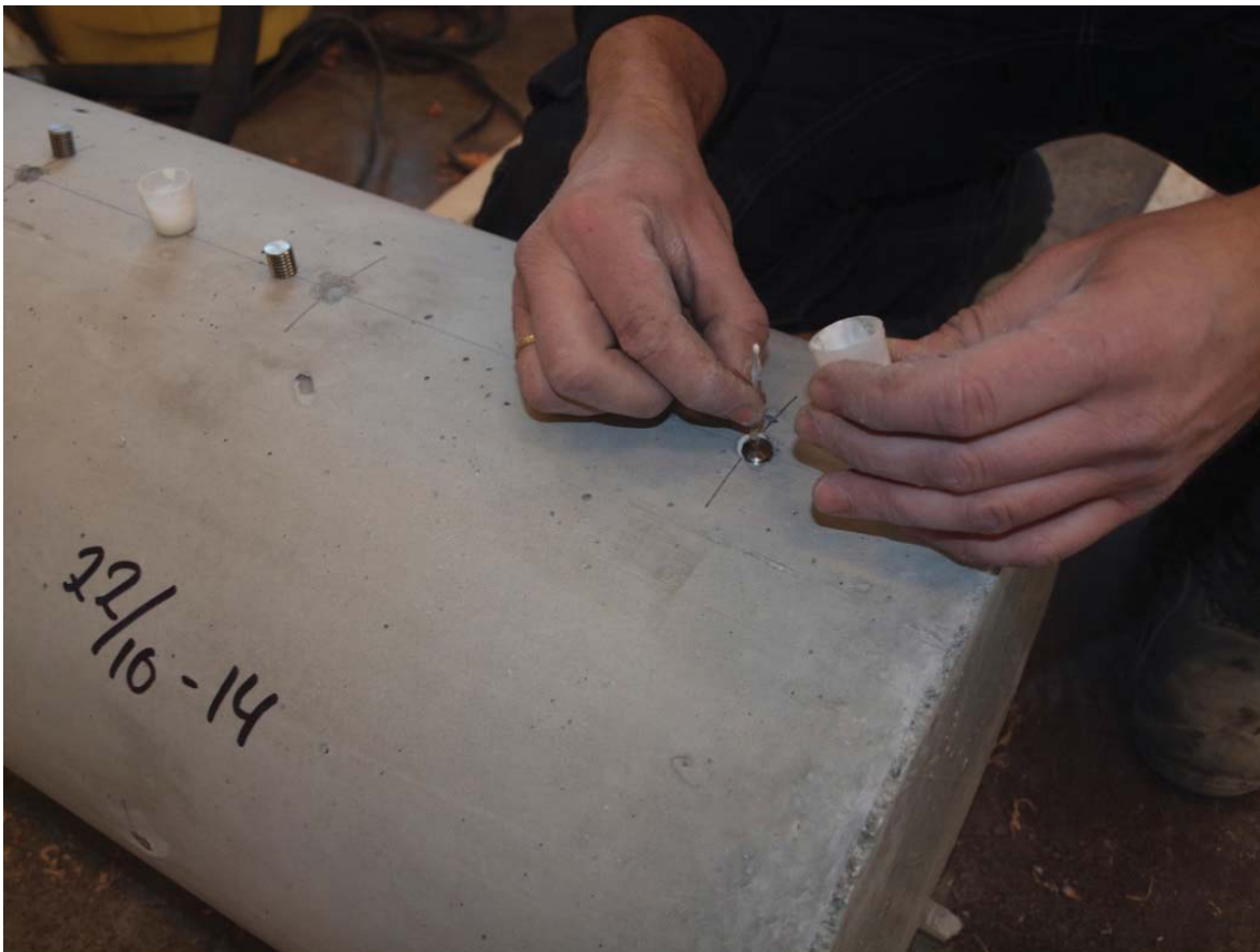
Figur 2 Montering av måleknaster
