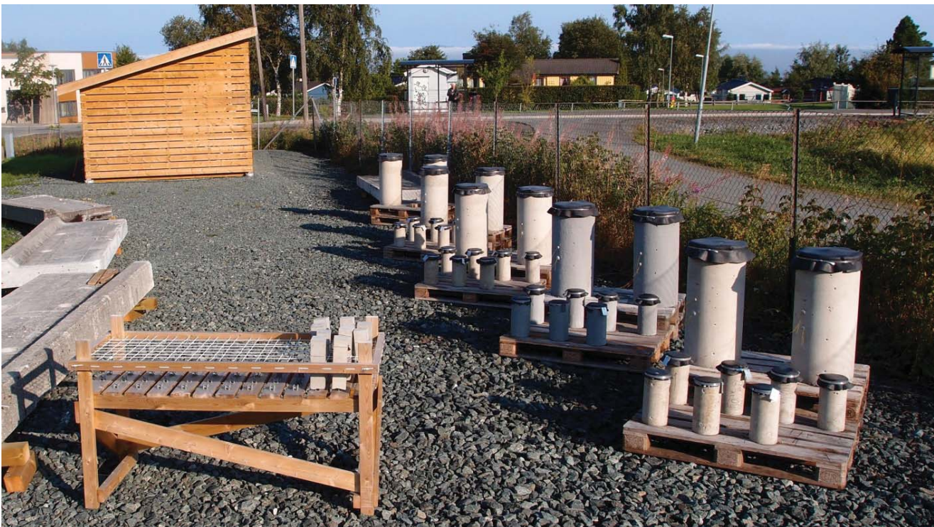
Figur 11 Prøver etter montering av "gummihatter" (skur for beskyttet eksponering ses øverst på venstre side)
