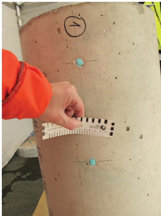
Ubehandlet overflate, stor sylinder. Rissvidde målt til 0,075 mm, se etterfølgende nærfoto
