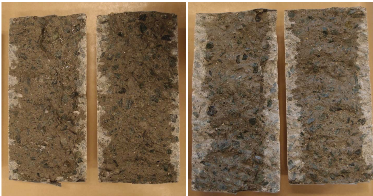
Figur 9 Måling av inntrengingsdybde (Sikagard 706 Thixo til venstre og StoCryl HG 200 til høyre)
