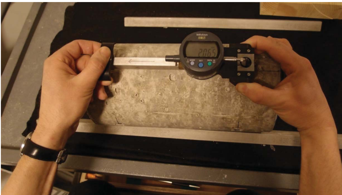
Figur 3 Lengdemåling med Demec ekstensiometer
