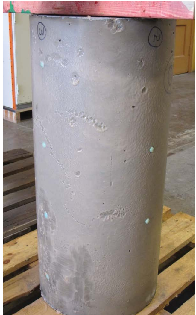
Stor sylinder ferdig sprøytet, på K-lab
