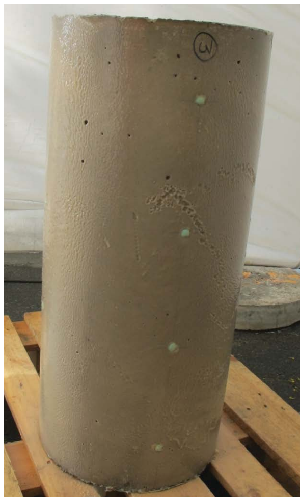
Ferdig sprøytet stor sylinder
