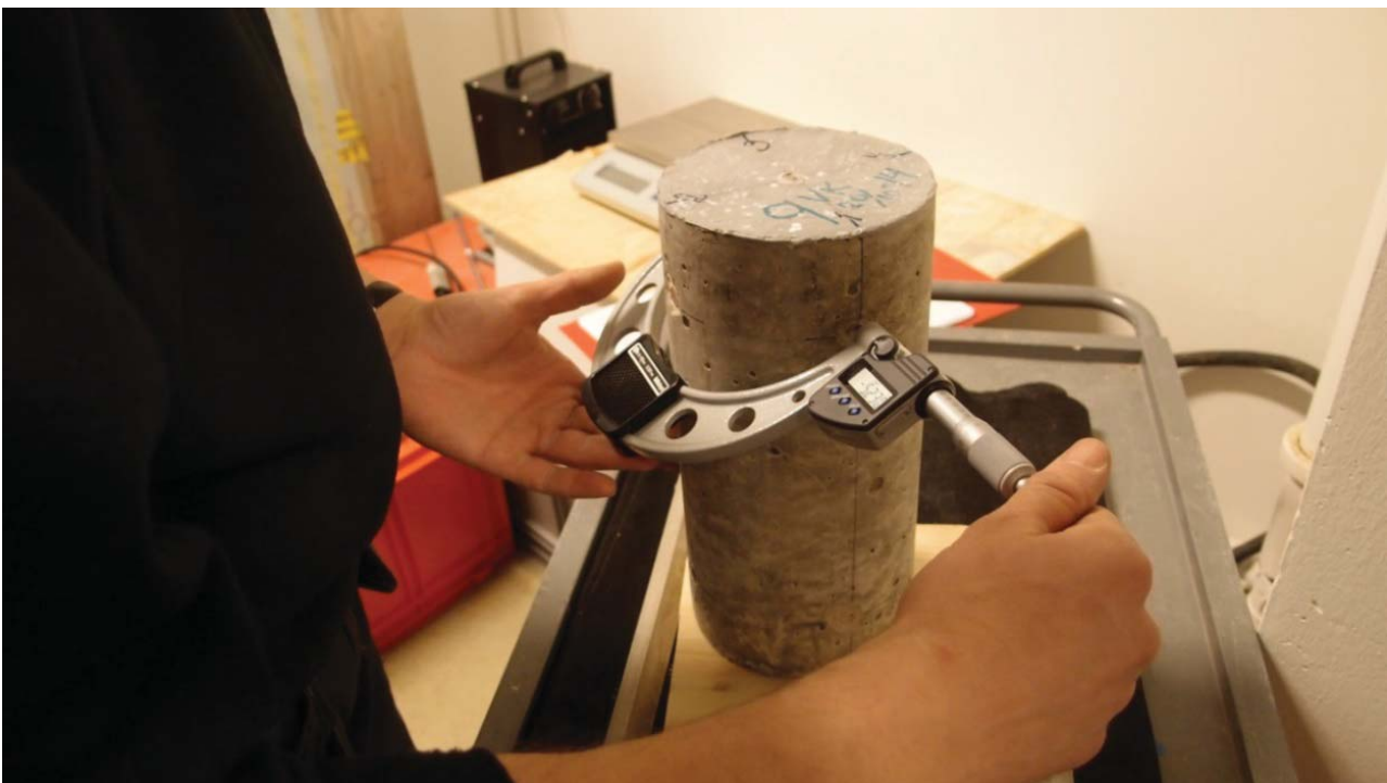
Figur 5 Måling av diameter med lite (150 mm) Mitutoyo mikrometer
