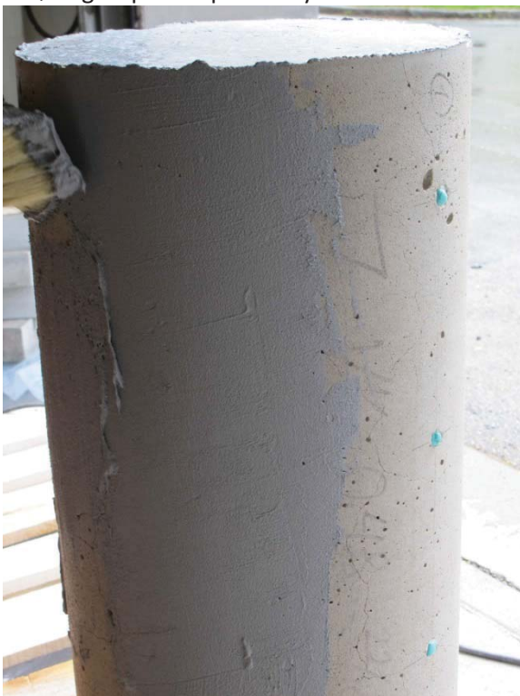
Porefylling, påføring med kost og avtrekking med sparkel, stor sylinder
