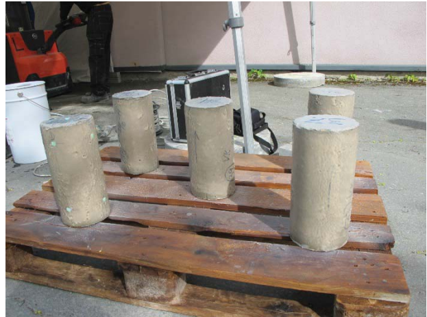
5 første små sylindre (mrk 10, 37, 38, 39, 40) ferdig sprøytet
