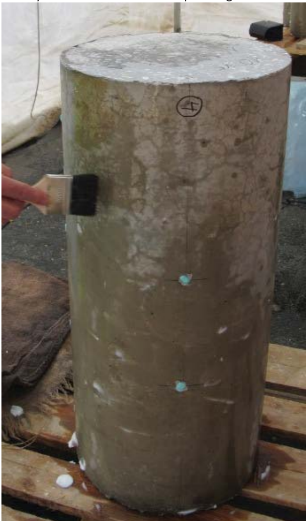
Etterpensling/utjevning av impregnering på stor sylindre, ca 50 minutter etter påføring
