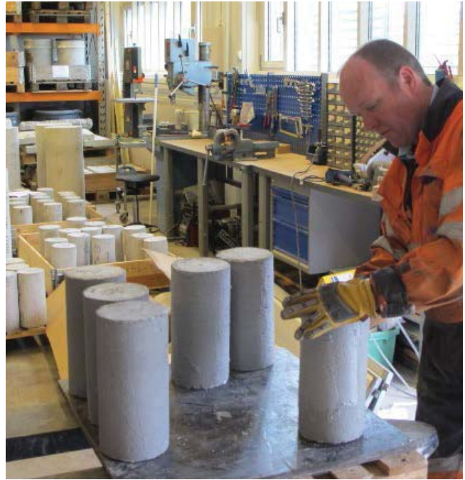
Påføring 1. strøk små sylindre
