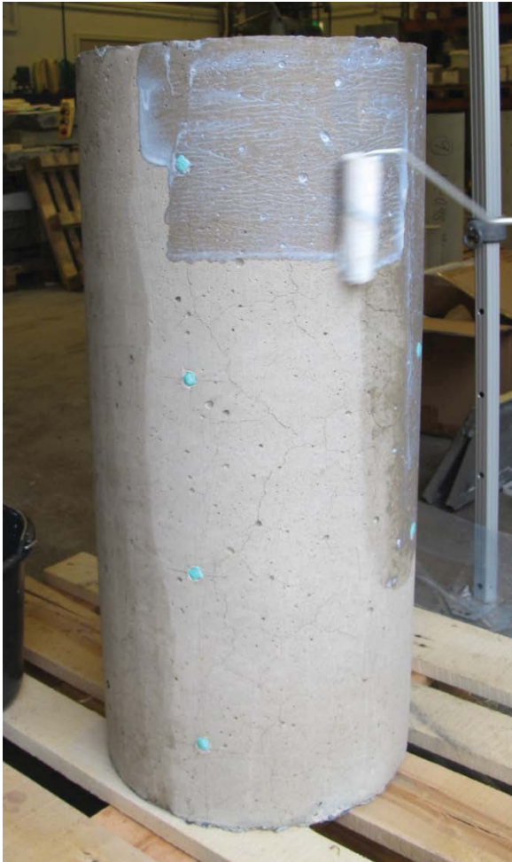
Påføring av primer på stor sylinder
