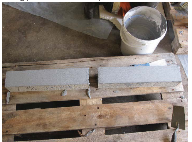
Ferdig påført 2. strøk prismer
