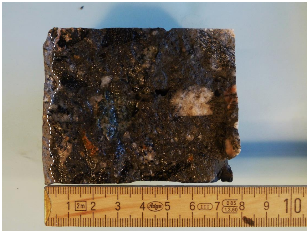
Kerne 1-S-2 – Til venstre ses den eksponerede overflade, mod højre ses den fræsede overflade. Den imprægnerede del (de yderste 3-5 mm fra venstre) fremstår lysere end den øvrige del af kernen.
