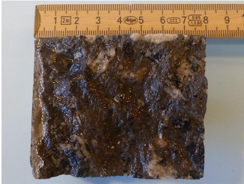
Kerne 3-S-3 – Til venstre ses den eksponerede overflade, mod højre ses den fræ- sede overflade. Den imprægnerede del (de yderste 3-5 mm fra venstre) fremstår lysere end den øvrige del af kernen.
