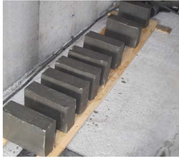
Figur 38 Ferdig impregnert - 1-S til høyre, 8-S til venstre (nærmest)
