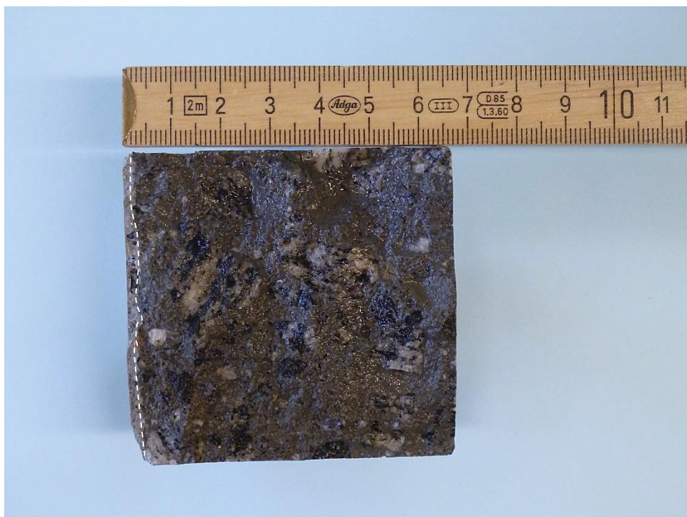
Kerne 8-S-4 – Til venstre ses den eksponerede overflade, mod højre ses den fræ- sede overflade. Den imprægnerede del (de yderste mm fra venstre) fremstår lysere end den øvrige del af kernen.
