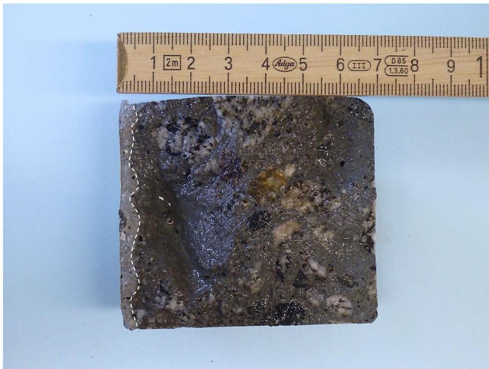
Kerne 3-S-4 – Til venstre ses den eksponerede overflade, mod højre ses den fræ- sede overflade. Den imprægnerede del (de yderste mm fra venstre) fremstår lysere end den øvrige del af kernen.
