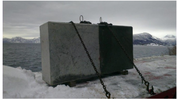
Figur 44 Transport av stort element fra Skorgeneset 9/12-13. Flate A: StoCryl HG 200 til venstre, ubehandlet til høyre (foto: Martin Gedra)
