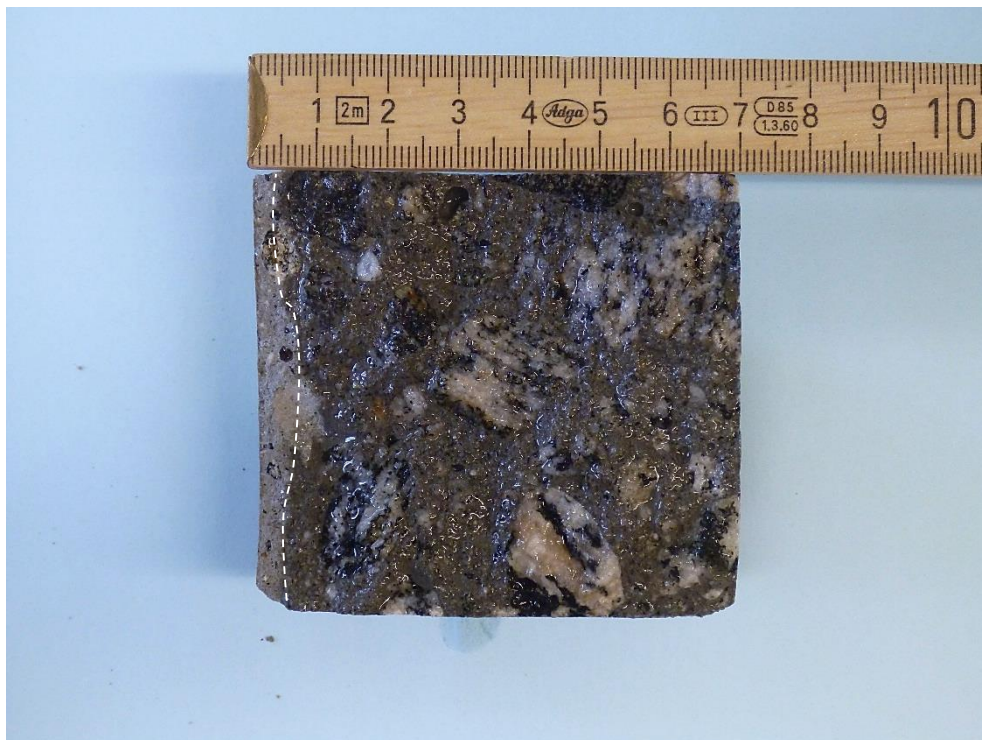
Kerne 7-S-4 – Til venstre ses den eksponerede overflade, mod højre ses den fræ- sede overflade. Den imprægnerede del (de yderste mm fra venstre) fremstår lysere end den øvrige del af kernen.
