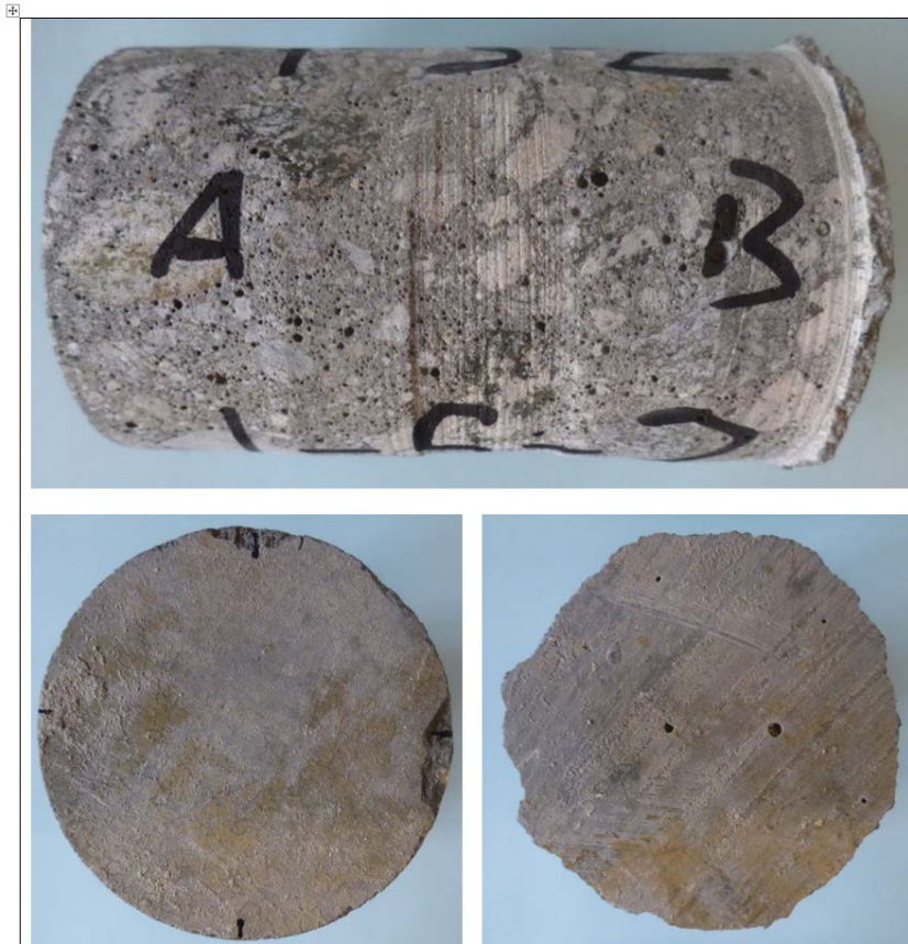
Figur 59 Eksempel på kjerne med hydrofoberende impregnering - kjerne 1-S-2 (foto: Cowi)
