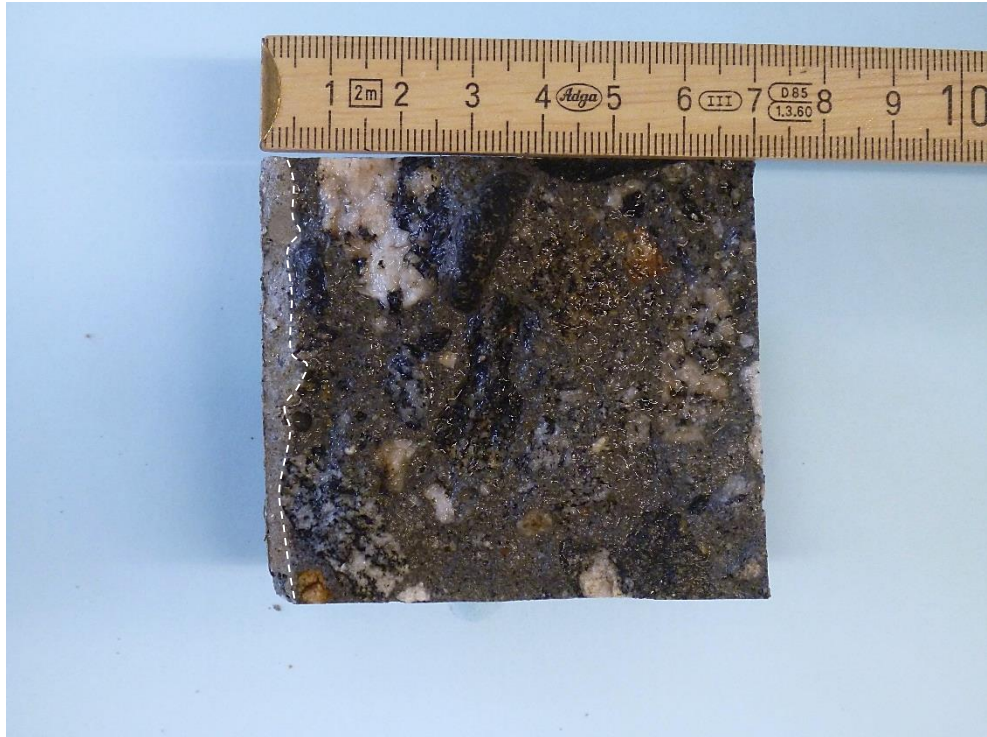
Kerne 5-S-4 – Til venstre ses den eksponerede overflade, mod højre ses den fræsede overflade. Den imprægnerede del (de yderste mm fra venstre) fremstår lysere end den øvrige del af kernen.
