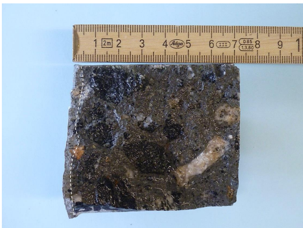
Kerne 2-S-3 – Til venstre ses den eksponerede overflade, mod højre ses den fræ- sede overflade. Den imprægnerede del (de yderste mm fra venstre) fremstår lysere end den øvrige del af kernen.
