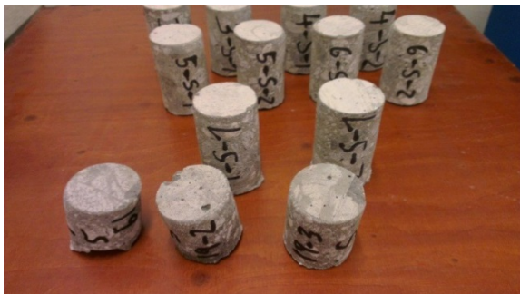
Figur 54 Kjerner boret ut fra stort element (fremst), 1-S-1 og 2-S-1, 5-S-1/2 og 6-S-1/2 og 3-S-1/2 og 4-S-1/2 (foto: Martin Gedra)
