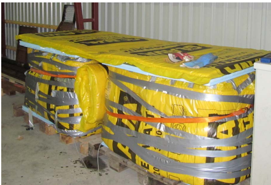
Figur 12 Eksponeringskar med lokk, utvendig isolert
