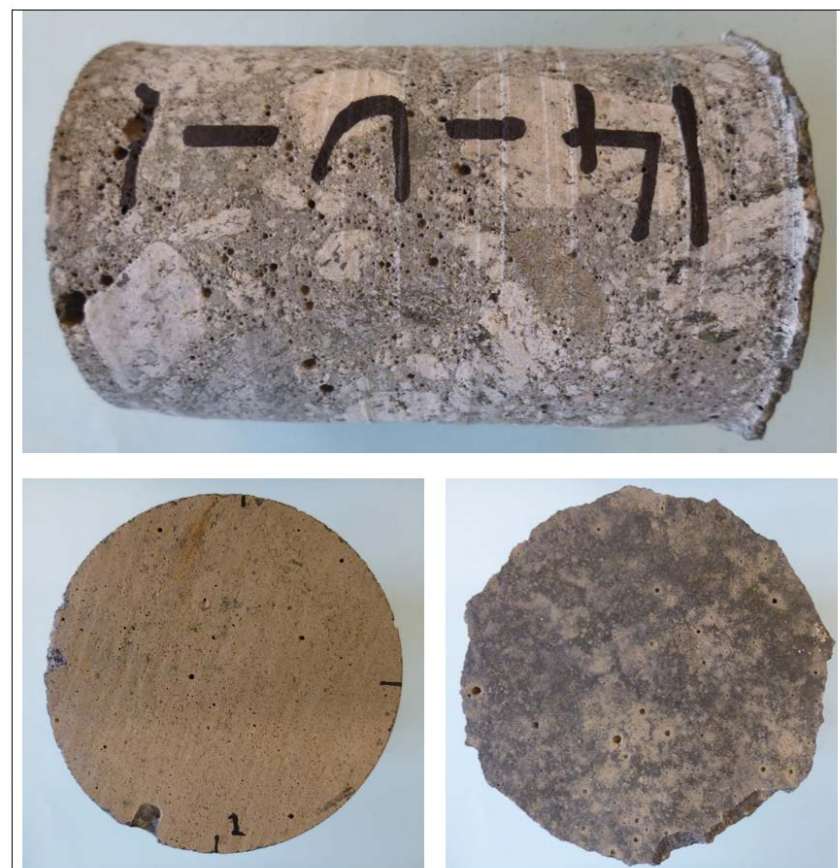
Figur 60 Eksempel på kjerne uten StoCryl HG 200 - kjerne 14-U-1 (foto: Cowi)
