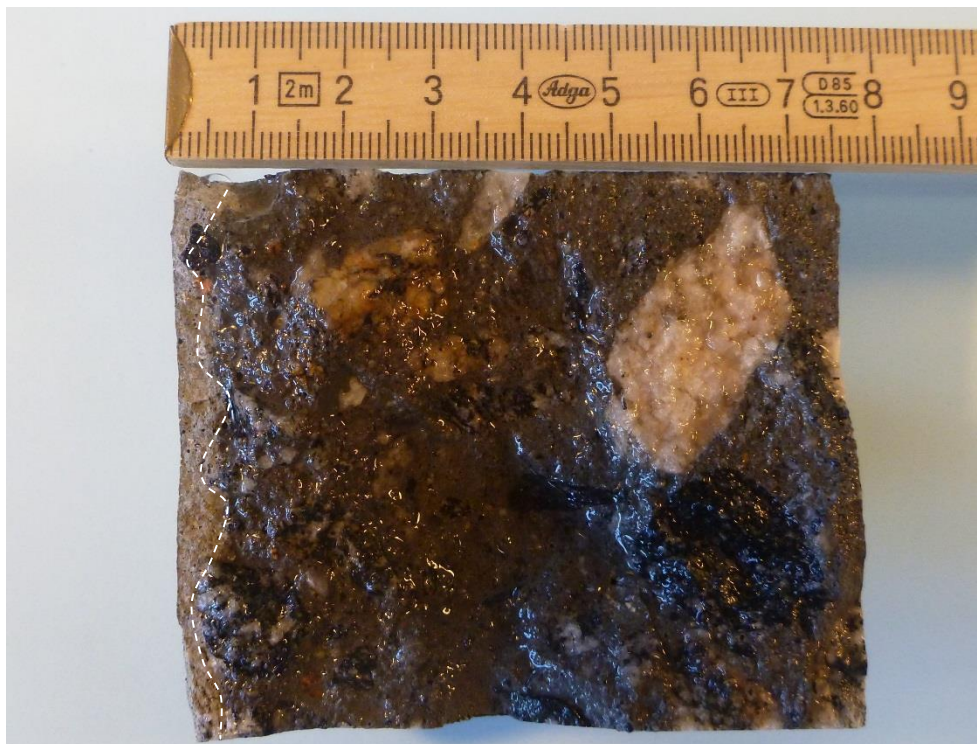
Kerne 5-S-3 – Til venstre ses den eksponerede overflade, mod højre ses den fræsede overflade. Den imprægnerede del (de yderste 3-5 mm fra venstre) fremstår lysere end den øvrige del af kernen.
