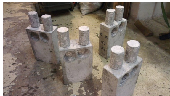
Figur 51 Små elementer (3-S, 4-S, 5-S og 6-S) med StoCryl HG 200. Kjerner boret ut for bestemmelse av inntrengingsdybde (foto: Martin Gedra)
