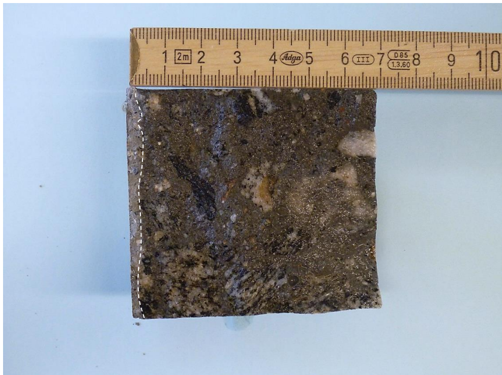
Kerne 6-S-4 – Til venstre ses den eksponerede overflade, mod højre ses den fræsede overflade. Den imprægnerede del (de yderste mm fra venstre) fremstår lysere end den øvrige del af kernen.
