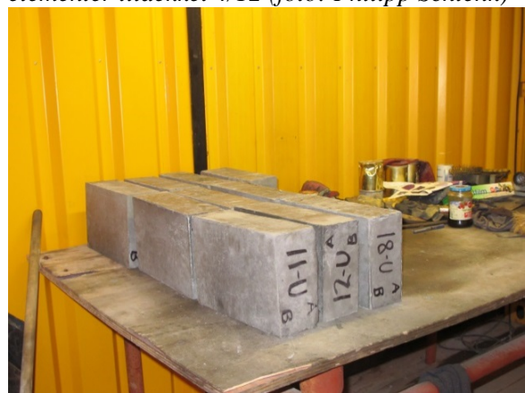
Figur 42 Lagring av referanselementer, uoppvarmet bod utenfor anleggslaboratoriet
