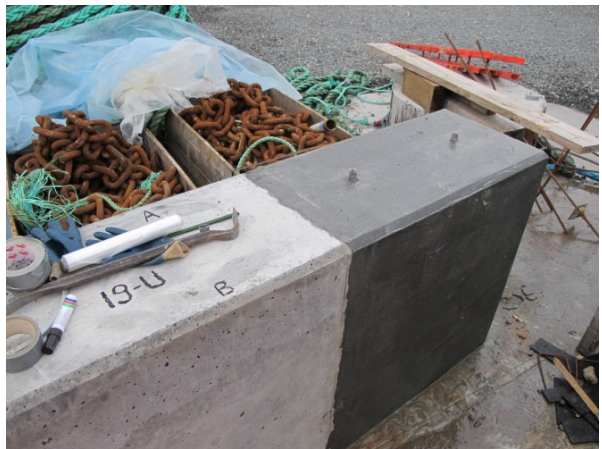
Figur 26 Merking av flate A og B. Merk: Impregneringen suges noen mm inn i ubehandlet referansedel.
