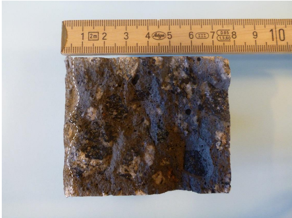
Kerne 7-S-3 – Til venstre ses den eksponerede overflade, mod højre ses den fræ- sede overflade. Den imprægnerede del (de yderste 3-5 mm fra venstre) fremstår lysere end den øvrige del af kernen.
