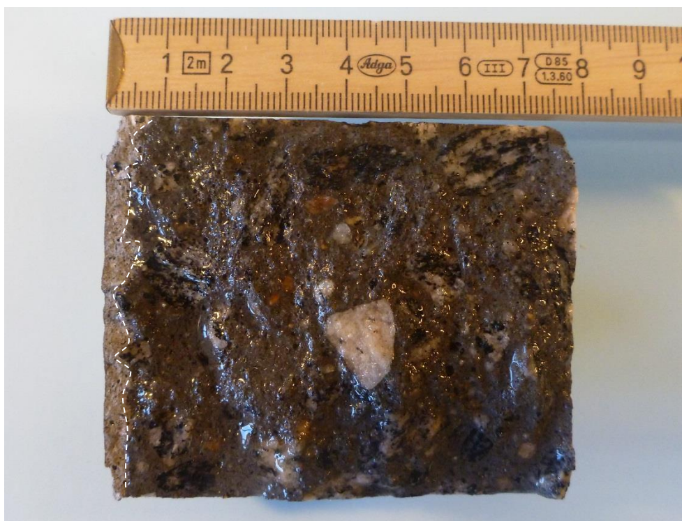
Kerne 6-S-3 – Til venstre ses den eksponerede overflade, mod højre ses den fræsede overflade. Den imprægnerede del (de yderste 3-5 mm fra venstre) fremstår lysere end den øvrige del af kernen.
