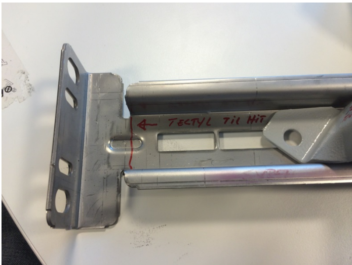
Den syrefaste kabelbrutraversen tectylbehandles også
