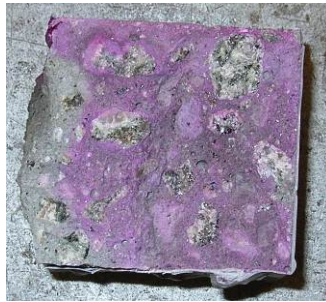
Foto nr 2. Den impregnerte flaten er øverst på bildet. Karbonatiseringsdybden er lik 0.
