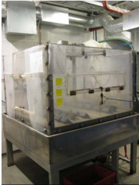
Figur 1 Saltpåsprøytingskammeret (saltkammeret) i SVV Sentrallaboratoriet
