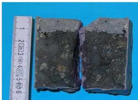
Foto nr 1. Foto av impregnert betong. Den impregnerte sonen er lysegrå, mens den ikke-impregnerte betongen er mørkere.
