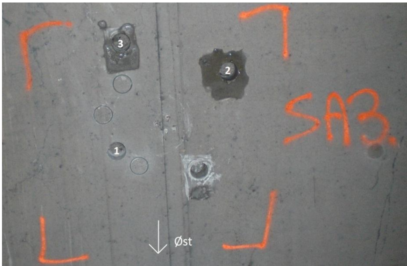
Figur 12 Nummerering av kjerner tatt ut fra prøvelokasjon SA3
