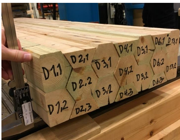
Figur 4.15: Måling av gliper mellom opplegg og dekket
