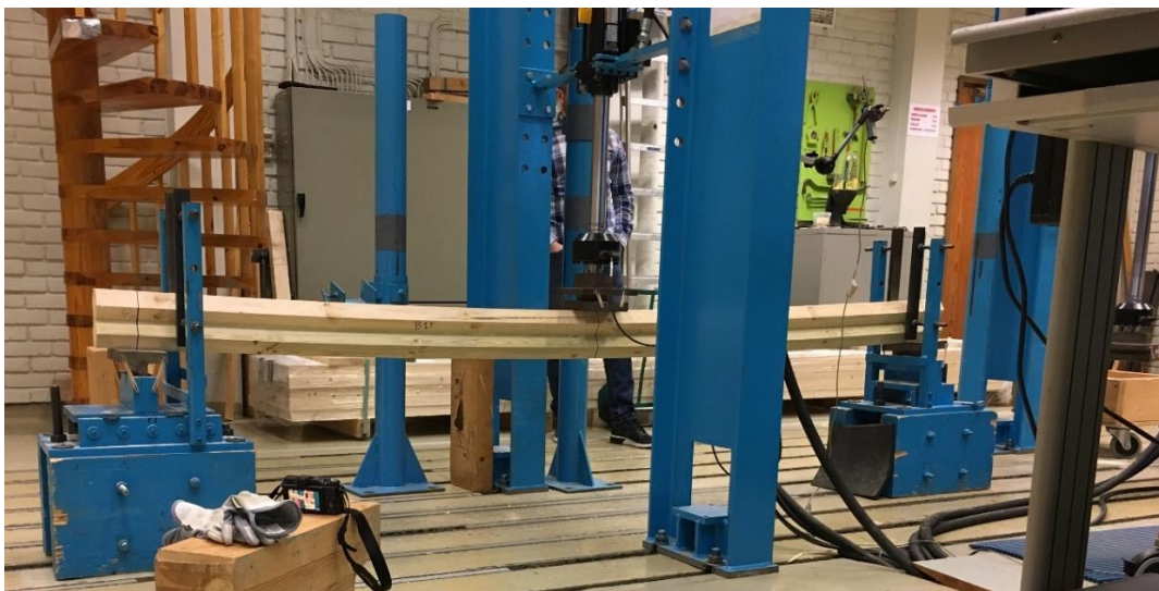
Figur 3.6: Oppsett under laboratorietesting av bjelkene
