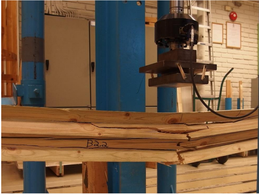
Figur 4.12: Typisk brudd i enkeltbjelker
