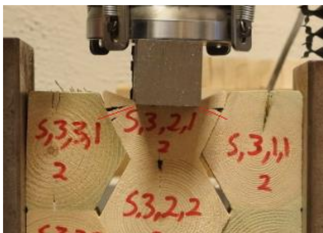
Figur 4.5: Strekkbrudd rulleskjærttest av bjelketype to
