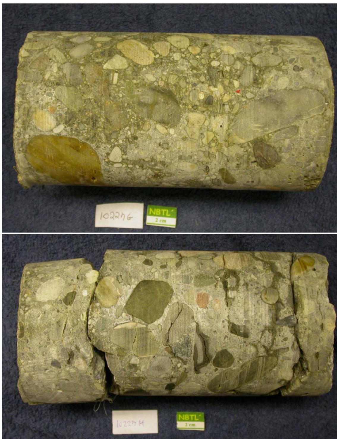
Figur 7.19: Kjerner fra over og under rigel, akse 19S
