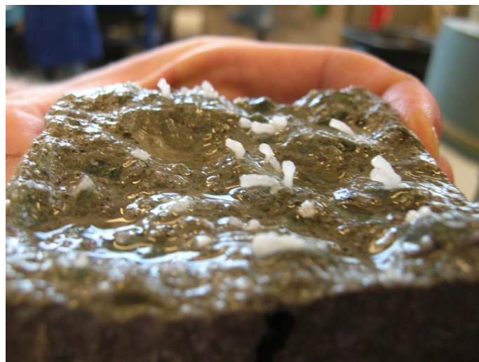
Figur 5.5: Reaksjonsprodukt fra ASR [26]
