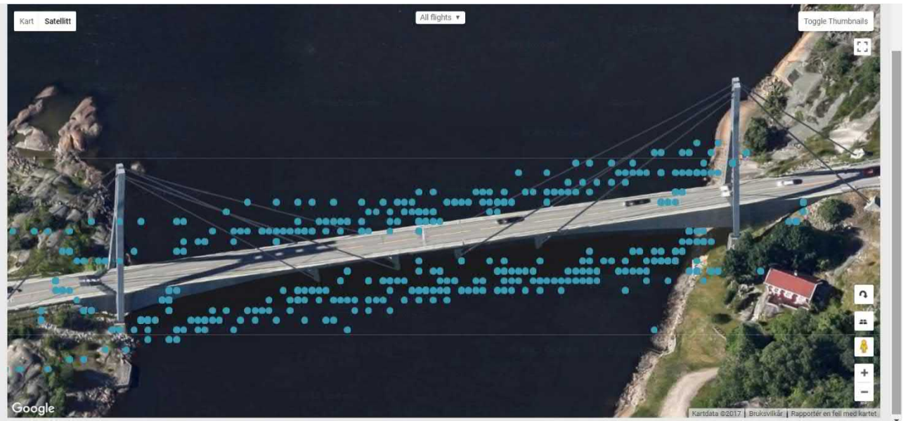
Foto 31. GPS- posisjonene til dronen inntegnet når bildene er tatt på Puttesund bru.
