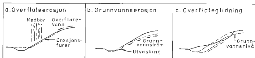
Figur 1. Typer av skråningsskader i jord.
