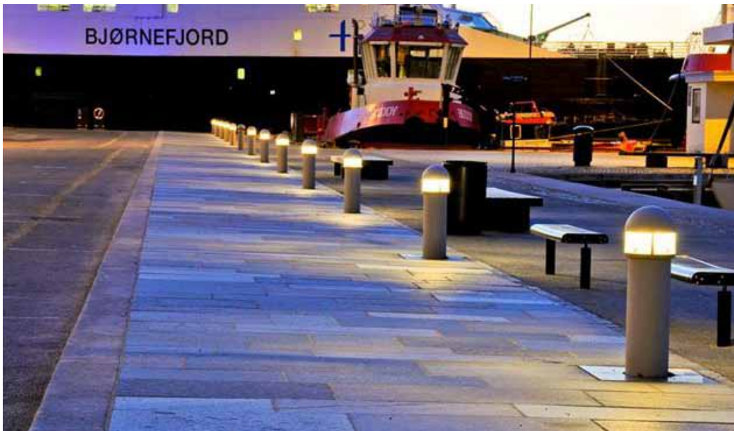
Tydlig avgrenset gangareal. Pullerter med lys er med på å synliggjøre gangsonen og øke synligheten av pullertene i skumring/mørke. Pullertene kunne med fordel vært plassert utenfor gangarealet, i en møbleringssone. Foto: Knut Opeide
