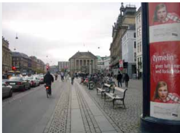
København. Slette stein til å gå på (og trille på) og hvilebenker gir gode forhold for fotgjengere. Denne bruken av slett stein gir også et ryddig gatebilde som tydelig viser hvor det er ment at en skal gå (og hvor en ikke skal plassere reklame), og gir samtidig en taktil og visuell støtte for synshemmede. Foto: Finn Aslaksen.
