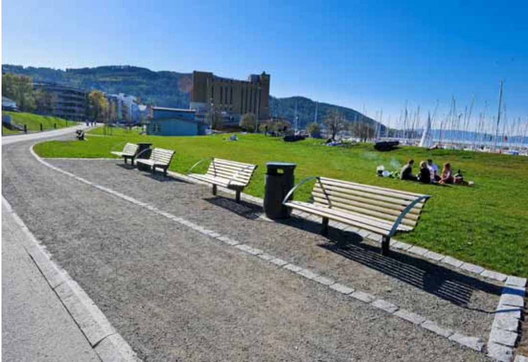
Turområde med universell utforming. Gangarealet har jevnt og slett underlag med tydelig avgrensning mot sidearealet. Det er etablert en naturlig ledelinje i overgangen gang- og sideareal. Benkene har armlener og ryggstøtte, og er plassert utenfor selve gangarealet. Foto: Knut Opeide.
