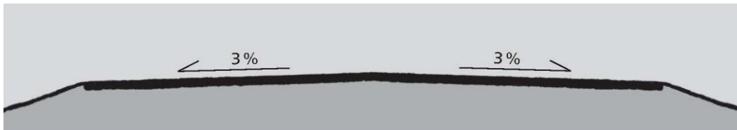
Figur 4.1: Tverrprofil, takfall på rettlinje
