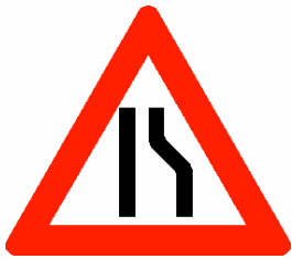
106.2 (Innsnevring på høyre side)
