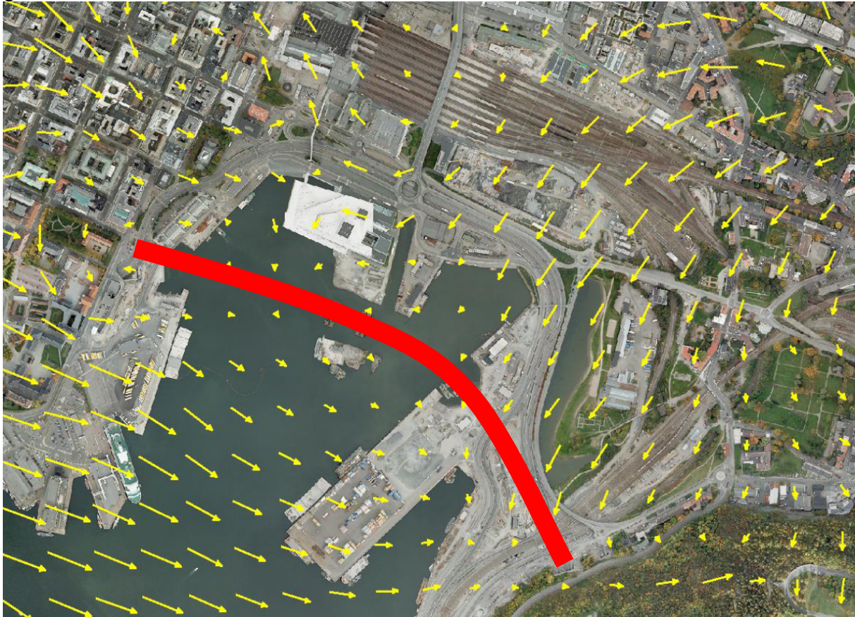
Figuren viser et eksempel på deformasjon etter transformasjon av prosjekterte data med formel fra Statens Kartverk, største piler i eksemplet utgjør ca 8 cm. Størrelsen på deformasjonen vil være forskjellig, avhengig av kvaliteten på det gamle NGO kartet i det aktuelle området.
