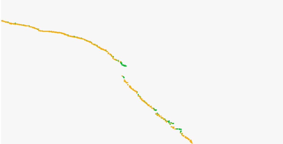
Bilde 1: Eksempel på klassifisering av overheng. Oransje er klassifisert som "bakke", grønt er klassifisert som "ikke bakke". Klassen "Overheng" vil hente punkter fra klassen "Ikke bakke" for å få med overheng. Dette er til dels automatisk, men i stor grad en manuell jobb.
