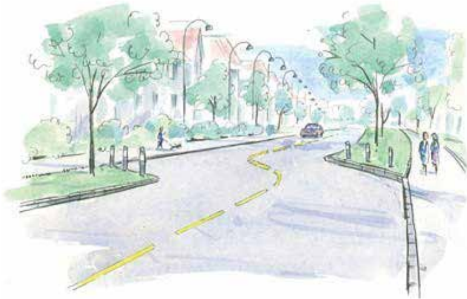
Figur 3.26 Sideforskyvning av tofeltsveg
