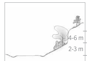
Ikke skjemmende ensidig fjellskjæring
