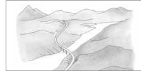
Brua krysser på det smaleste. Godt samspill mellom veg, bru og landskap. Sammenhengende romkurve og harmonisk linjeføring
