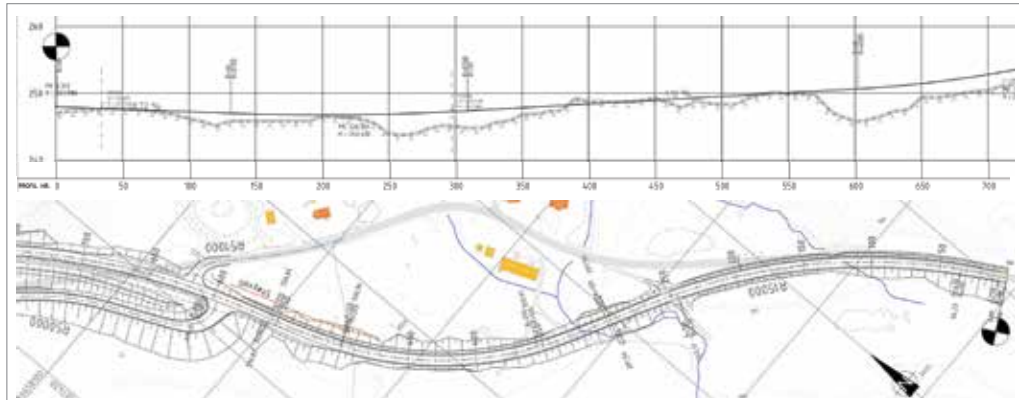
I dag tegnes veglinjens horisontalplan og vertikalprofil hver for seg
