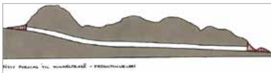
Forlengt tunnel uten lavbrekk mindre driftskostnad
