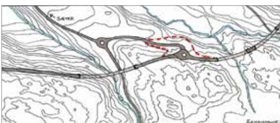
Avkjøringen går med terrenget
