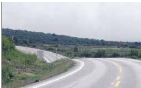
Knekk, sprang og dårlig kontinuitet i romkurven
