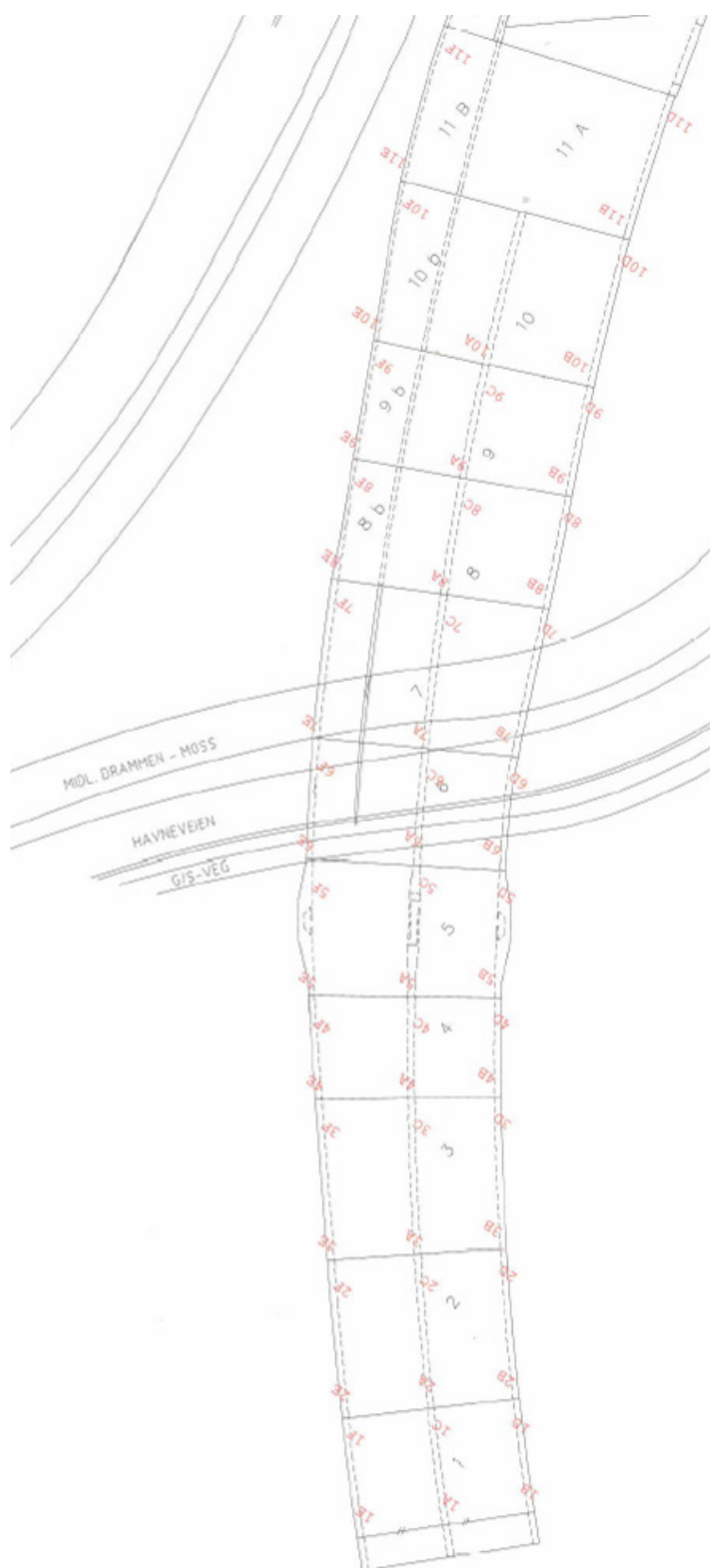
Fig 8.8 - Plassering av nivellemenspunkter på veggene nede i tunnelen.
