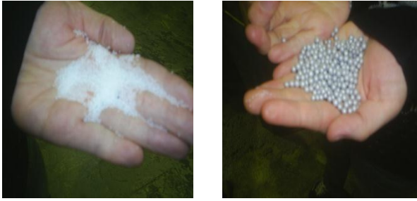
Figur 3.3: Perleformasjon før og etter forskumming. (Tjernsbekk, 2011).
