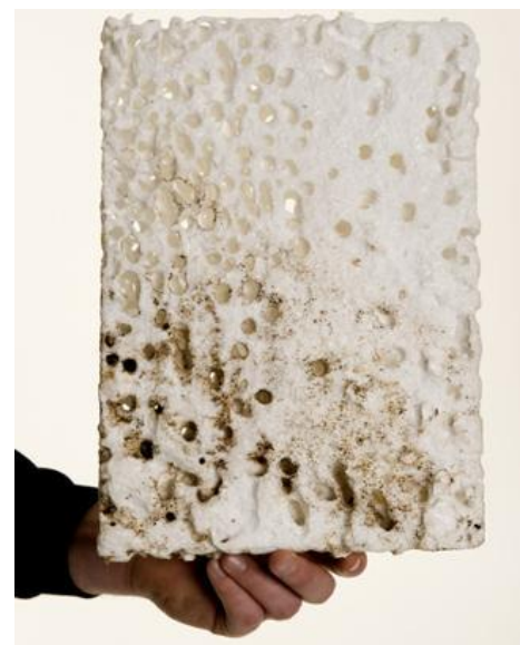
Figur 3.11: EPS angrepet av insekter (skadedyrkontroll.biz, 2011).
