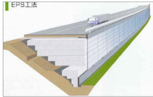
Figur 5.20: Prinsippskisse av ferdig EPS-fylling. (Slobodinski og Aunaas, 2010).
