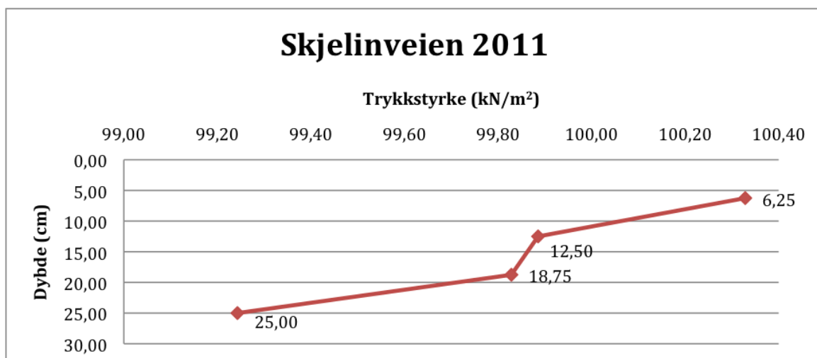
Figur 8.16: Trykkstyrke versus dybde i fyllingen.
