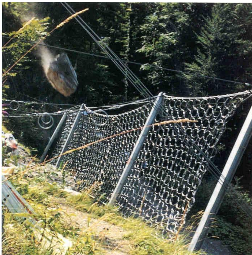
Figur 5.16 Fanggjerd - like før blokkanslag (Kilde: GeobruGG AG)
