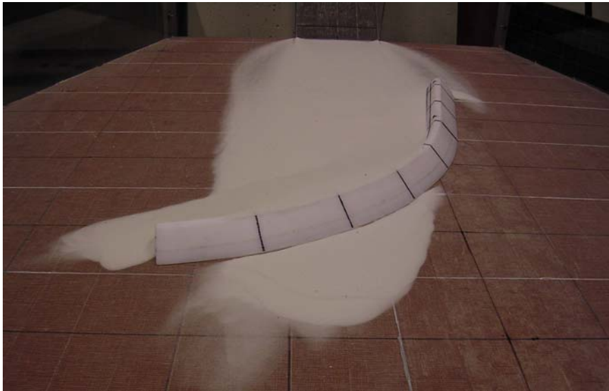
Figur 8.22. Modellforsøk med buet voll med helling 60^\circ . Den fremre bølgefronten har passert vollen, mens vollen har styrt de bakre massene tilfredsstillende.
