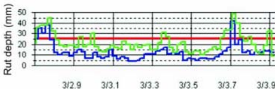
Figur 9. Spormålinger for indre og ytre kjørefelt, Fv 861 i Troms
