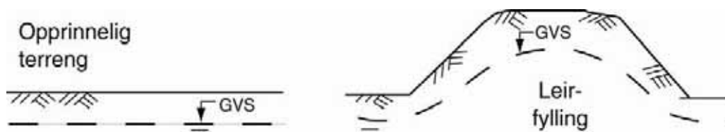
Figur 14.11 Oppfukning av leirfylling.
